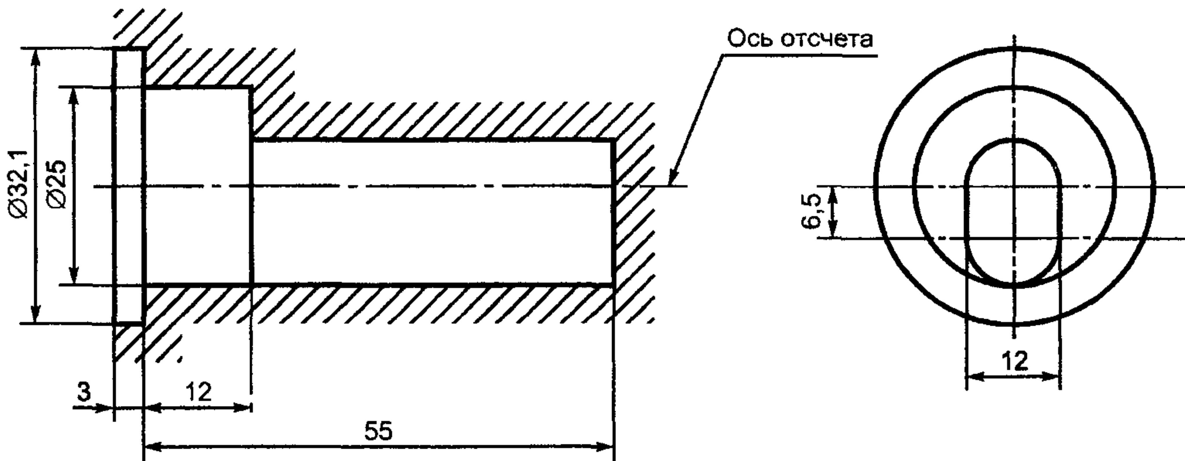
Рисунок 1.4 — Максимальный внешний контур лампы<sup>2)</sup>
