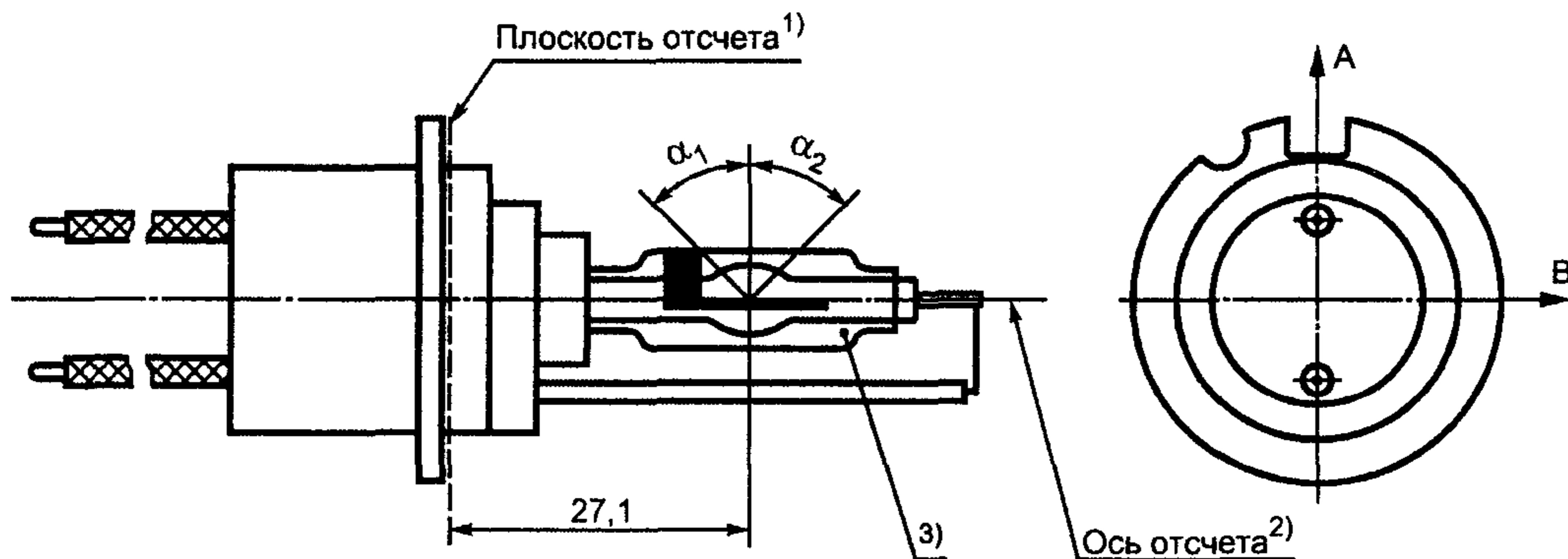
Рисунок 1.1 — Категория D1R. Типовой газоразрядный источник света с проводами (цоколь RK 32d-3)
