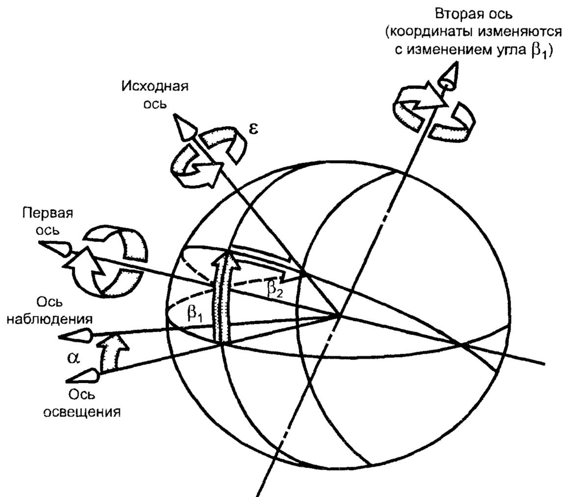
Система углов МКО для определения и измерения светоотражения. Первая ось перпендикулярна к плоскости, в которой проходят ось наблюдения и ось освещения. Вторая ось перпендикулярна как первой оси, так и исходной оси. Все оси, углы и направления вращения показаны положительными.
