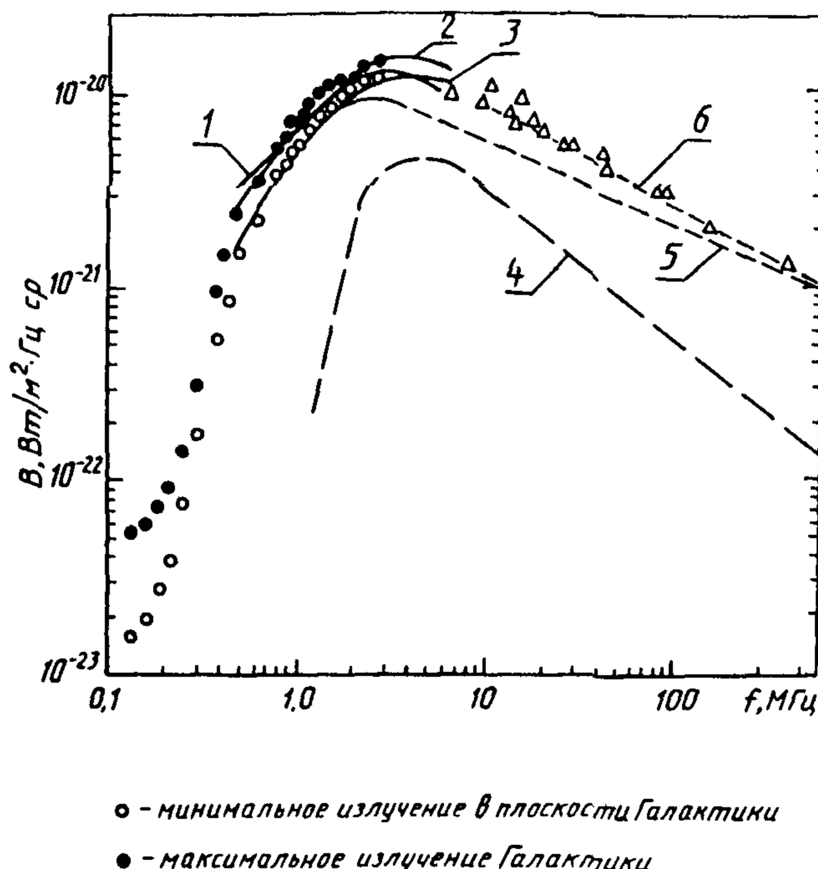
Рисунок 1 — Композиционный спектр фонового излучения. Зависимость энергетической спектральной яркости от частоты по данным наземных и спутниковых измерений
