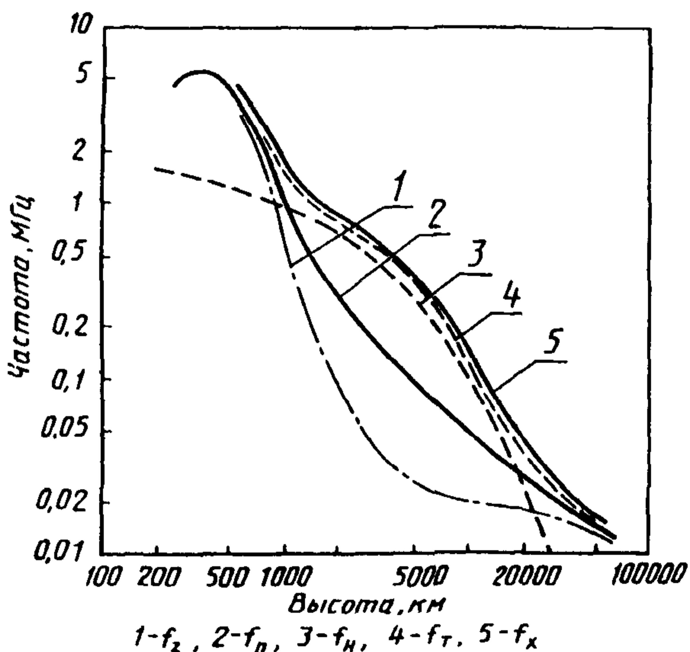
Рисунок 5 — Стандартная зависимость от высоты в полярной магнитосфере гирочастоты электронов  $f_H$ , плазменной частоты  $f_n$ , критической частоты Z-волны  $f_Z$ , частоты верхнего гибридного резонанса  $f_T$ , критической частоты необыкновенной волны  $f_x$
