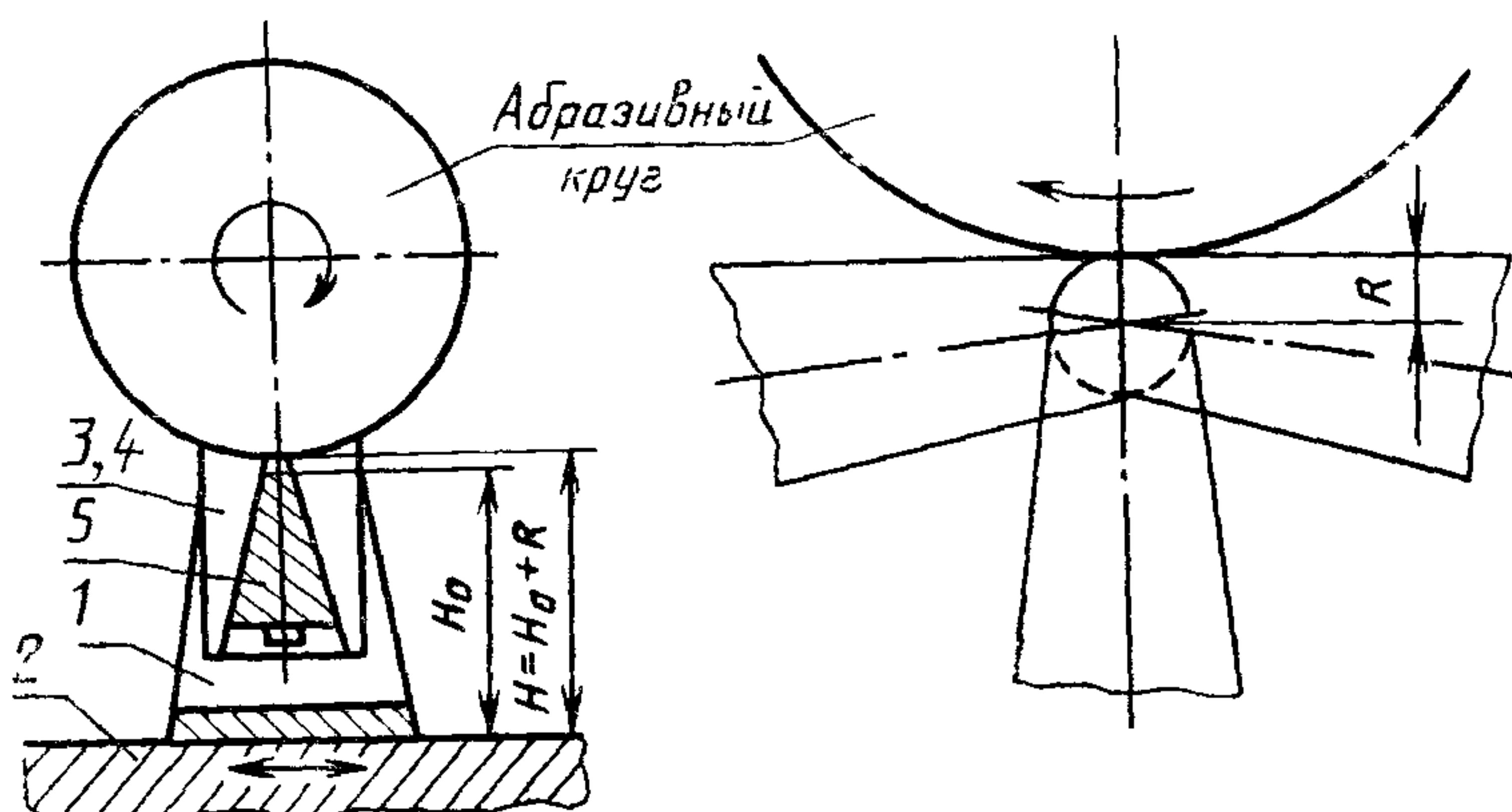
1 — опора, 2 — стол шлифовального станка, 3, 4 — полуоси, 5 — образец
