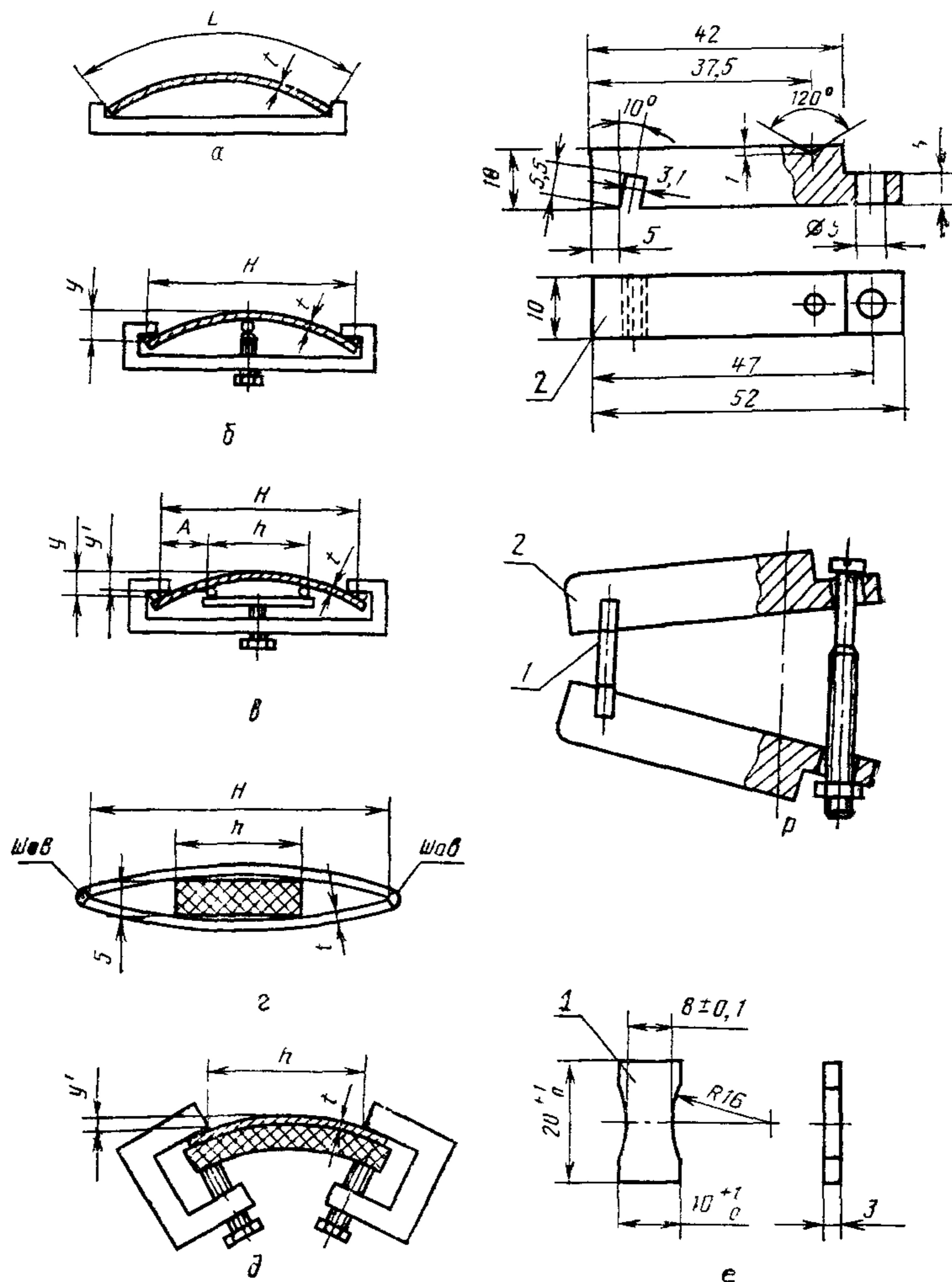
**а** — образец, нагруженный в двух точках **б** — образец, нагруженный в трех точках, **в** — образец, нагруженный в четырех точках, **г** — образец в виде ломкого бруса, **д** — образец на сплошной опоре, **е** — образец, нагруженный с помощью рычага, 1 — образец, 2 — рычаг
