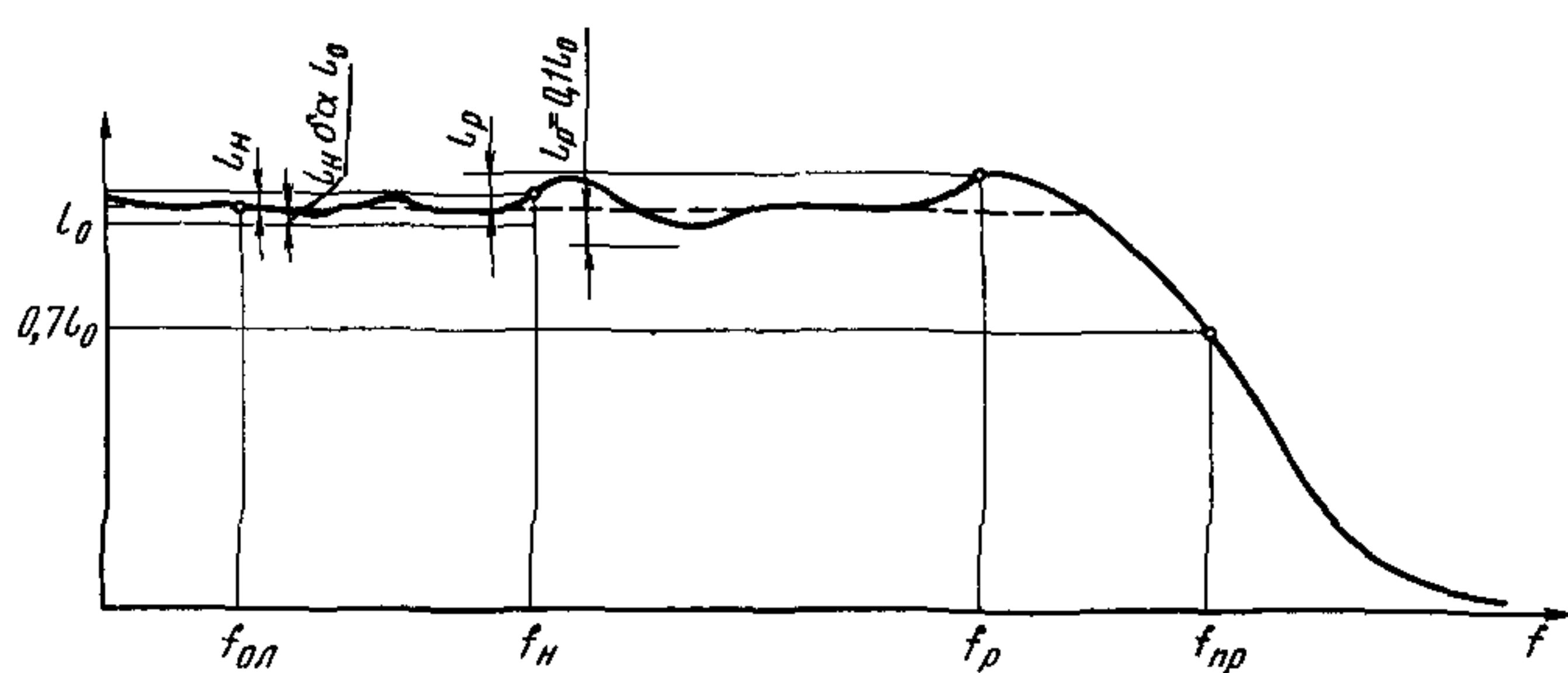
$f_{оп}$  — опорная частота;  $f_n$  — нормальный диапазон;  $f_p$  — расширенный диапазон;  $f_{np}$  — верхняя граница полосы пропускания;  $l_0$  — значение АЧХ на опорной частоте;  $l_n$  — абсолютное значение неравномерности в нормальном диапазоне;  $l_p$  — абсолютное значение неравномерности в расширенном диапазоне.  $\delta_\alpha$  — относительная погрешность коэффициента отклонения
