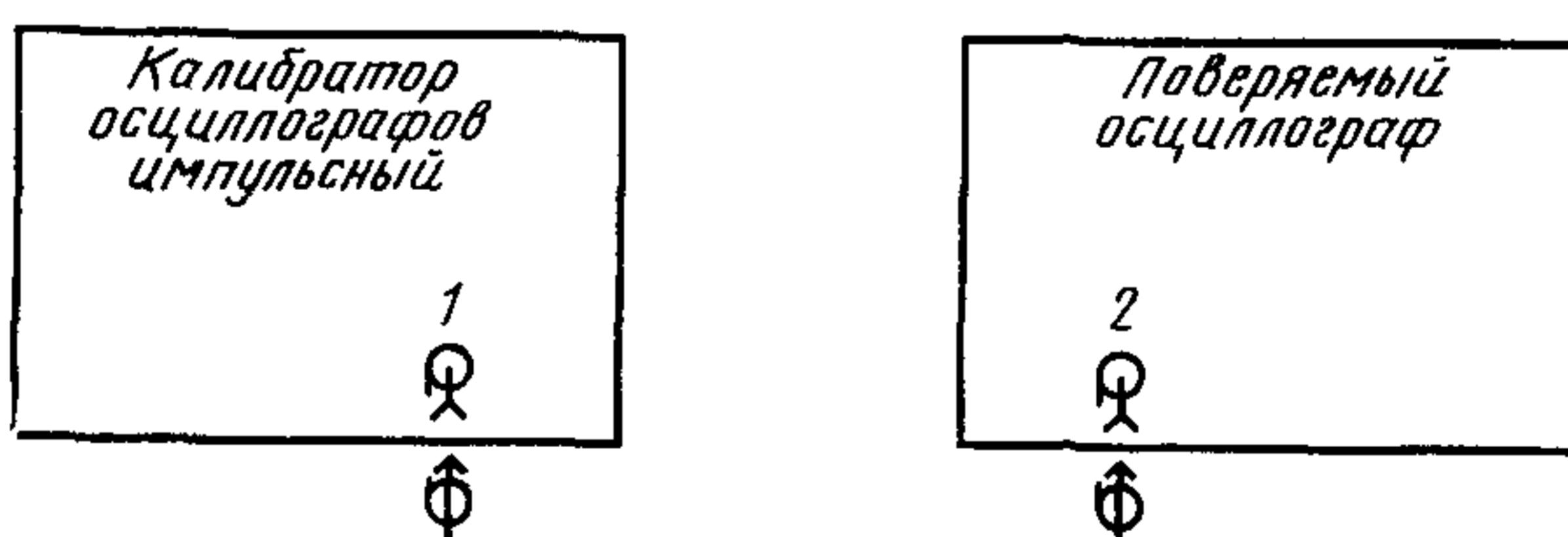
1—выход калибратора напряжения; 2—вход усилителя У.
