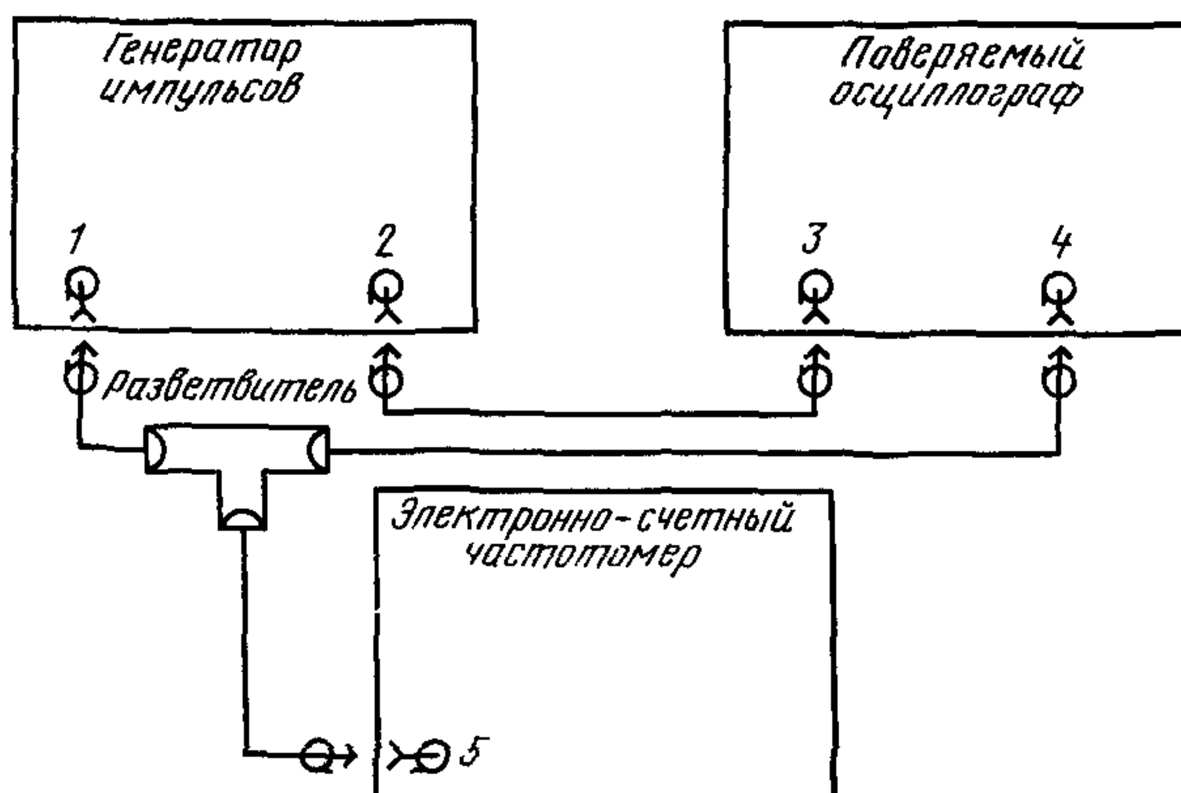
1—выход основных импульсов; 2—выход синхронизирующих импульсов; 3—вход синхронизации; 4—вход усилителя  $U$ ;
