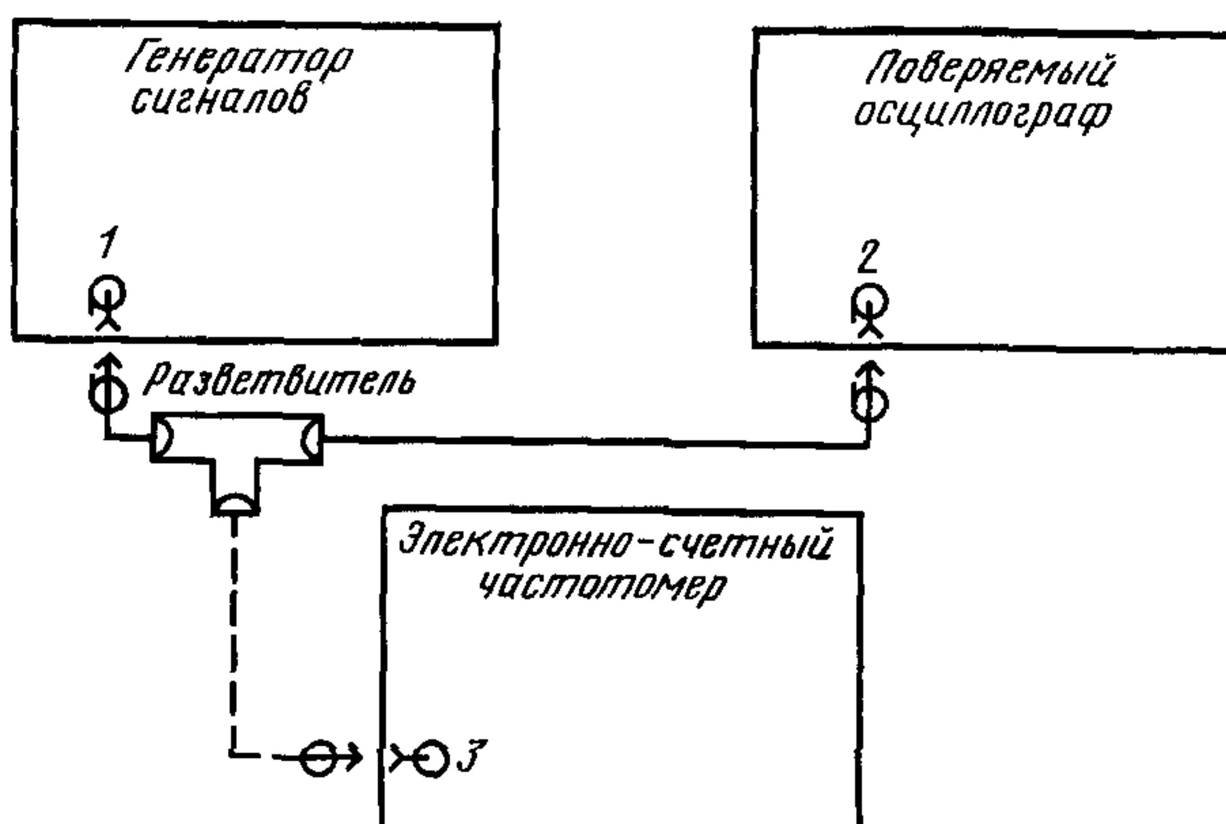
1—выход генератора сигналов; 2—вход усилителя  $U$ ; 3—вход частотометра
