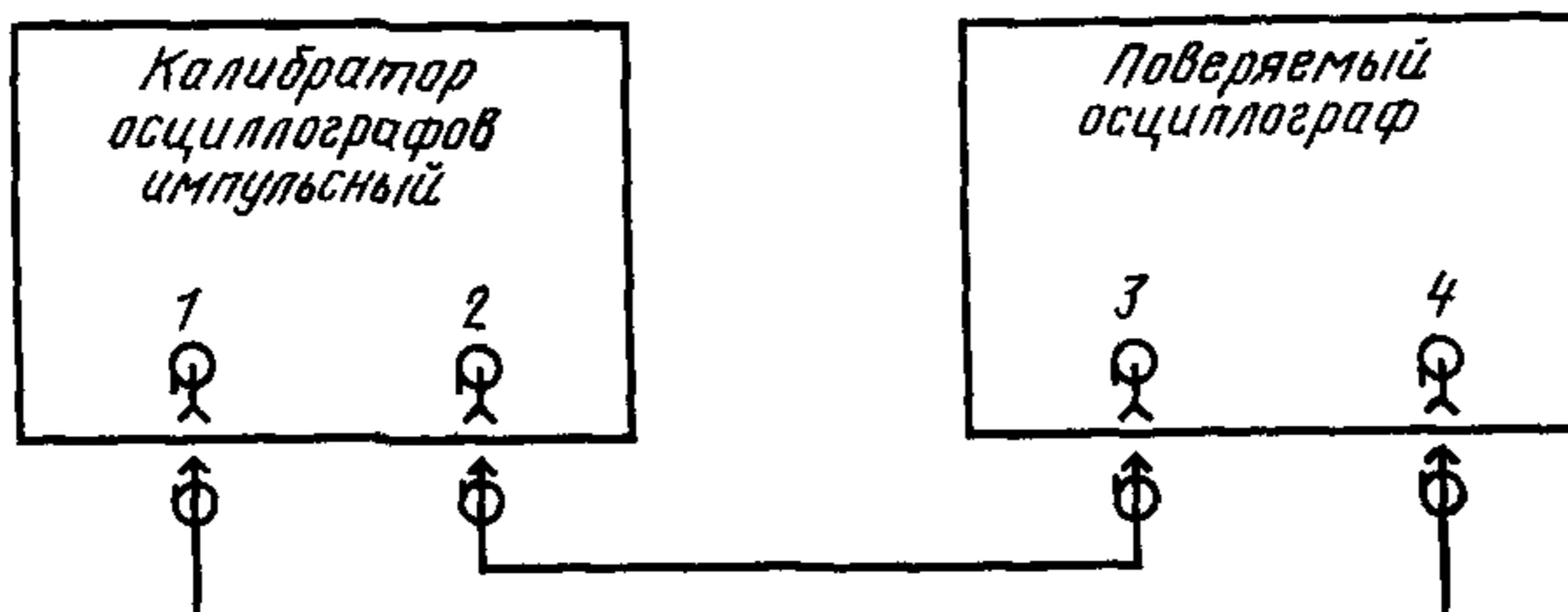
1—выход калибратора временных интервалов; 2—выход синхронизирующих импульсов; 3—вход синхронизации; 4—вход усилителя  $U$
