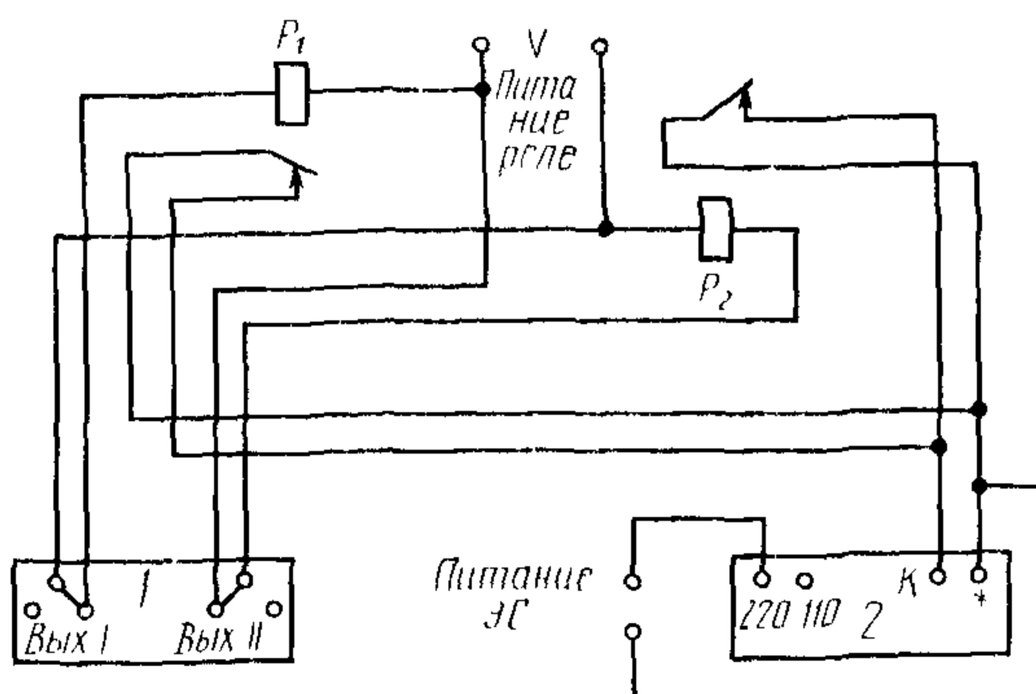
1—датчик интервалов времени; 2—проверяемый ЭС;
