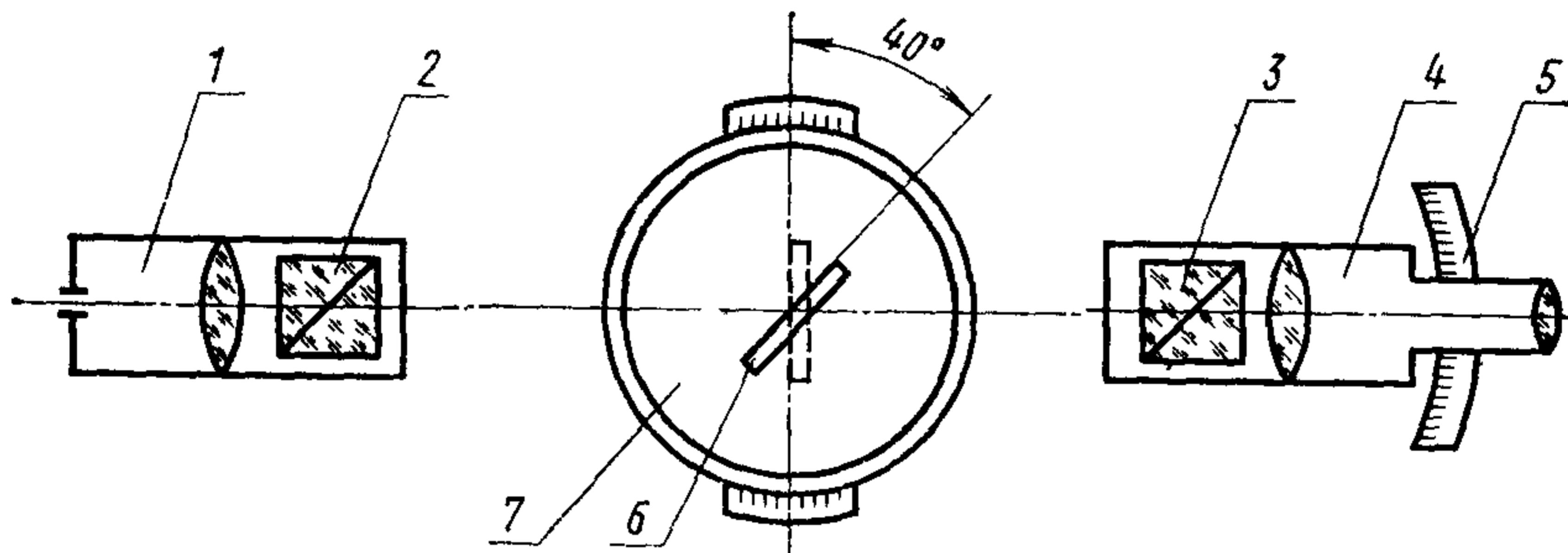
1 — коллиматор со щелевой диафрагмой; 2 — поляризатор, 3 — анализатор; 4 — зрительная труба; 5 — отсчетное устройство зрительной трубы; 6 — кварцевая пластина; 7 — лимб
