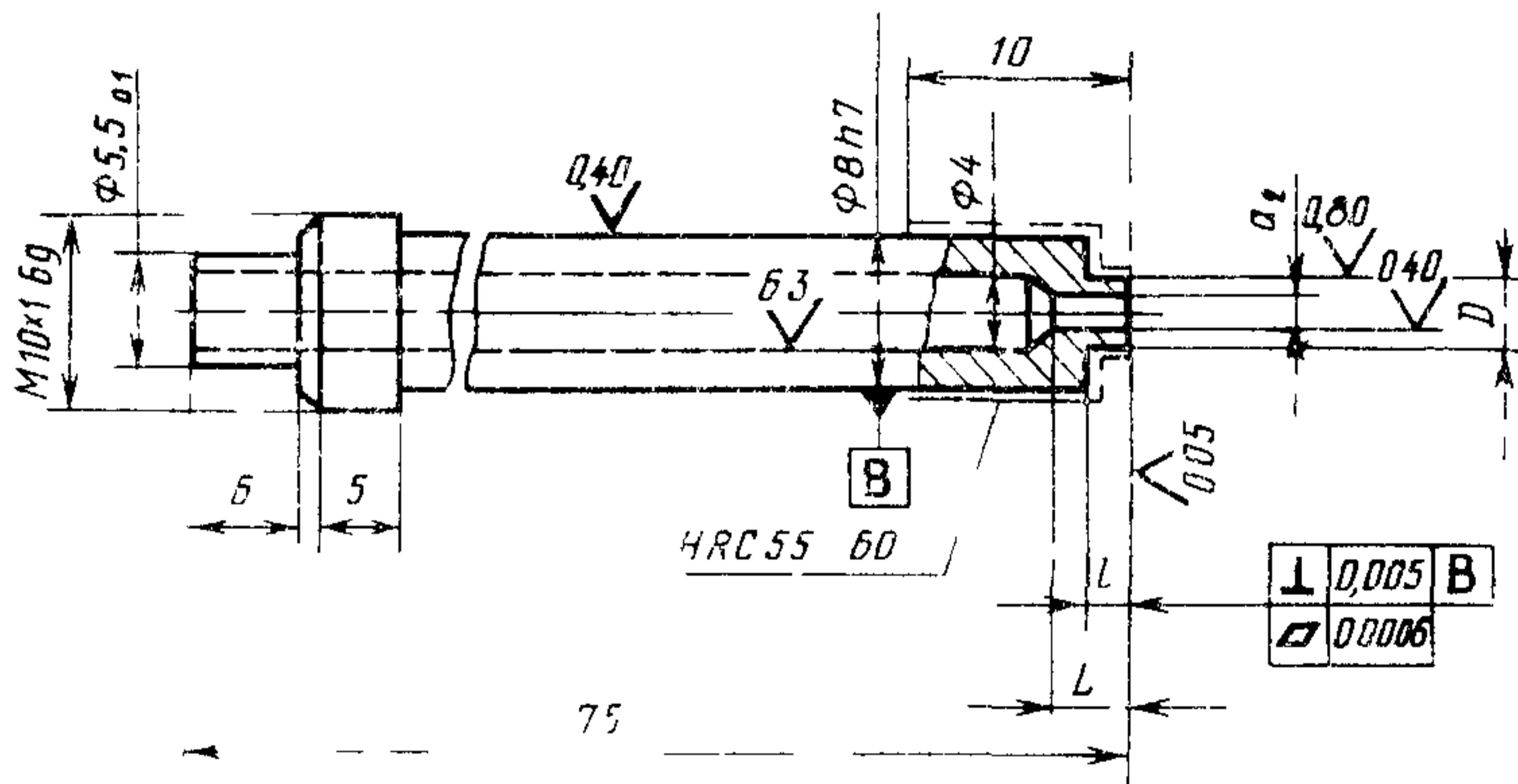
Контрольные измерительные сопла используют для поверки длинометров, выпускаемых без измерительной оснастки. Эти сопла могут быть использованы в качестве параллельного сопла, а также для замены пробки соплами
