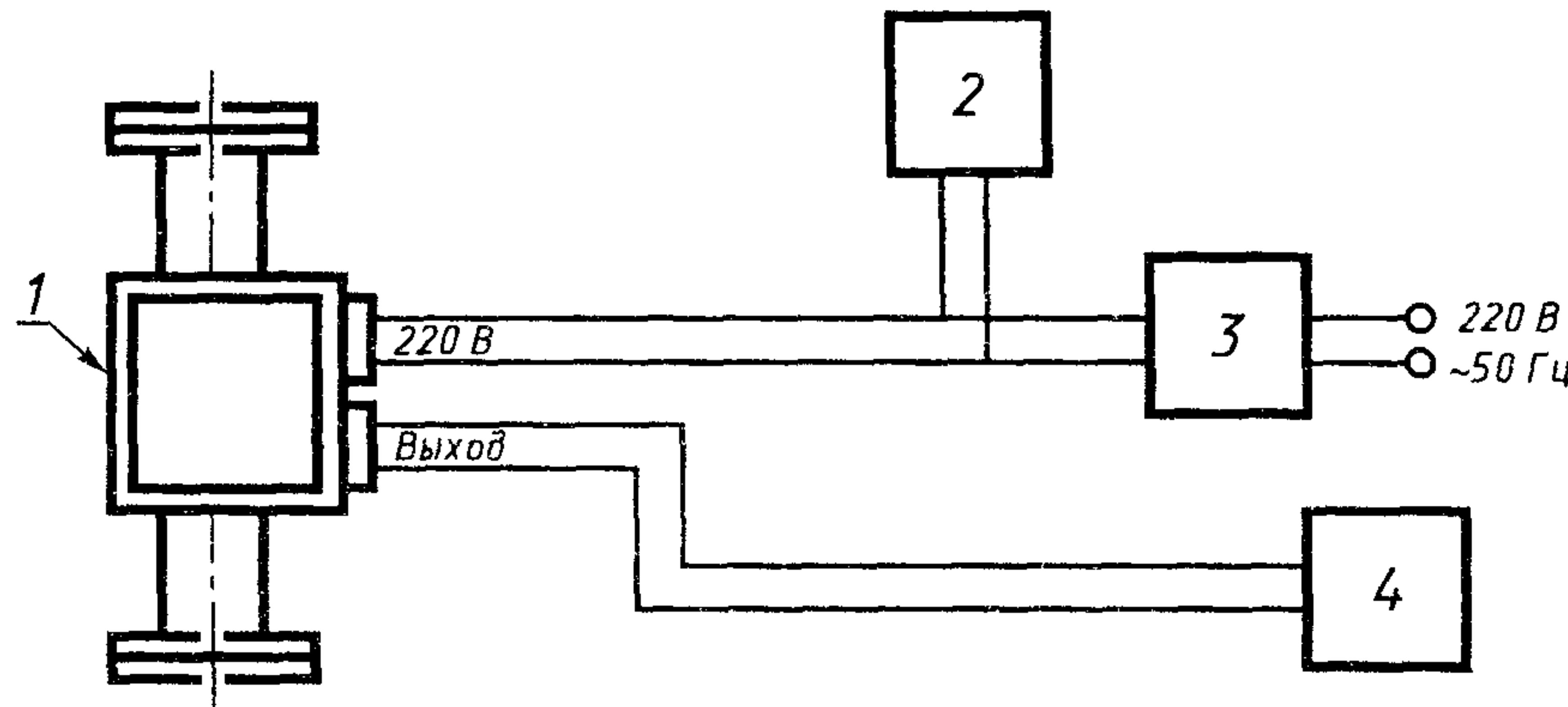
1 — ротаметр, 2 — вольтметр; 3 — автотрансформатор, 4 — милливольтмиллиамперметр
