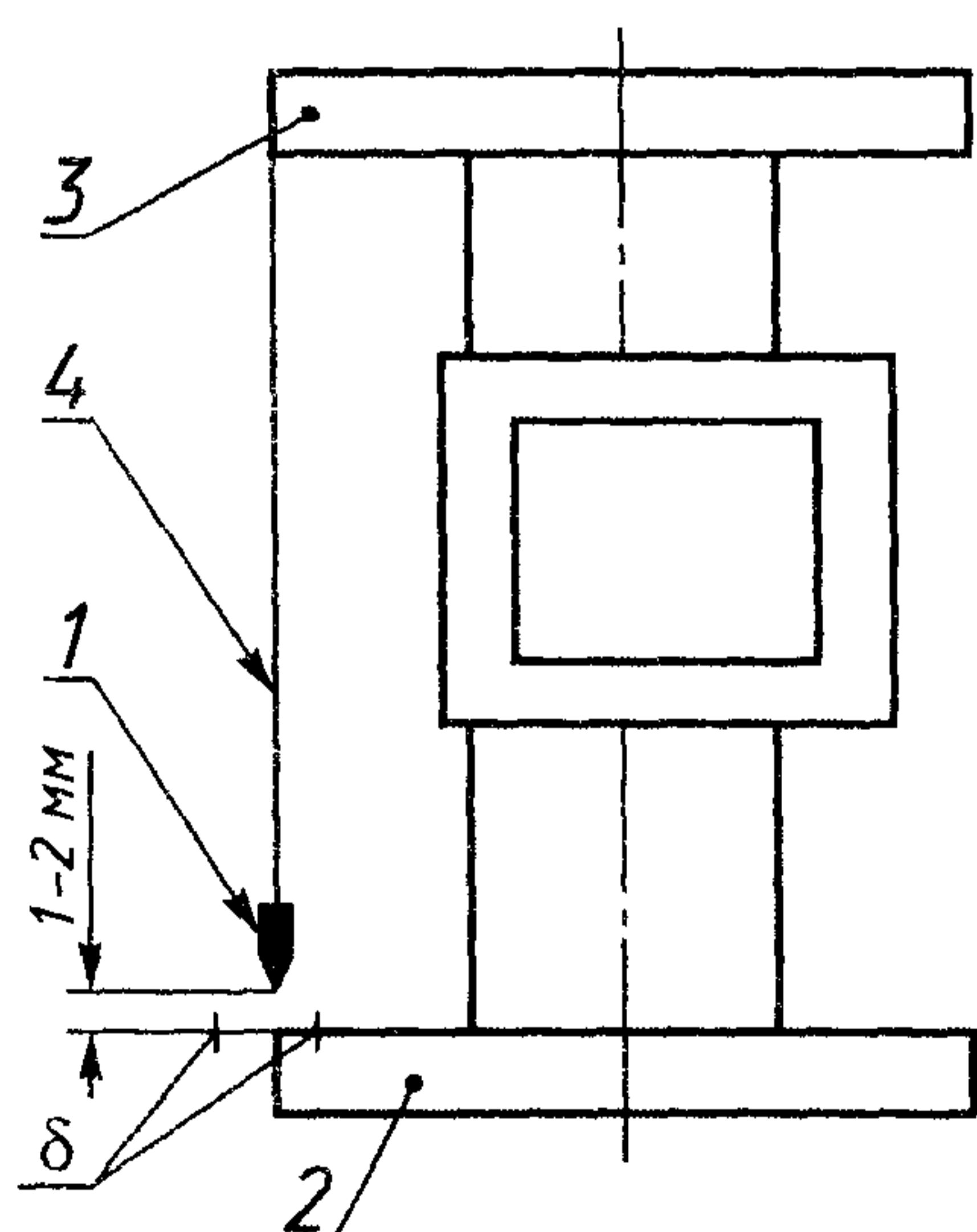
1 — отвес; 2 — нижний фланец; 3 — верхний фланец; 4 — нить;
