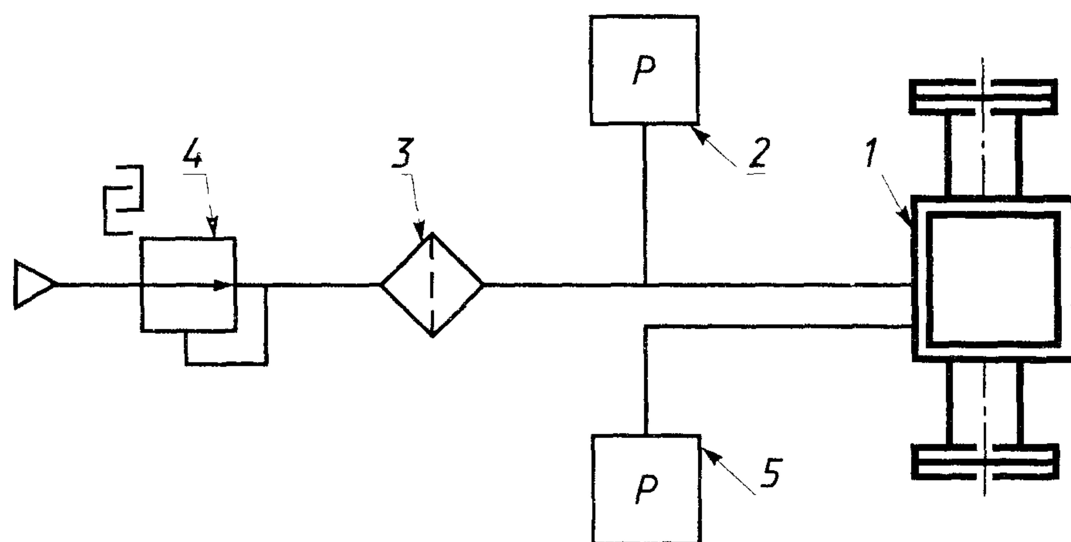
1 — ротаметр, 2 — манометр показывающий; 3 — фильтр воздуха, 4 — стабилизатор давления воздуха,
