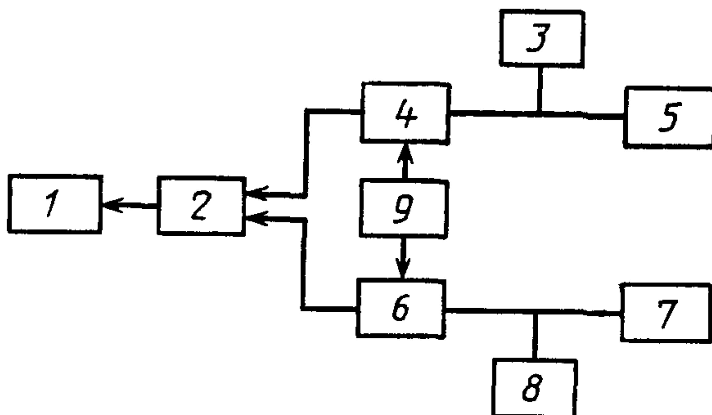
1—испытуемый индикатор; 2—коммутирующее устройство;
