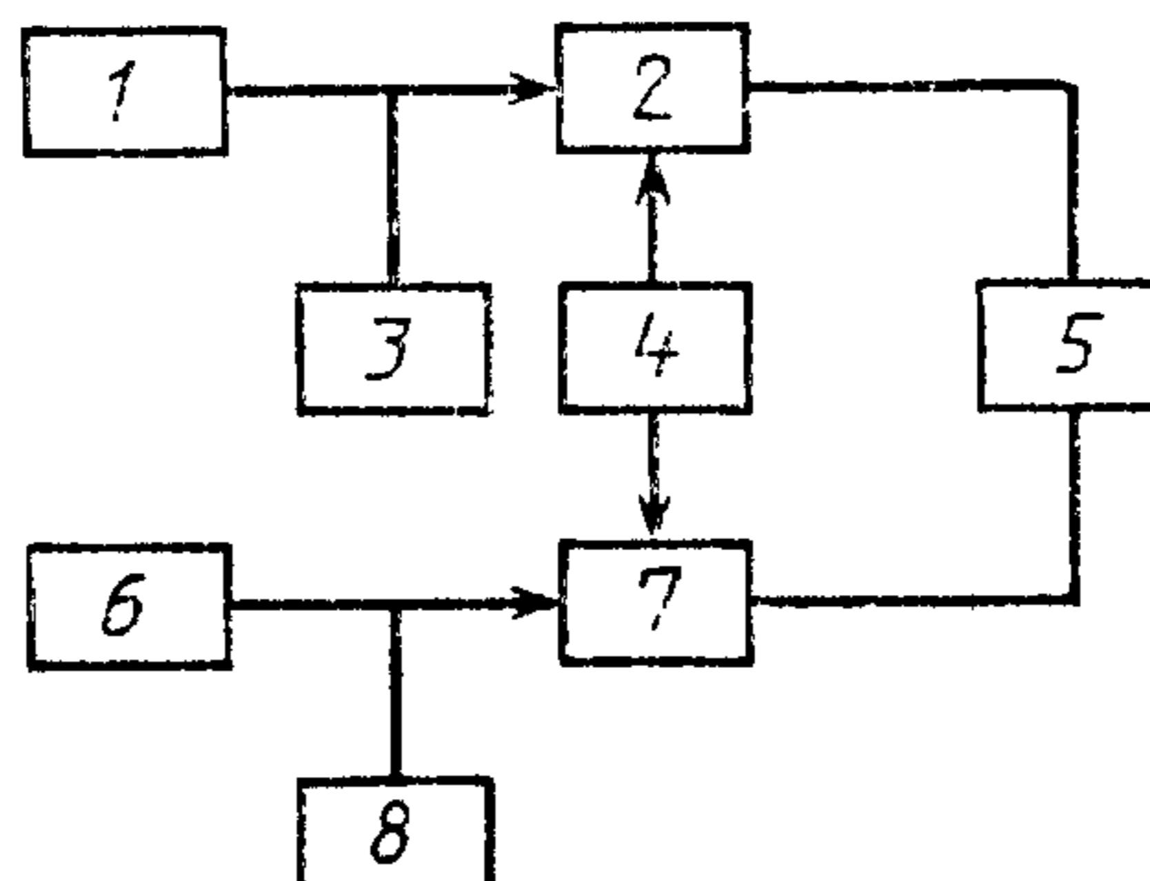
1—источник питания генератора импульсов напряжения катодов; 2—генератор импульсов напряжения катодов; 3, 8—вольтметры постоянного тока; 4—устройство управления и синхронизации; 5—испытуемый индикатор постоянного тока; 6—источник питания генератора импульсов напряжения анодов; 7—генератор импульсов напряжения анодов
