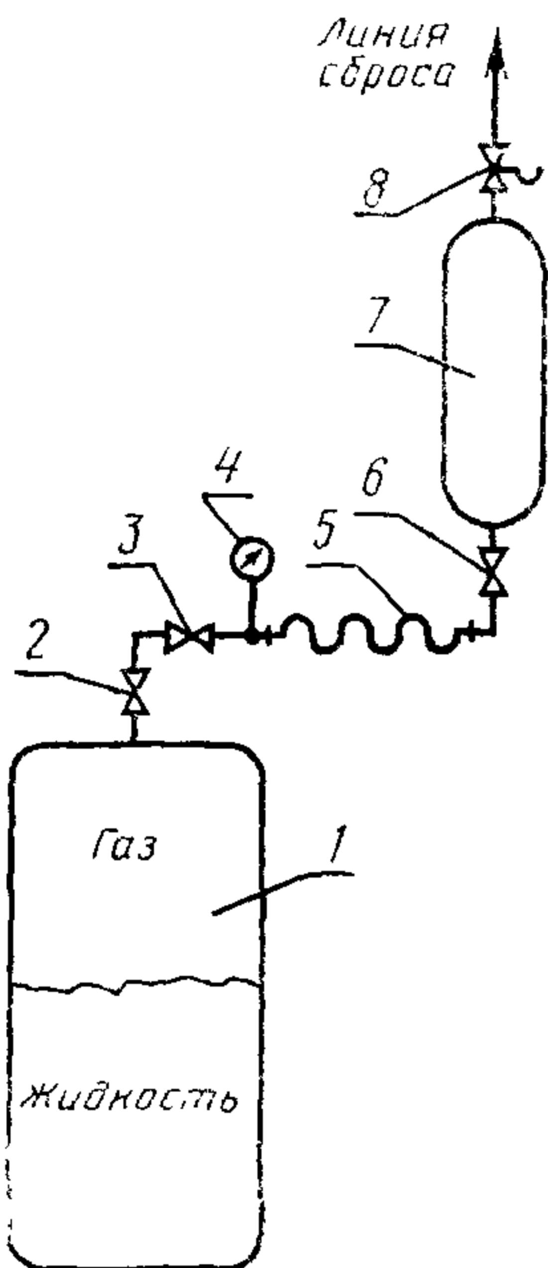
1—резервуар с продуктом; 2 и 3—вентили; 4—манометр; 5—соединительная трубка; 6—впускной вентиль; 7—пробоотборник; 8—выпускной вентиль с предохранительным клапаном
