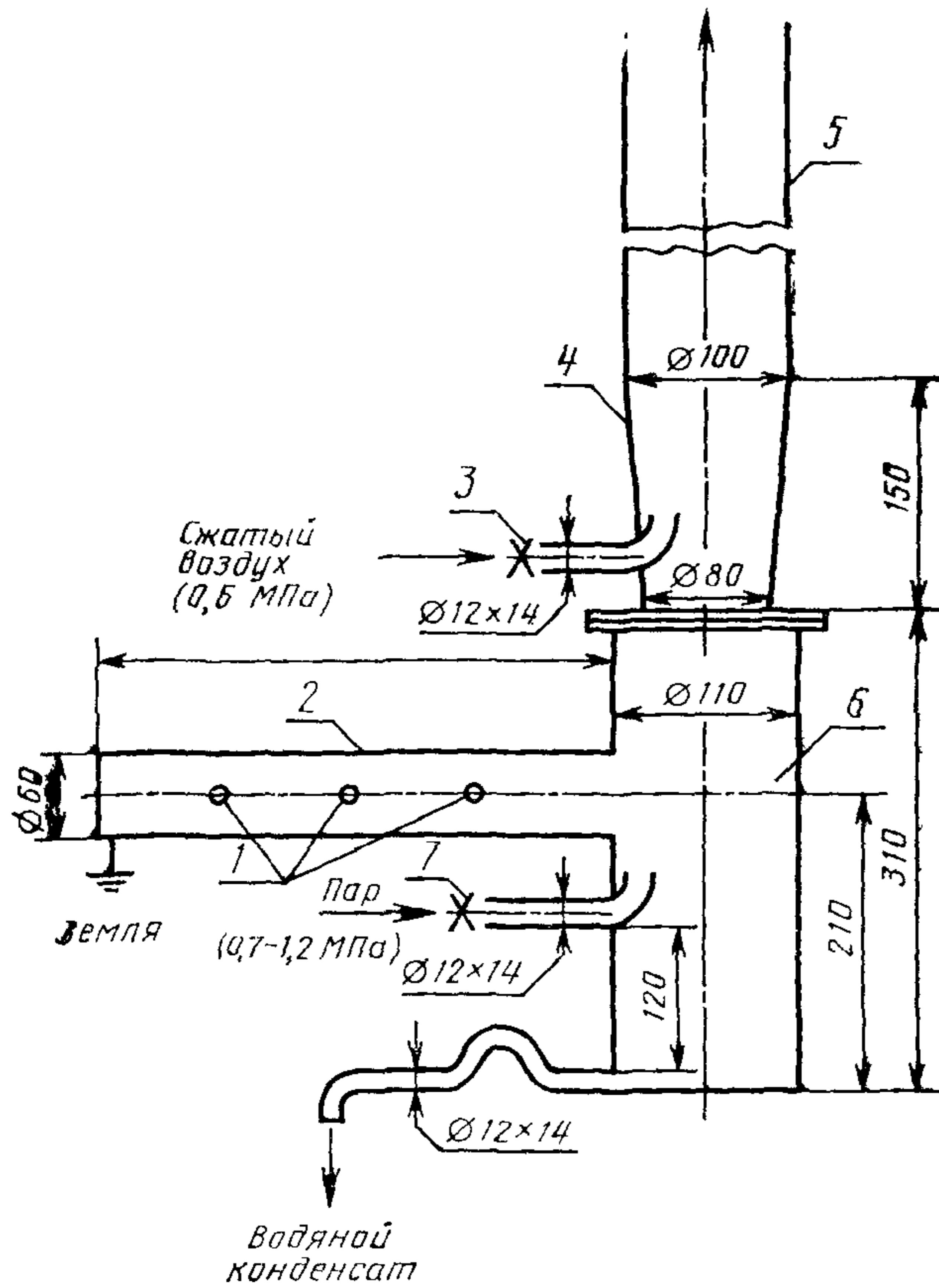
1—точки присоединения выхода пробоотборников с помощью гибкой трубы; 2—прямая трубка с теплоизоляцией, 3 и 7—вентили; 4—эжектор (сброс в воздух); 5—труба с теплоизоляцией не менее 6 м; 6—емкость с теплоизоляцией
