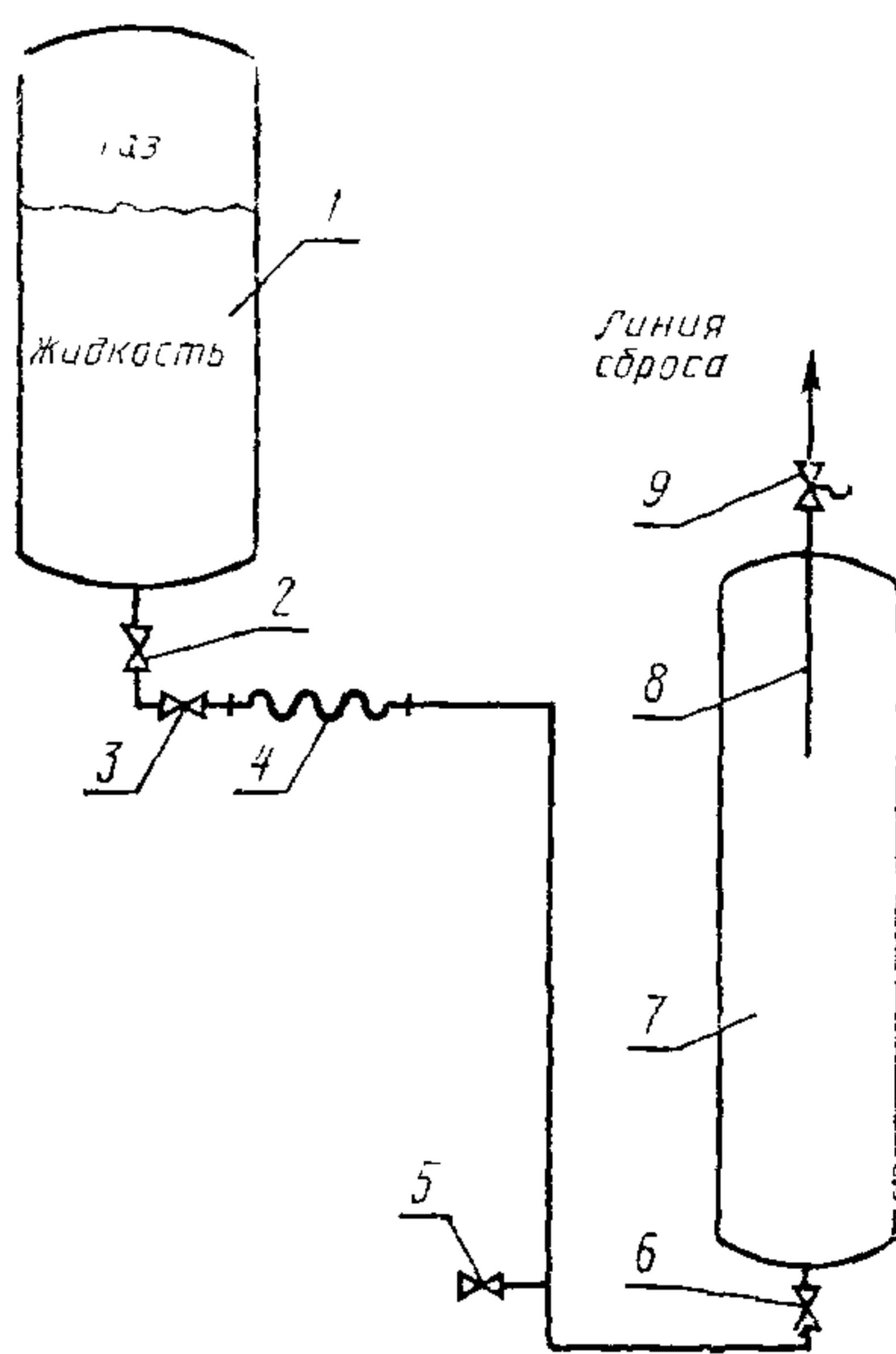
1—резервуар с продуктом; 2 и 3—вентили; 4—соединительная трубка; 5—вентиль для сброса давления; 6—впускной вентиль; 7—пробоотборник; 8—погружная трубка; 9—выпускной вентиль с предохранительным клапаном
