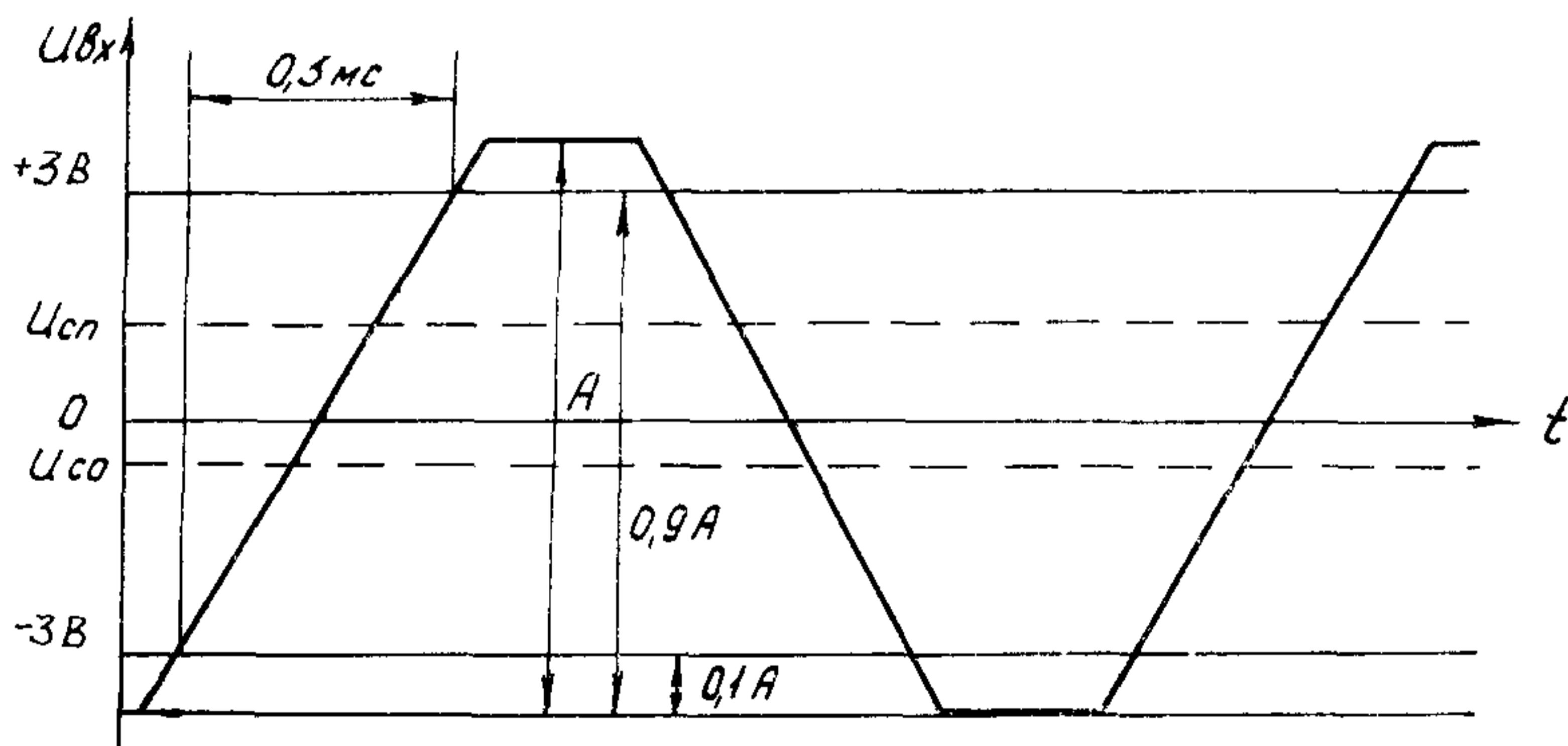
$U_{\text{вх}}$  — напряжение сигнала на входе ТГА, АПД;  $U_{\text{c.p}}, U_{\text{c.o}}$  — напряжение срабатывания вход-
