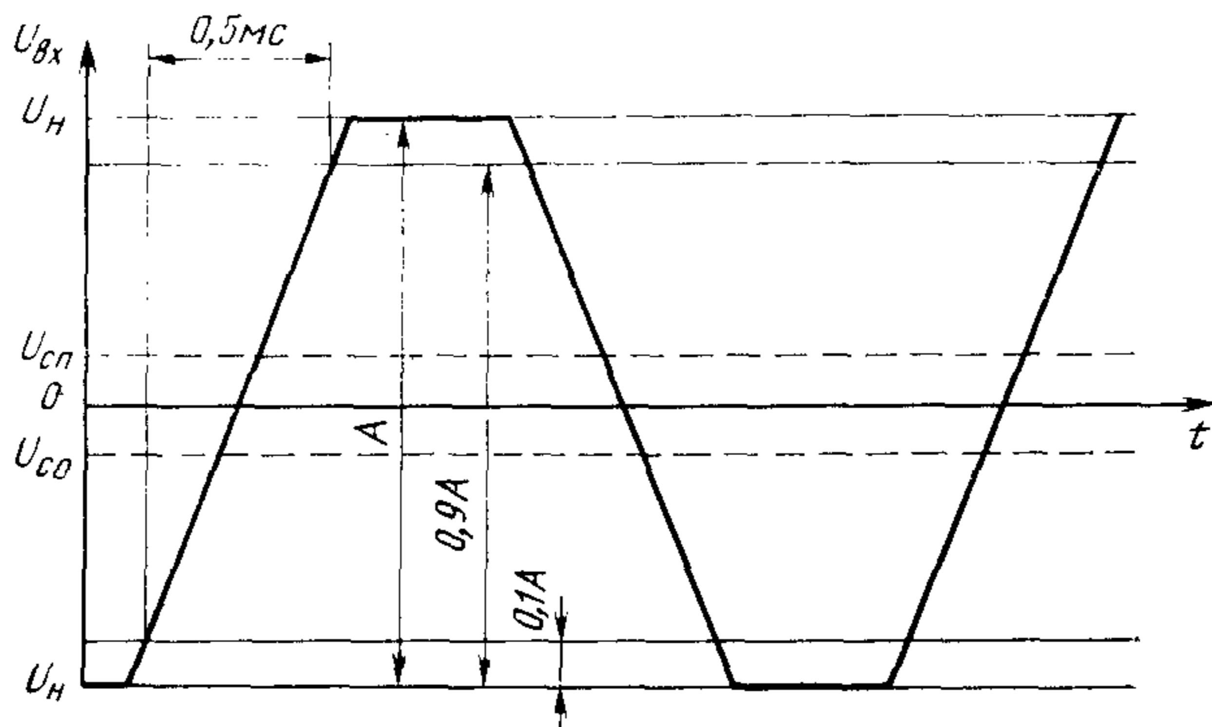
$U_{\text{вх}}$  — напряжение сигнала на входе ТГА, АПД;
