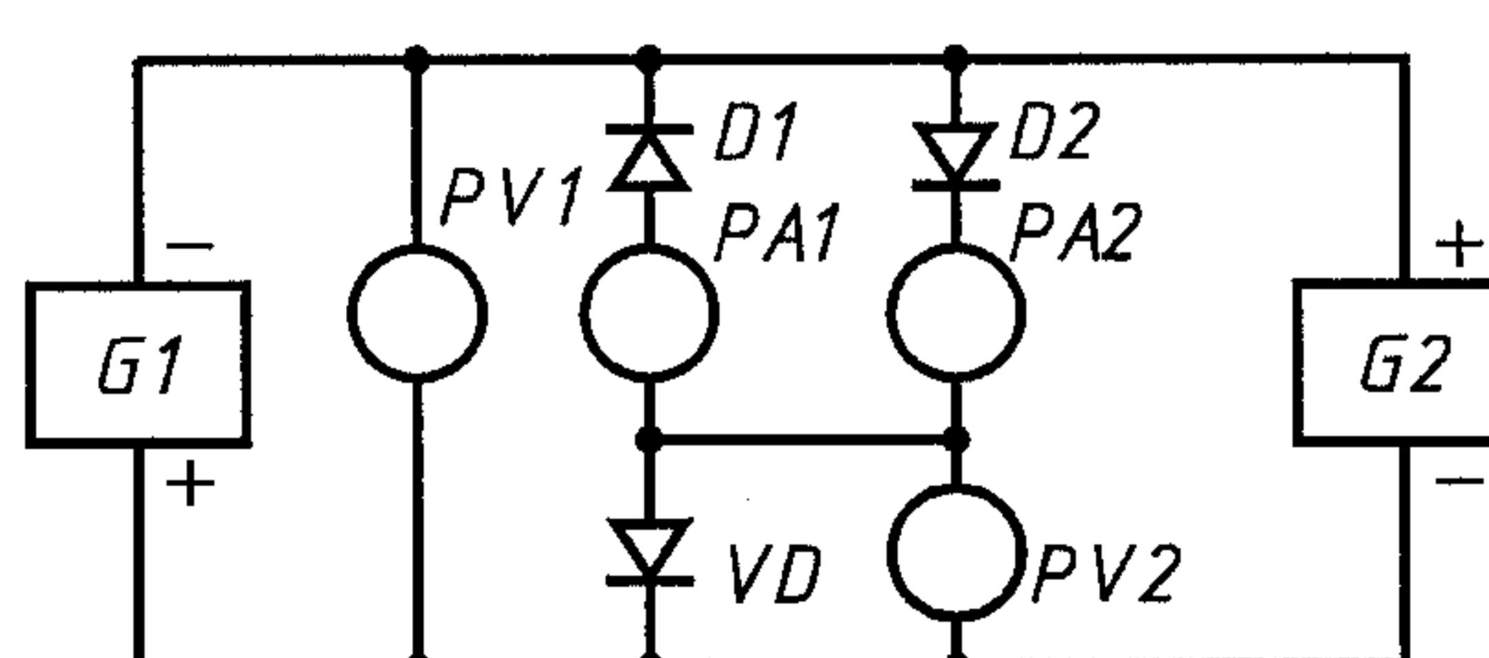
$G_1$ ,  $G_2$  — регулируемые источники обратного напряжения и прямого тока;  $PV_1$  — измеритель обратного напряжения, подводимого к диоду;  $PA_1$ ,  $PA_2$  — измерители среднего обратного и прямого тока;  $D_1$ ,  $D_2$  — диоды для разделения прямого и обратного тока через измеряемый диод;  $PV_2$  — измеритель среднего прямого напряжения;  $VD$  — измеряемый диод
