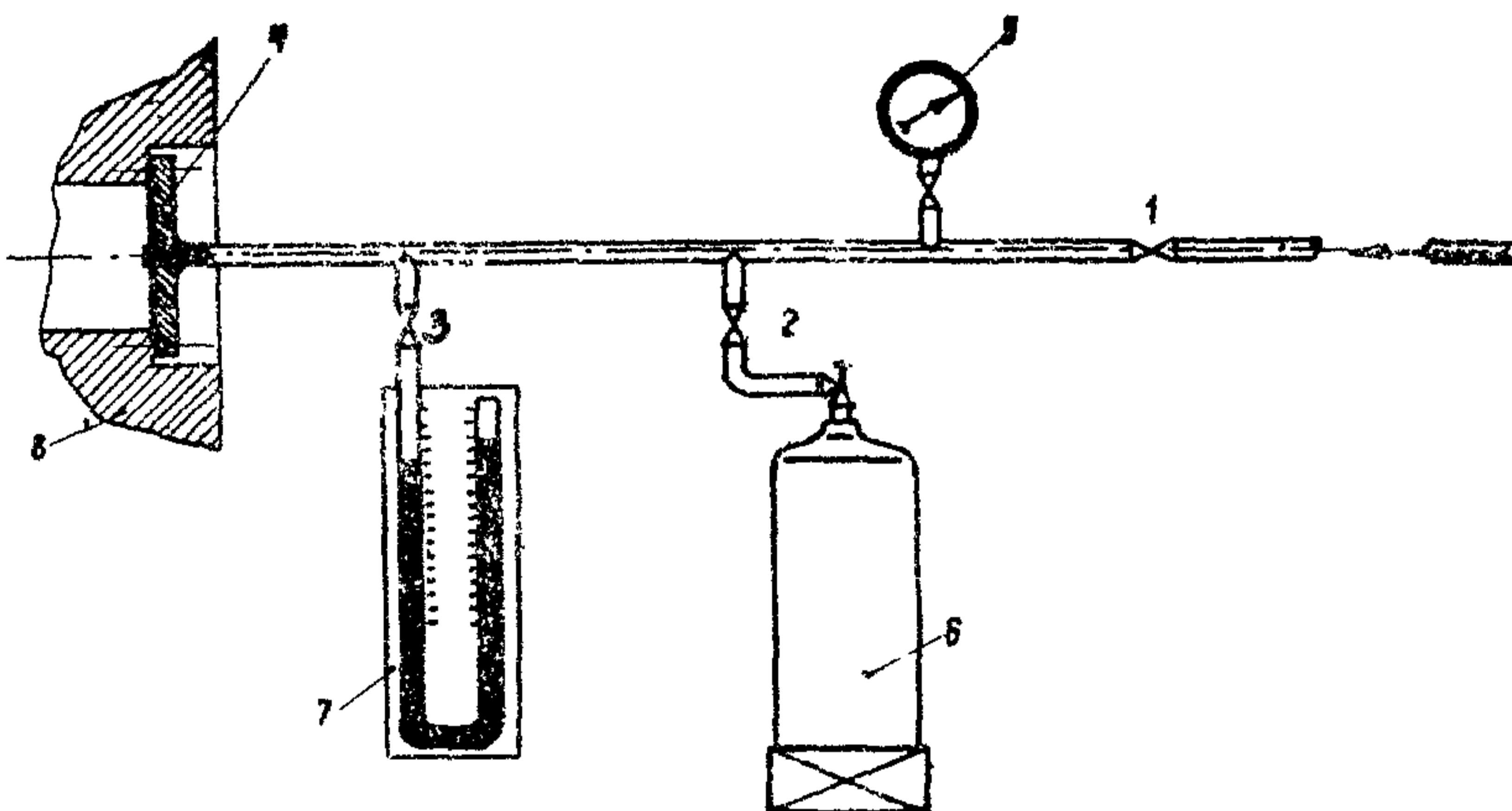
Рис.4. Схема заполнения статора фреоном
