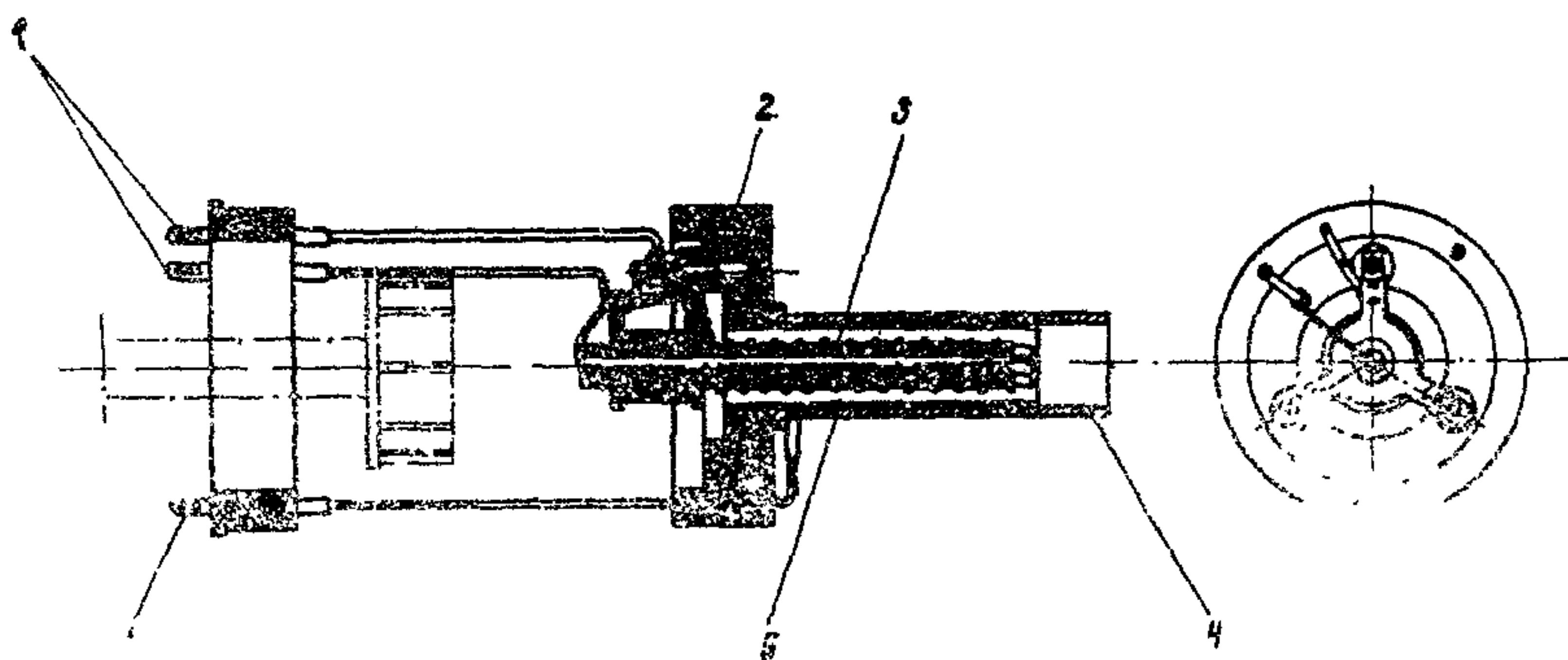
Рис.2. Устройство датчика течеискателя
