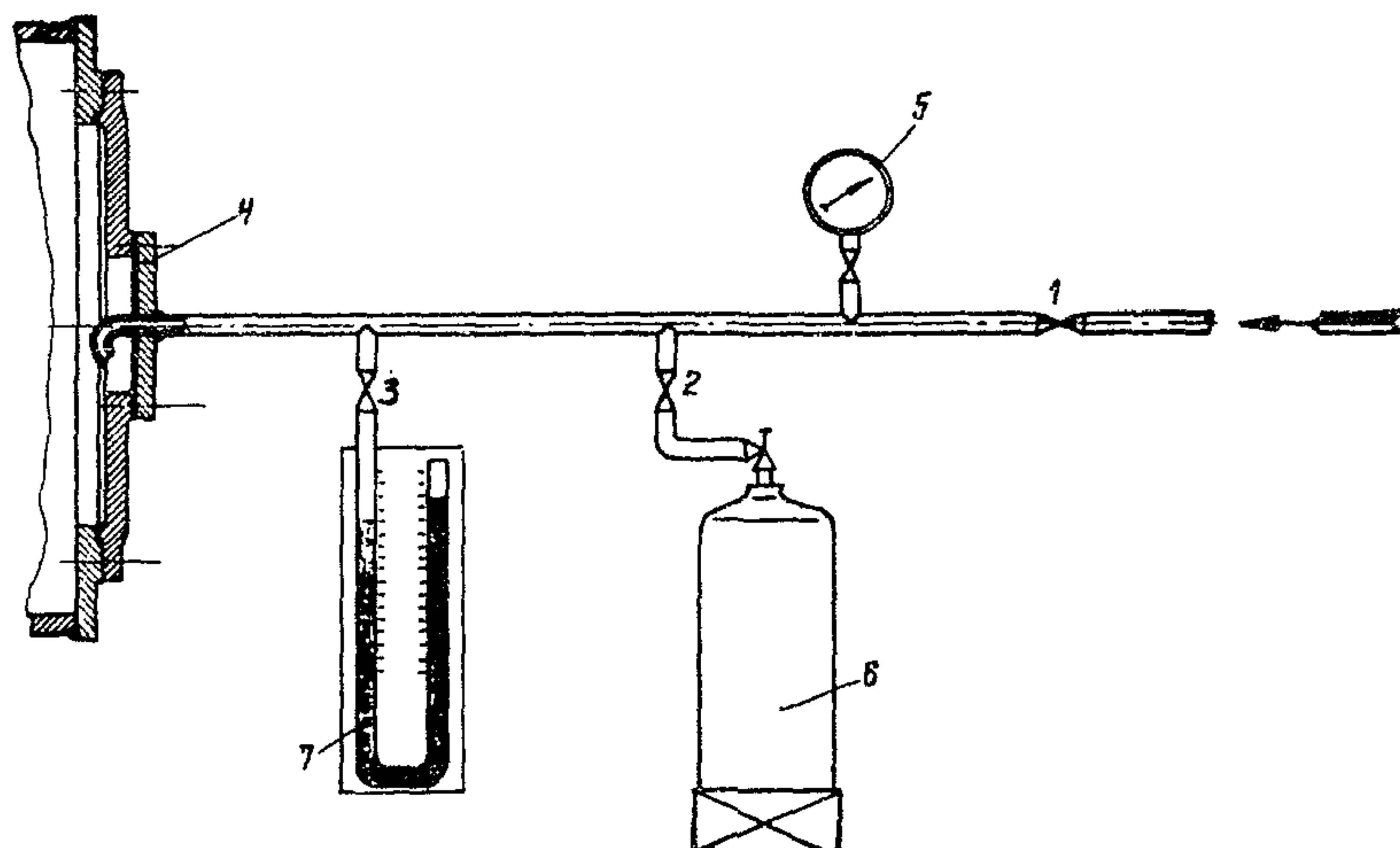
Рис.5. Схема заполнения ротора фреоном
