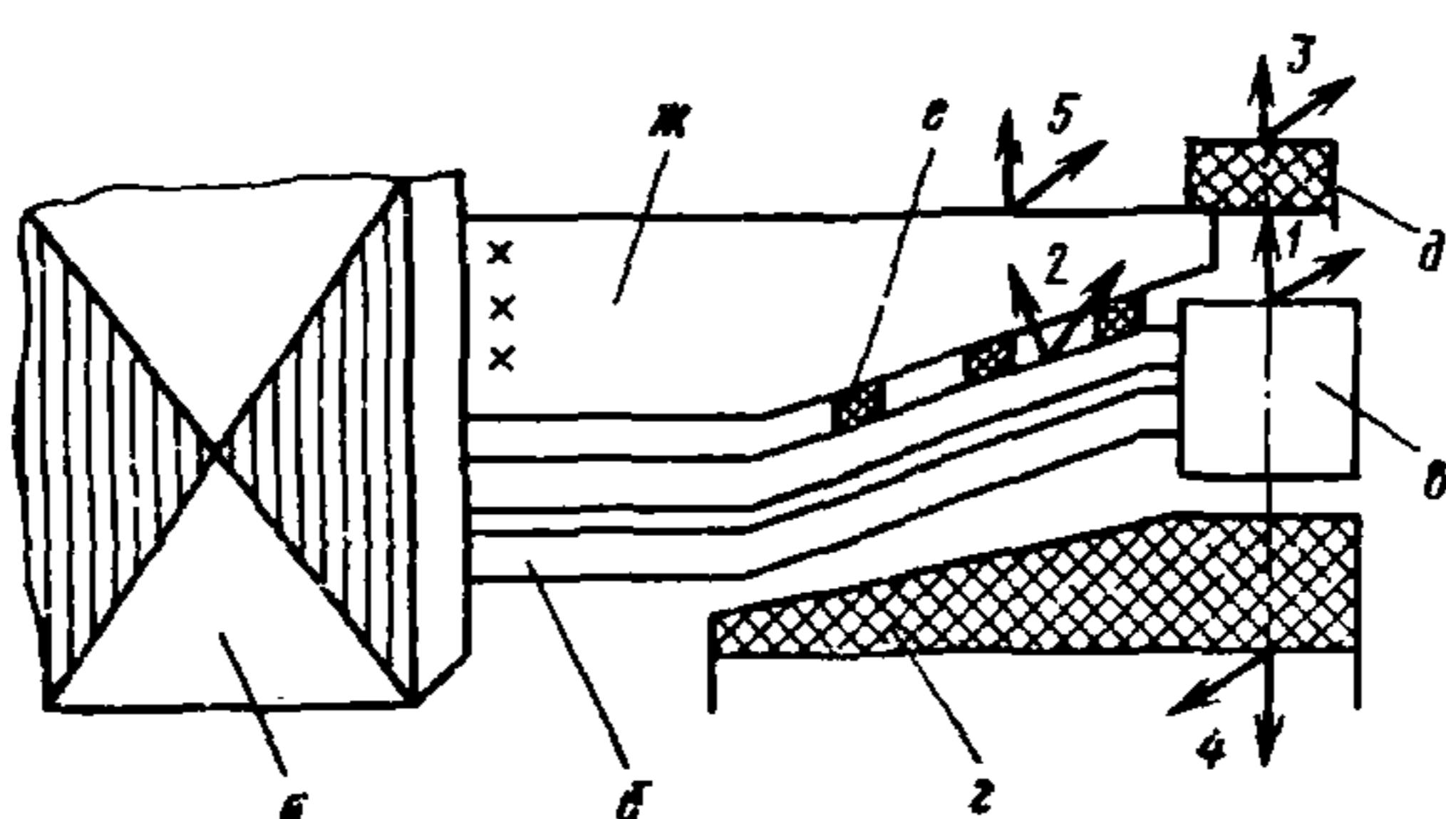
Рис.2. Схема измерения вибропрелемений лобовых частей и элементов креплений обмотки статора турбогенератора:
