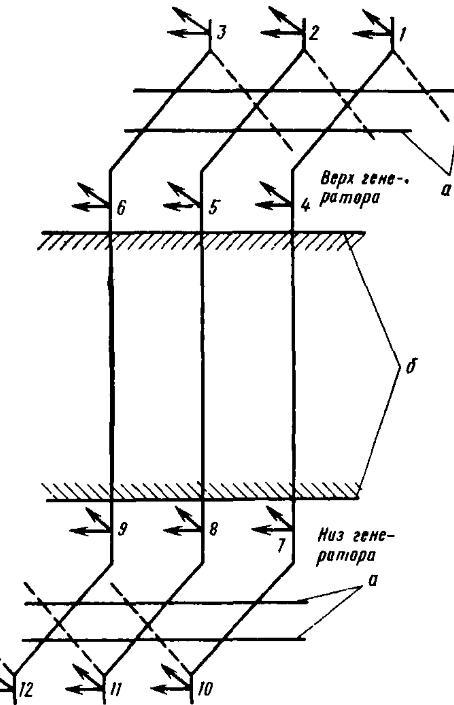
Рис.4. Схема измерения вибропрелемщений лобовых частей обмотки статора гидрогенератора:
