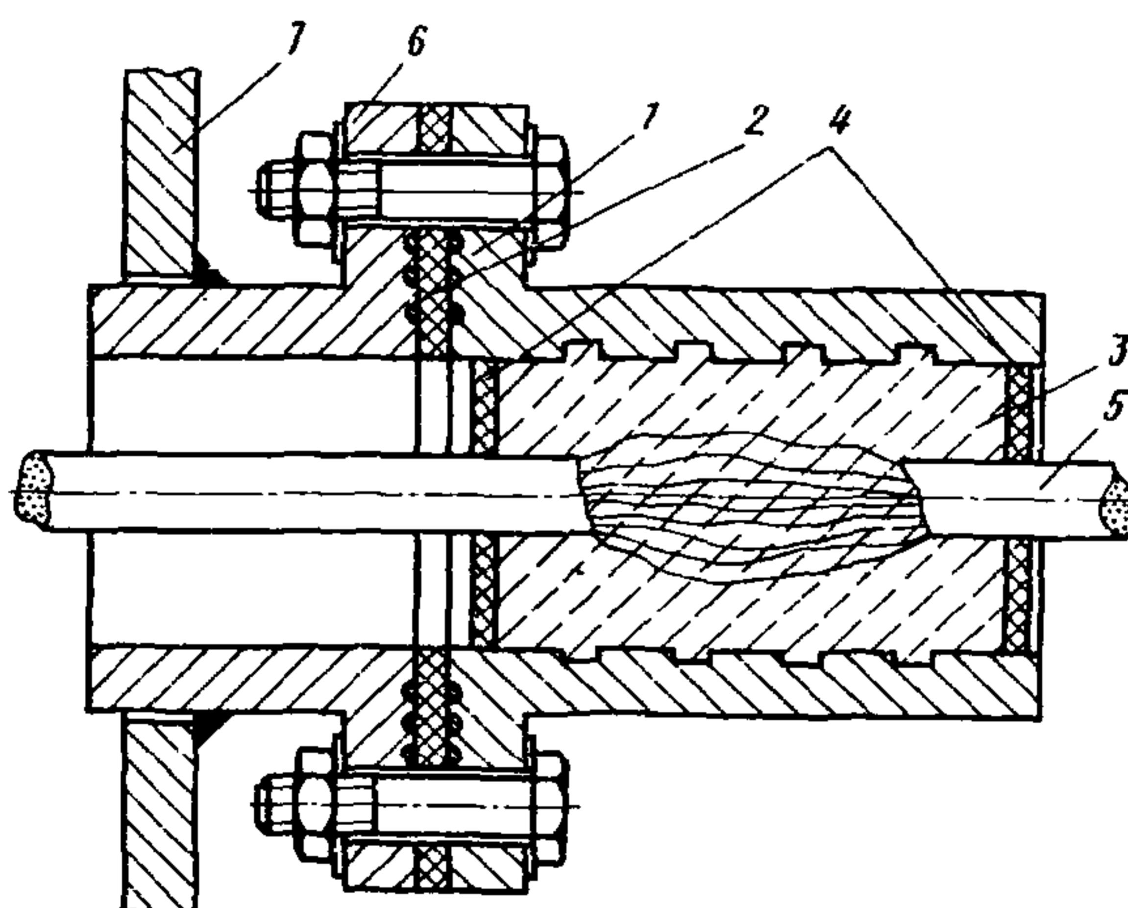
Рис.8. Проходной фланец:
