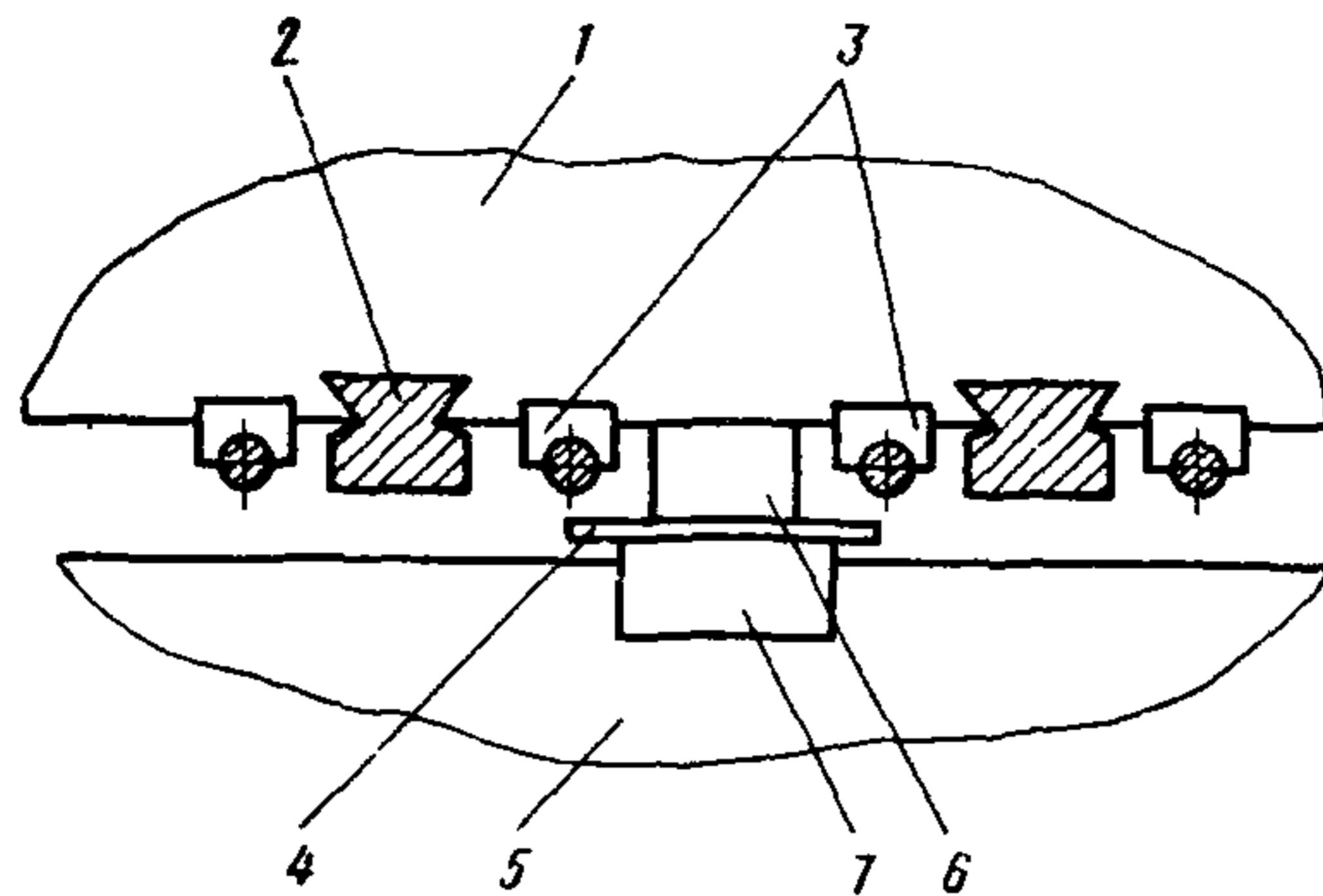
Рис.7. Способ крепления вибродатчиков ВЛН-3 на спинке сердечника статора гидрогенератора:
