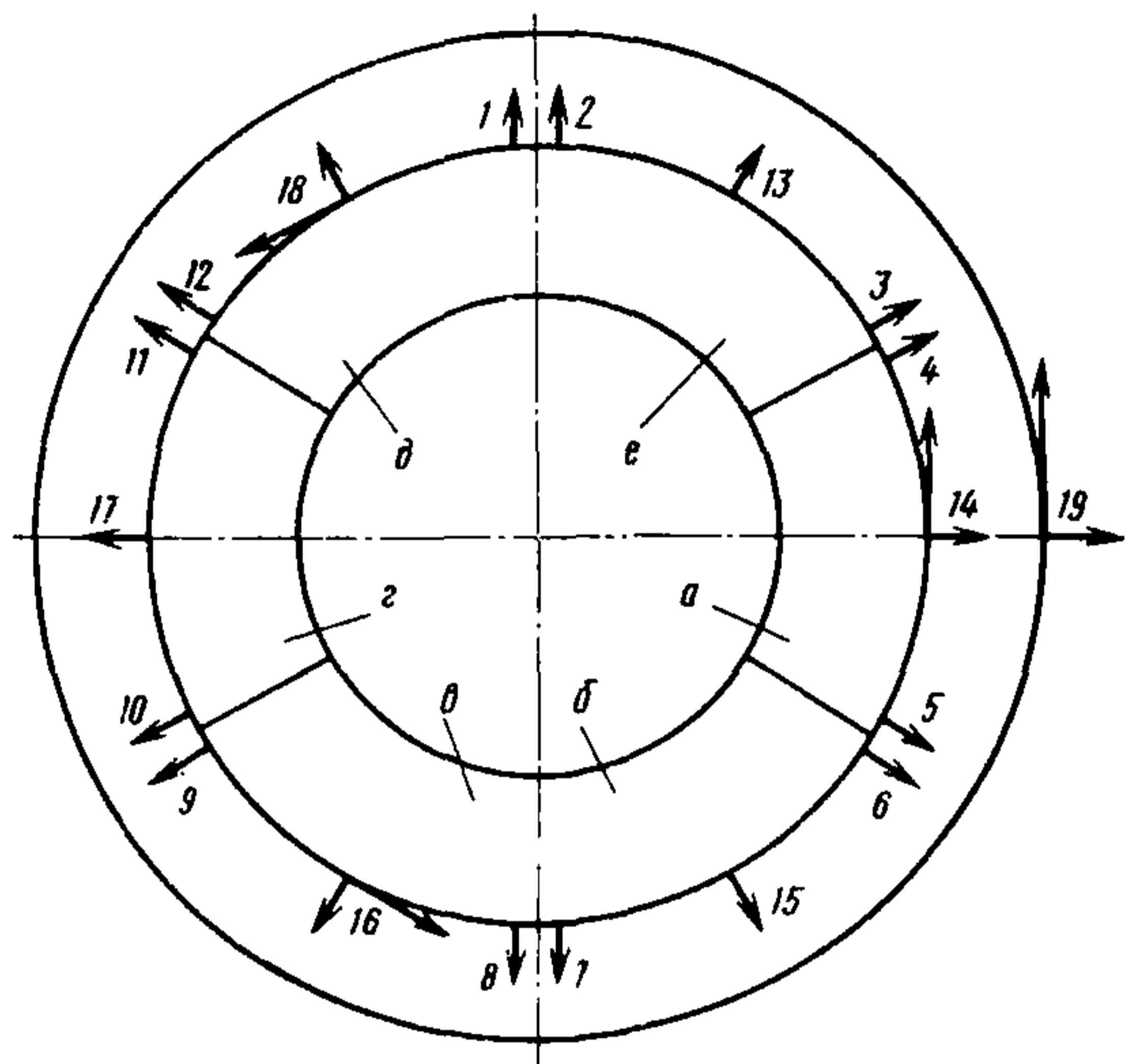
Рис.3. Схема измерения вибропрелемщений сердечника и корпуса статора гидрогенератора:
