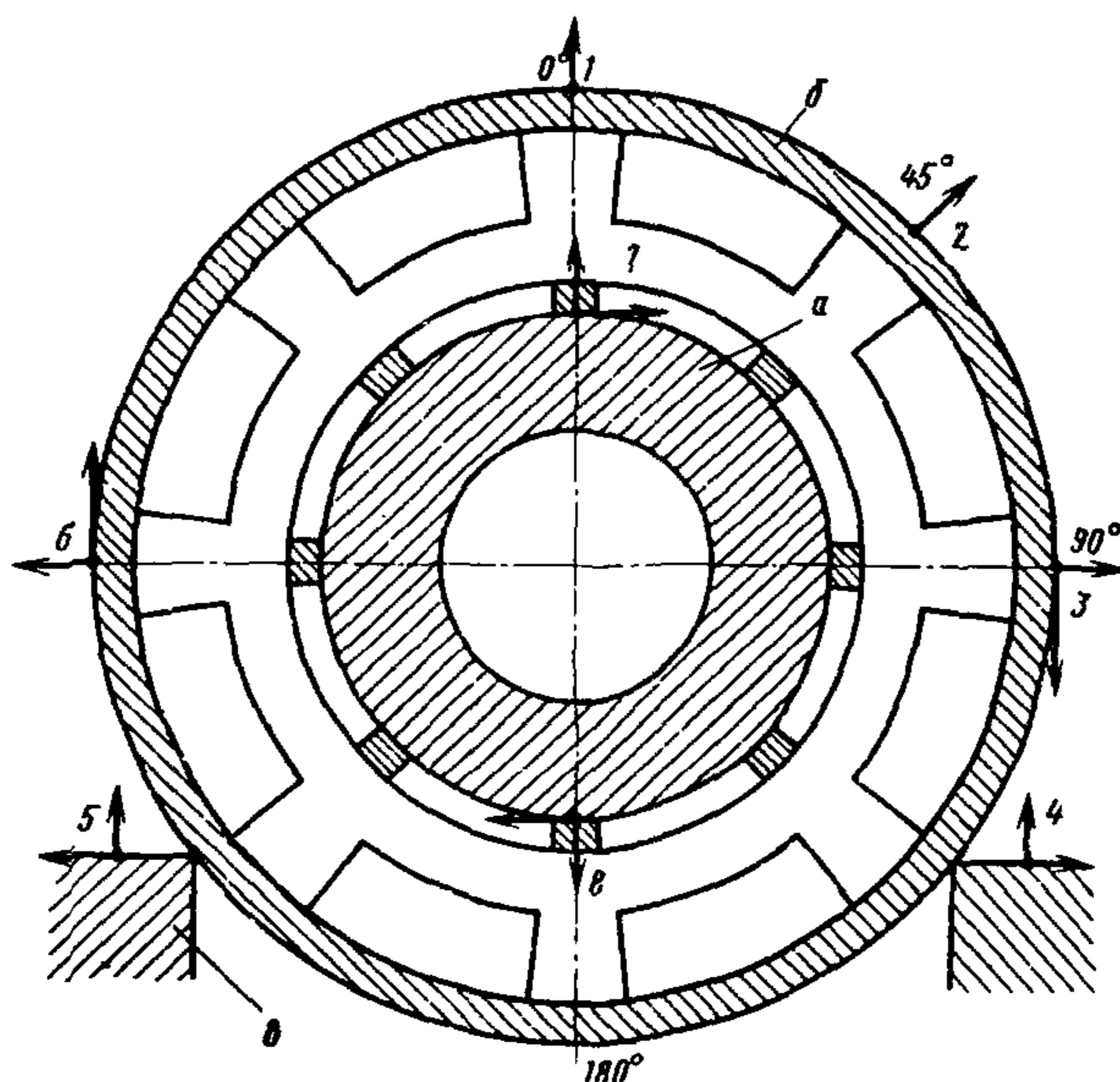
Рис.1. Схема измерения вибропрелемений сердечника статора, корпуса и фундамента турбогенератора:
