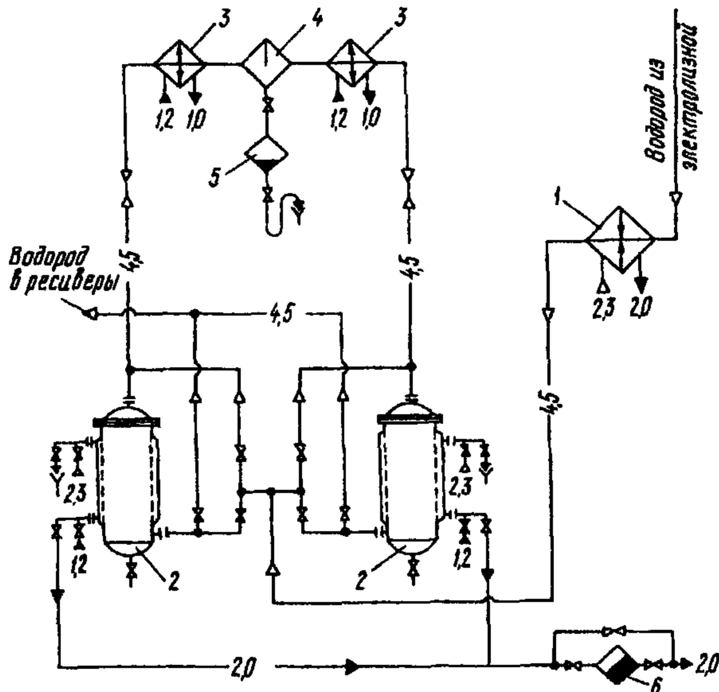
**Рис. 6. Технологическая схема адсорбционной установки осушки водорода:**
