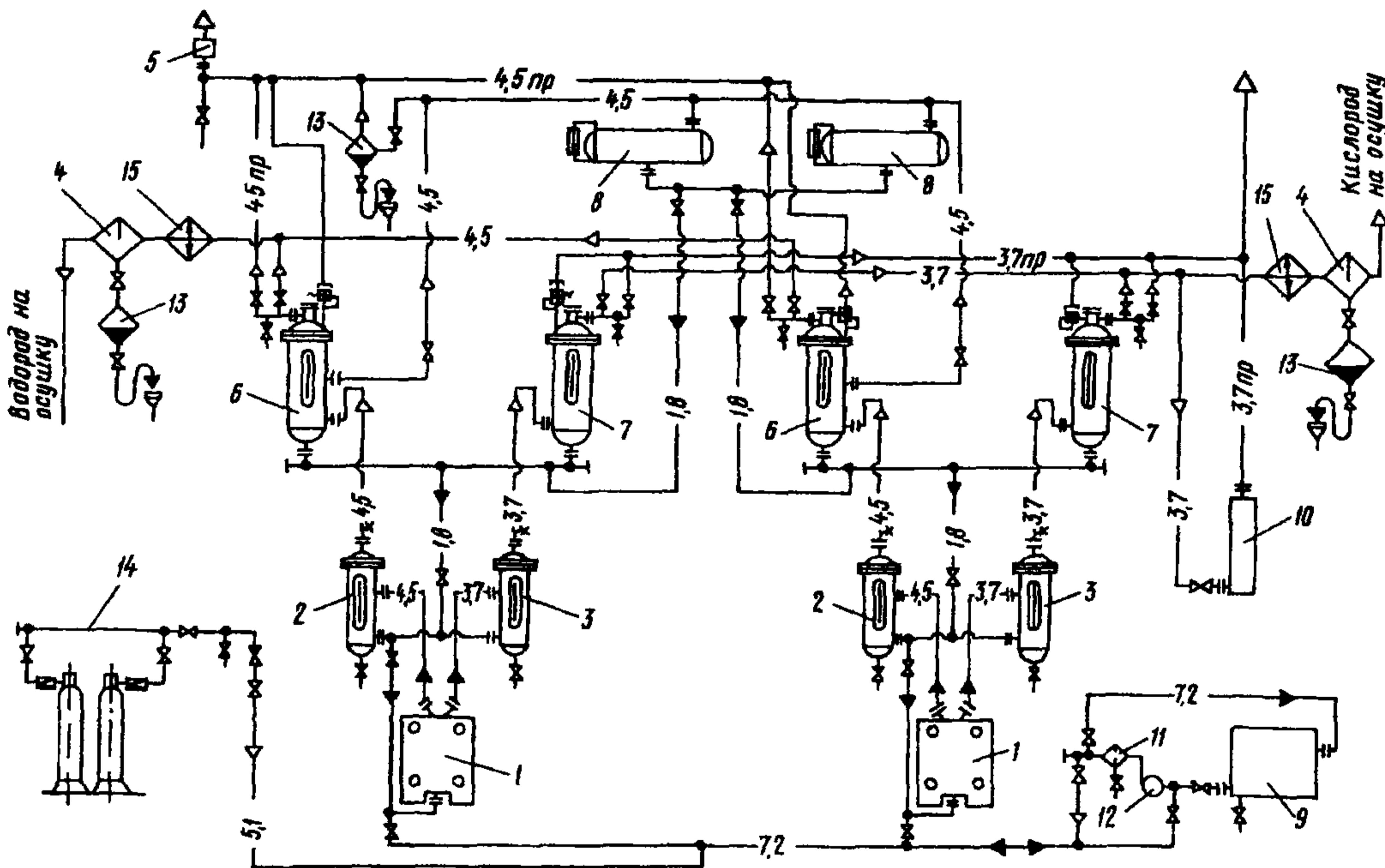
**Рис. 4. Технологическая схема ЭУ СЭУ-20x2 с совмещенными регуляторами-промывателями:**
