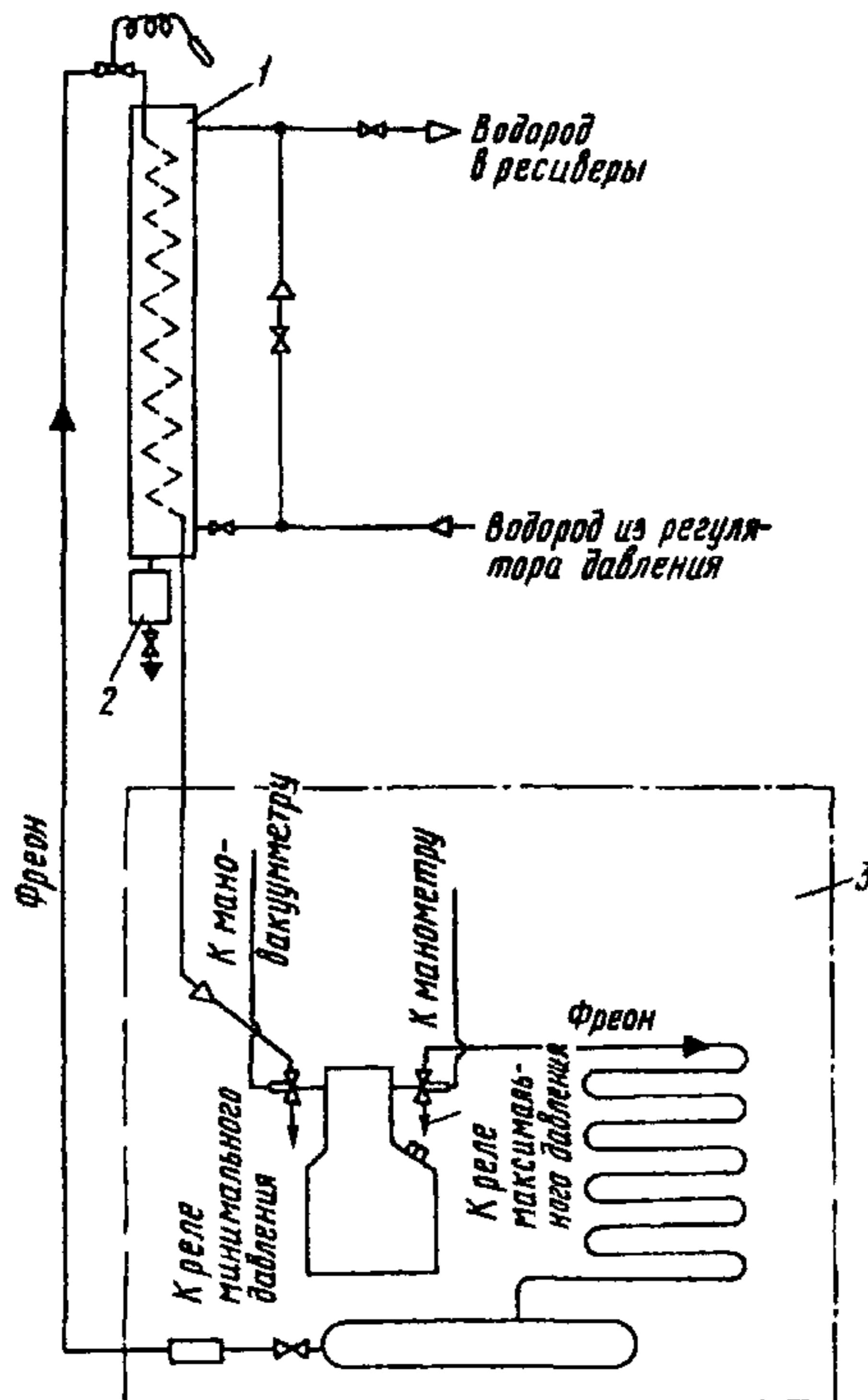
**Рис. 5. Схема установки осушки водорода методом охлаждения:**
