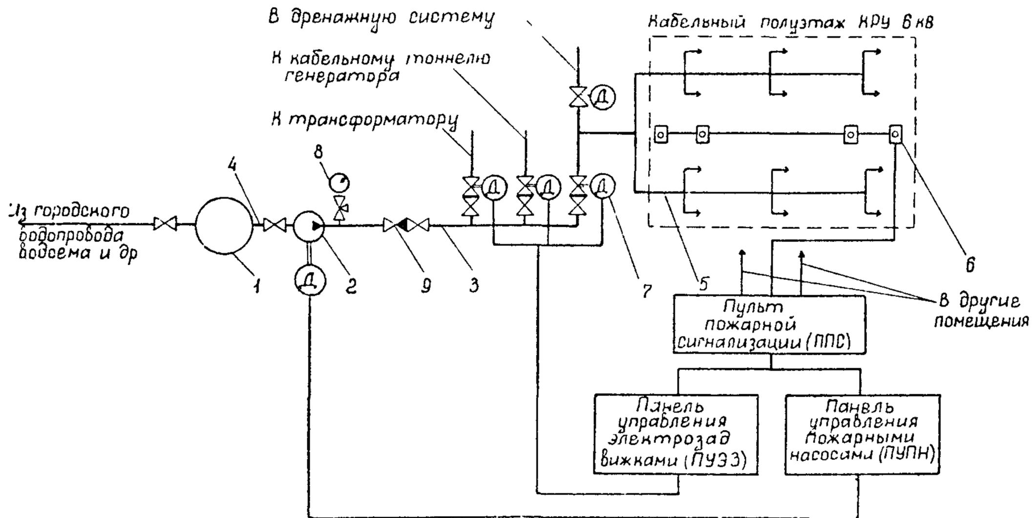
**Принципиальная схема установки водяного пожаротушения:**
