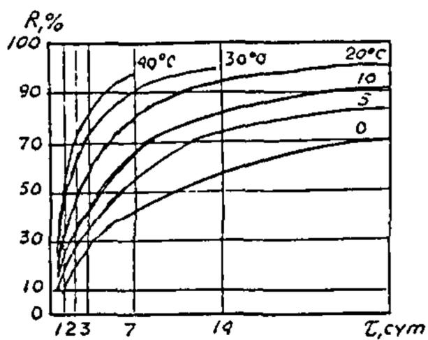
Рис. 7. Нарастание прочности бетона марки 500 на портландцементе марки 600 (в % от  $R_{28}$ ) при температурах от 0 до  $+40^{\circ}\text{C}$
