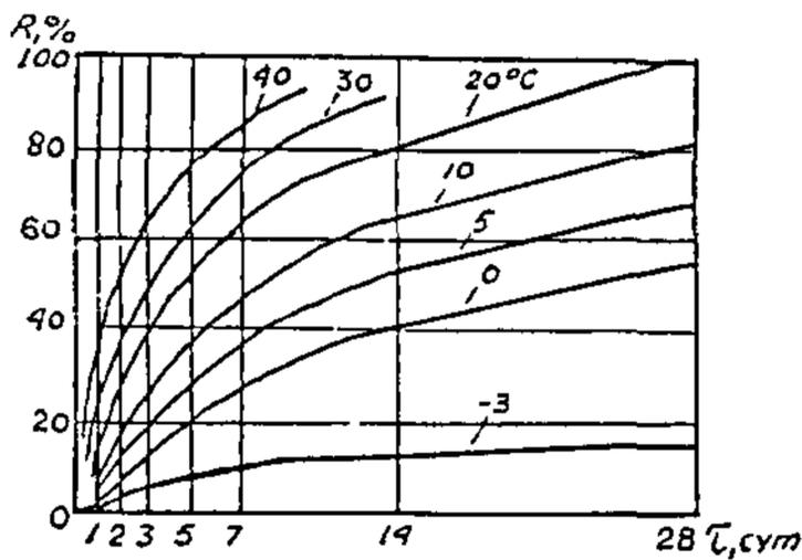
Рис. 3. Нарастание прочности бетона марки 200 на портландцементе марки 300 (в % от  $R_{28}$ ) при температуре от  $-3$  до  $+40^{\circ}\text{C}$
