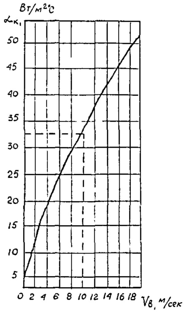
Рис. 8. Зависимость коэффициента передачи тепла конвекцией от скорости ветра
