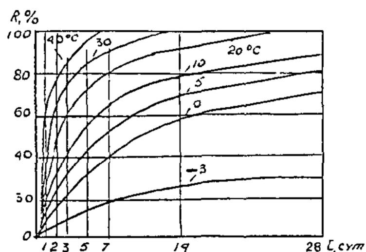
Рис. 4. Нарастание прочности бетона марок 400 на портландцементе марки 500 (в % от  $R_{28}$ ) при температурах от  $-3$  до  $+40^{\circ}\text{C}$
