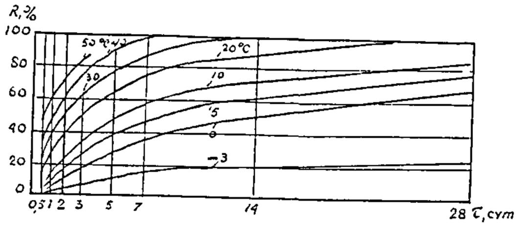
Рис. 2. Нарастание прочности бетона марок 200-300 на портландцементе марки 400 (в % от  $R_{28}$ ) при температурах от  $-3$  до  $+50^{\circ}\text{C}$
