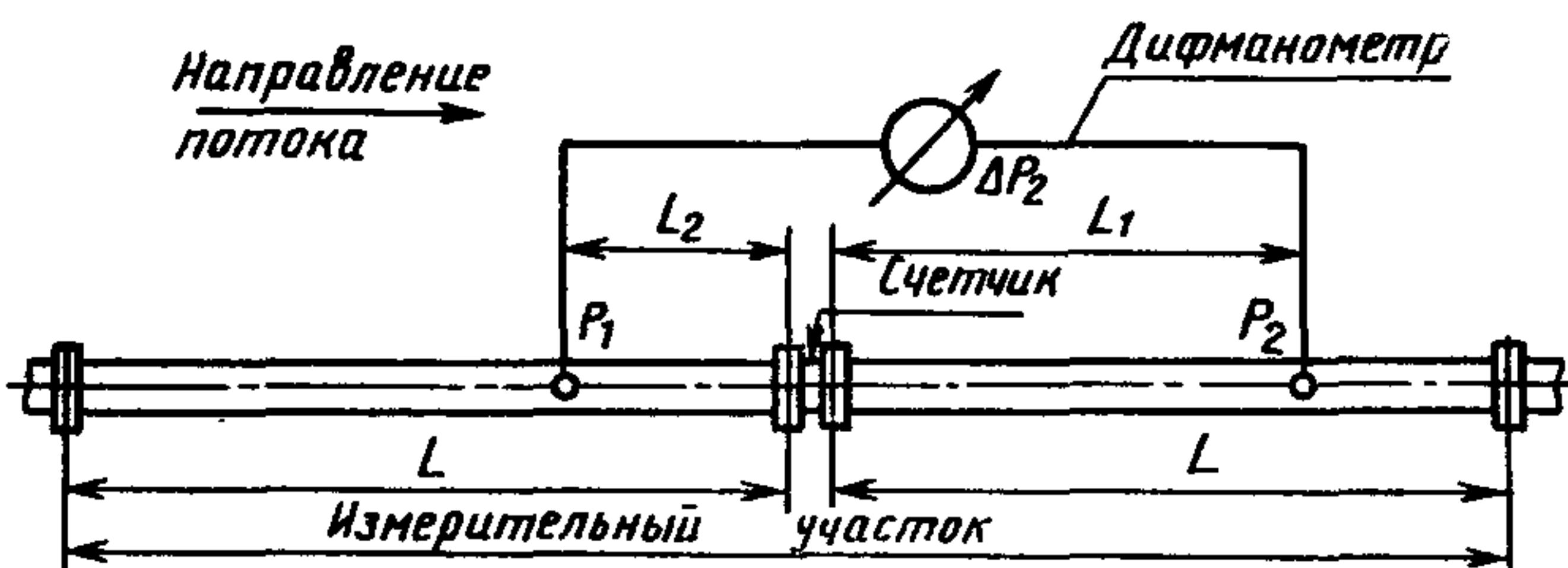
$\Delta P_2$  — потеря давления на участках трубопровода вверх и вниз по потоку и на счетчике:  $\Delta P_2 = (\Delta PL_2 + \Delta PL_1 + \Delta P_{\text{сч}})$ ;  $\Delta P_2 - \Delta P_1 = (\Delta PL_2 + \Delta PL_1 + \Delta P_{\text{сч}}) - (\Delta PL_2 + \Delta PL_1) = \Delta P_{\text{сч}}$
