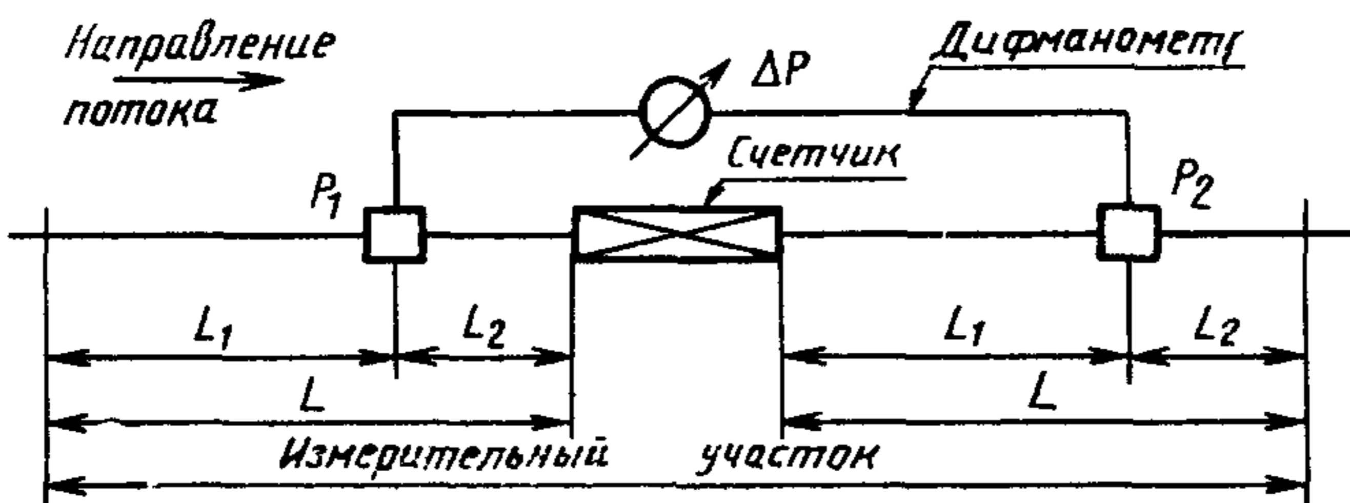
$P_1$  и  $P_2$  — отверстия для отбора давления,  $L \geq 15 D$ ,  $L_1 \geq 10 D$ ,
