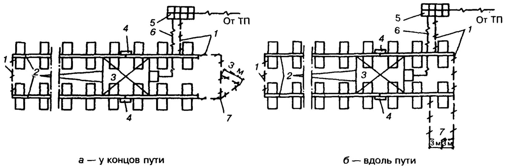
1 — заземляющий проводник; 2 — путь; 3 — кран; 4 — перемычка; 5 — распределительный пункт;
