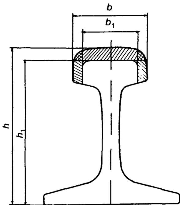
$b$  — ширина головки рельса, мм;  $b_1$  — предельные значения по ширине головки рельса, мм;  $h$  — высота рельса, мм;  $h_1$  — предельные значения по высоте рельса, мм
