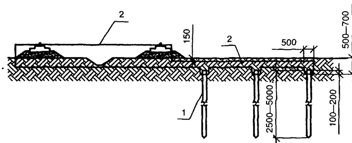
1 — заземлитель; 2 — заземляющий проводник
