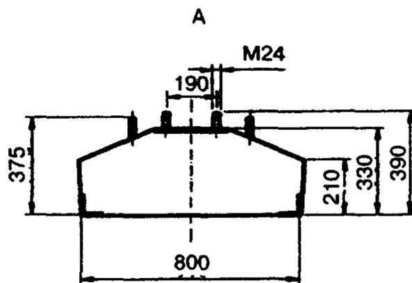
**Б4. Железобетонная плита**
