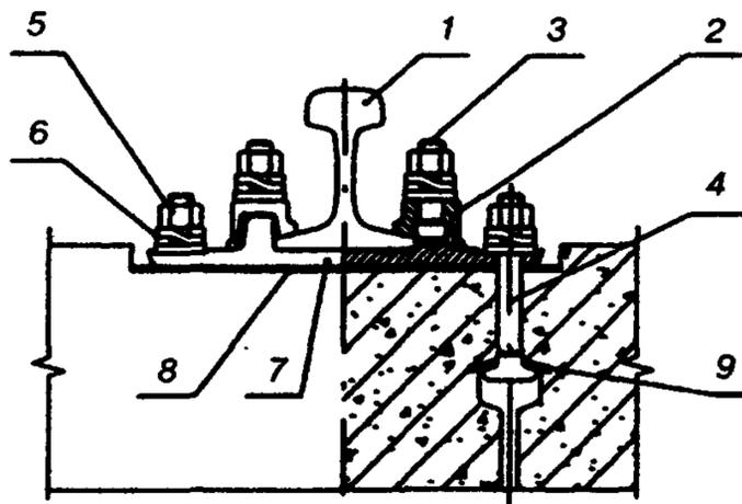
1 — рельс; 2 — жесткая клемма; 3 — клеммный болт; 4 — закладной болт; 5 — гайка; 6 — двухвитковая шайба; 7 —
