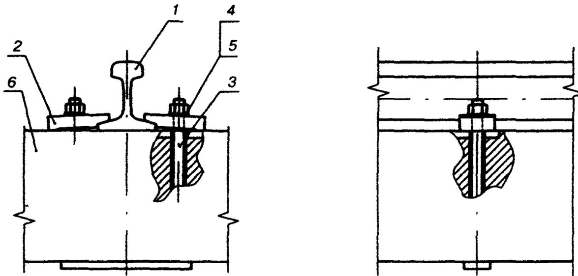
1 — рельс; 2 — прижим; 3 — шпилька; 4 — гайка; 5 — шайба пружинная; 6 — железобетонный опорный элемент (плита)
