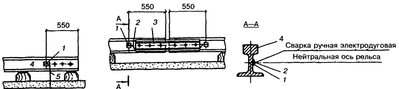
1 — промежуточная пластина; 2 — перемычка; 3 — накладка; 4 — рельс; 5 — заземляющий проводник
