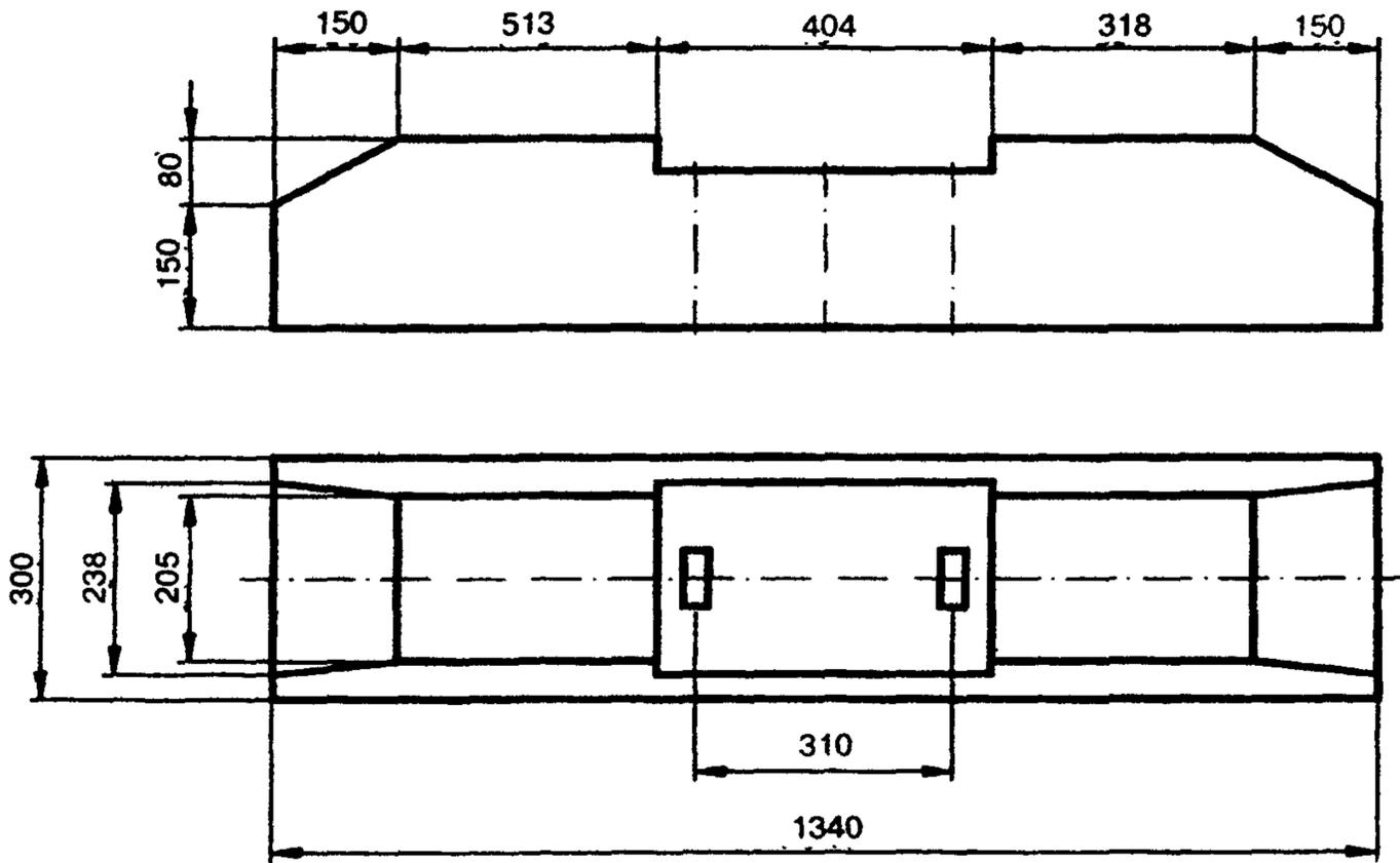
**Б2. Железобетонная полушпала типа ПШН4-13-325-1**
