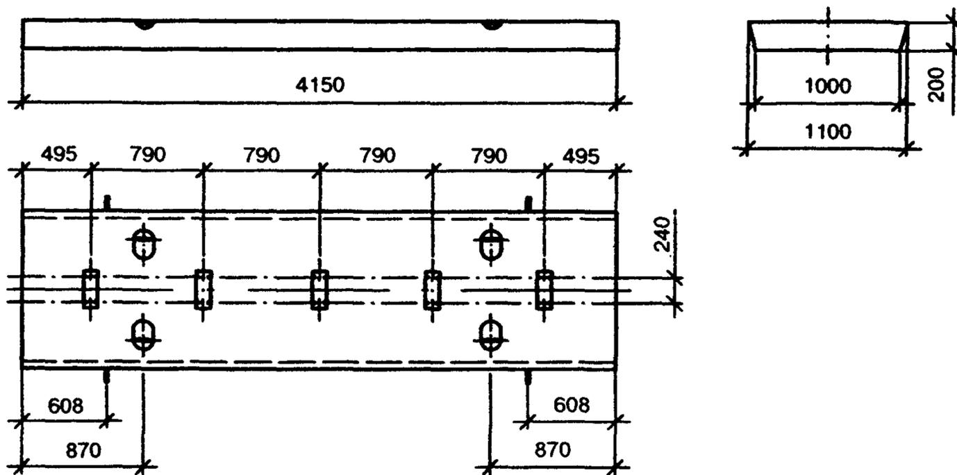
**Б5. Железобетонная балка типа БРК-6.24-04**
