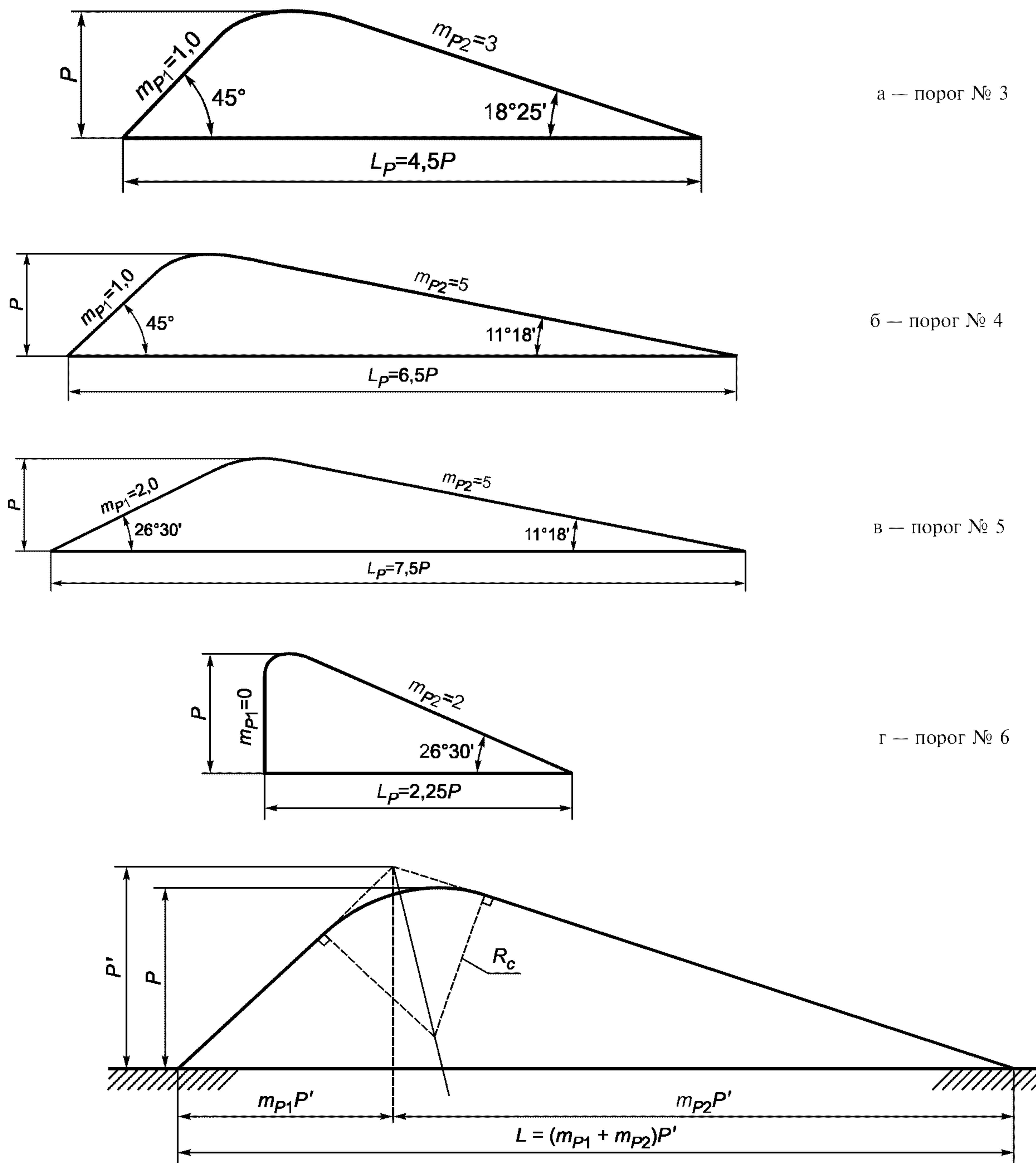
$m_{P1}$  — коэффициент верхового откоса (число по горизонтали);  $m_{P2}$  — коэффициент низового откоса (число по горизонтали);  $L_P$  — длина продольного профиля порога по основанию;  $P$  — высота порога относительно дна канала верхнего бьефа;  $P'$  — высота остроугольного порога по радиусу закругления относительно дна канала верхнего бьефа (рисунок 2д);  $R_c$  — радиус закругления гребня порога
