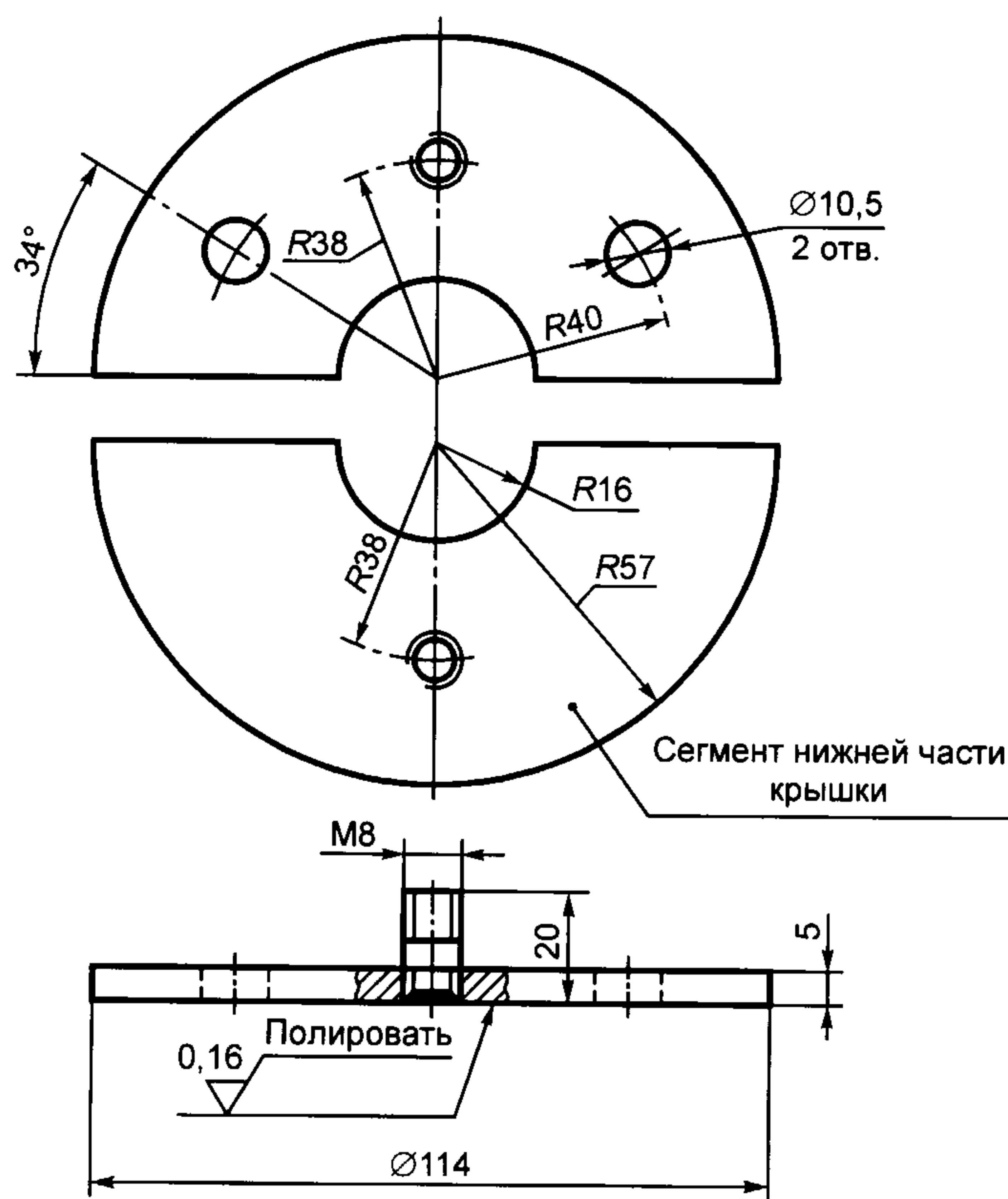
Рисунок А.9 — Крышка стального цилиндра
