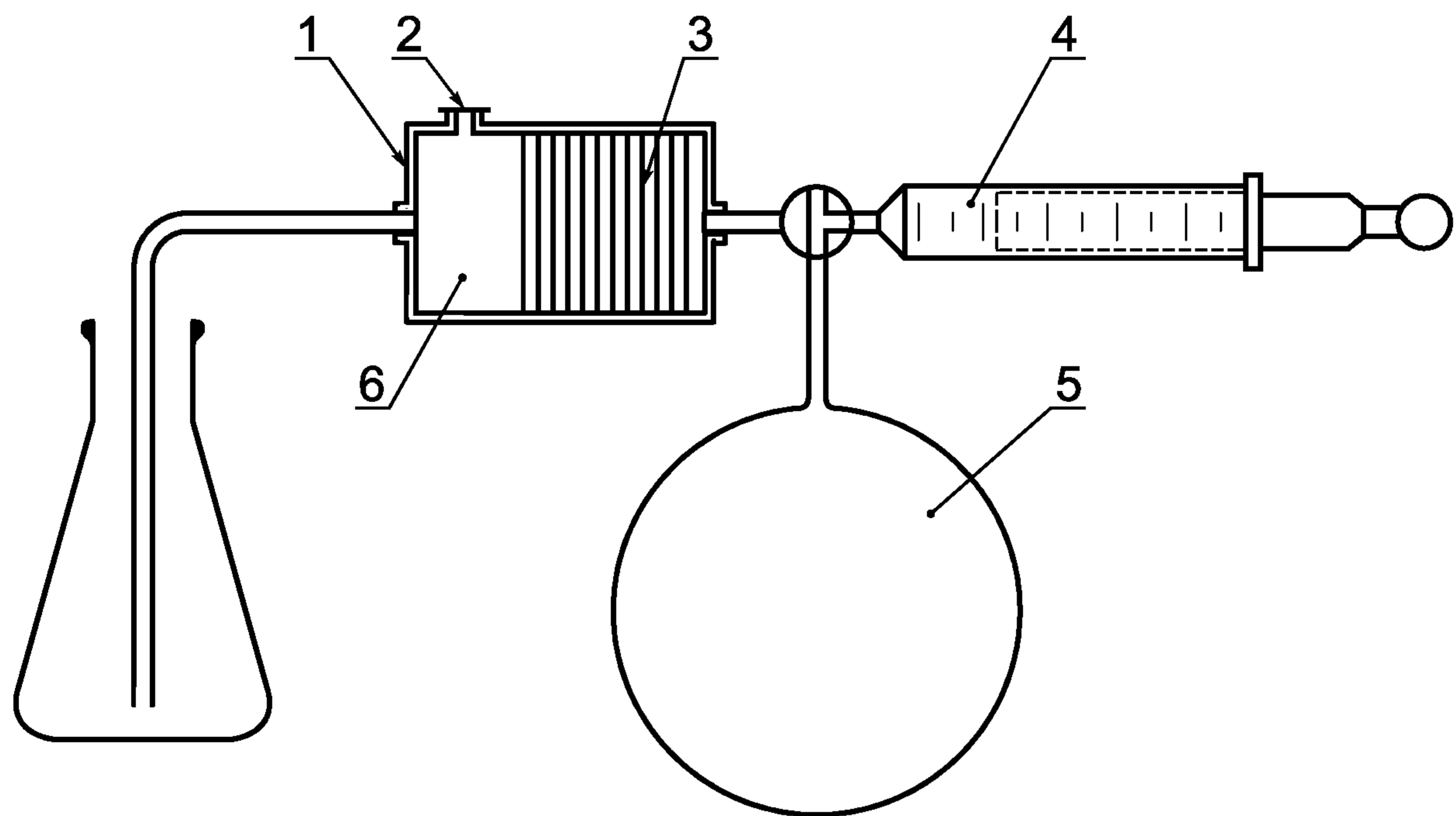
1 — огнепреградитель; 2 — предохранительная мембрана; 3 — пластинки из спеченного стекла (перегородки);
