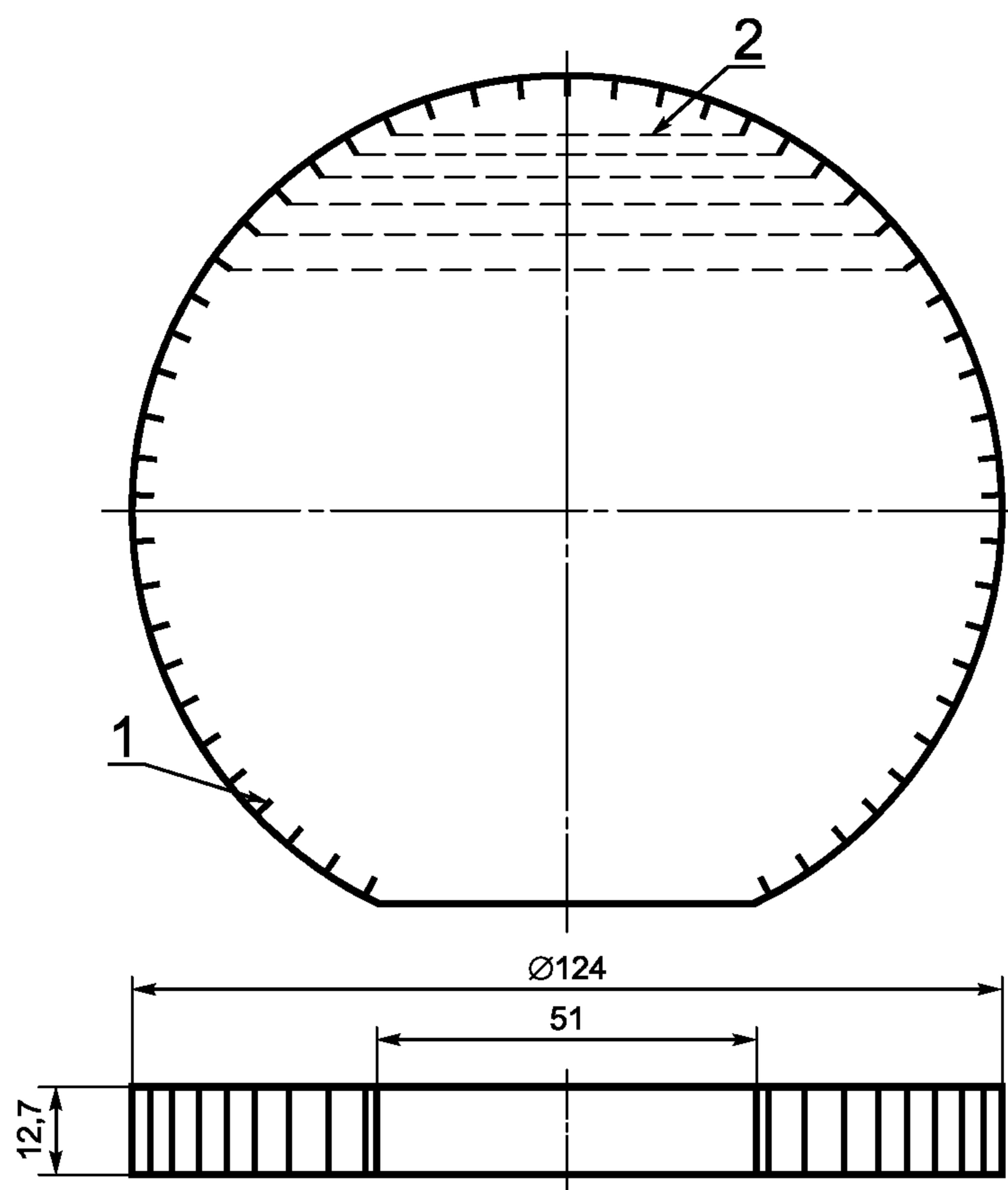
1 — паз размером 1,5-1,5 мм на боковой поверхности диска;
