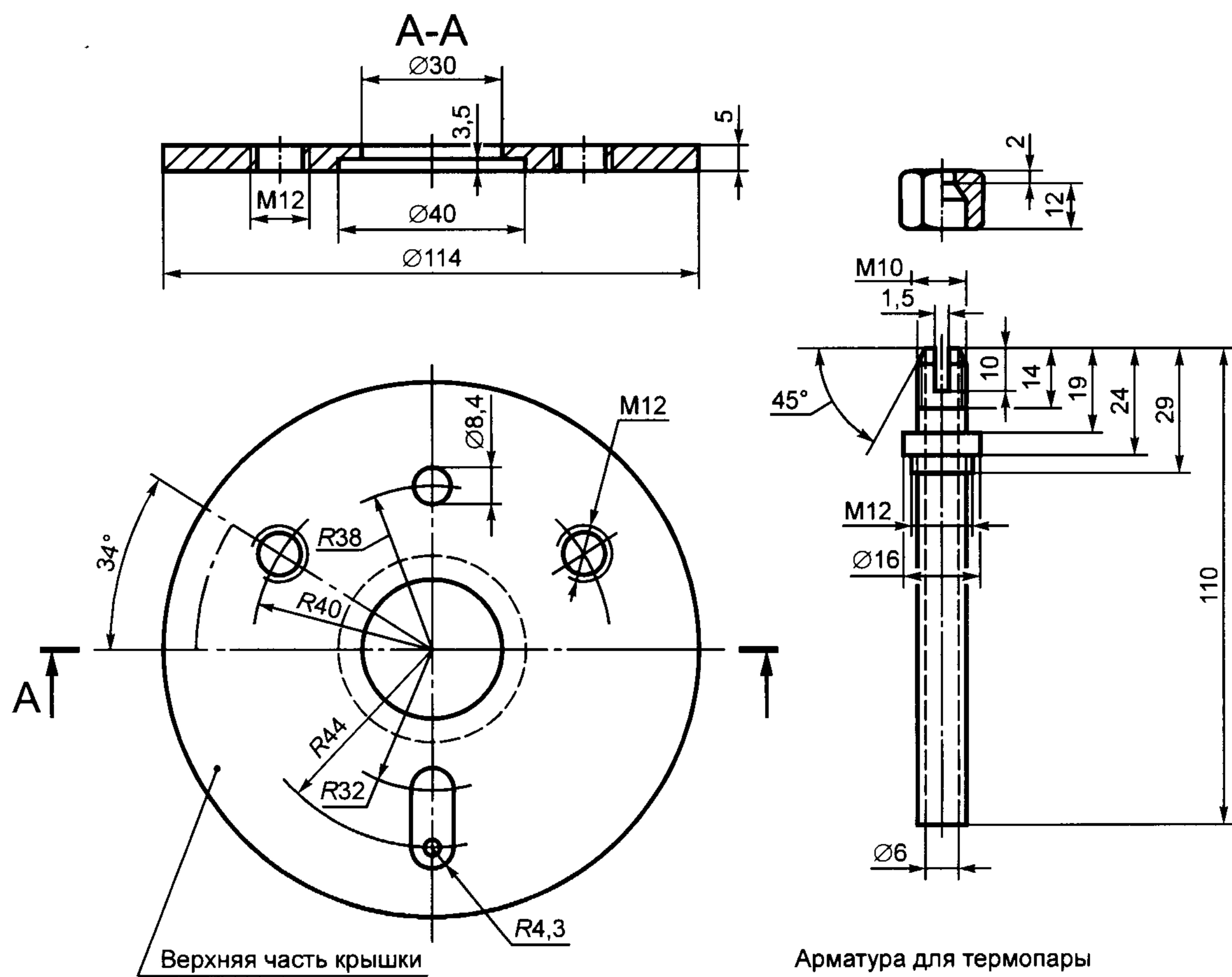
Рисунок А.8 — Крышка стального цилиндра
