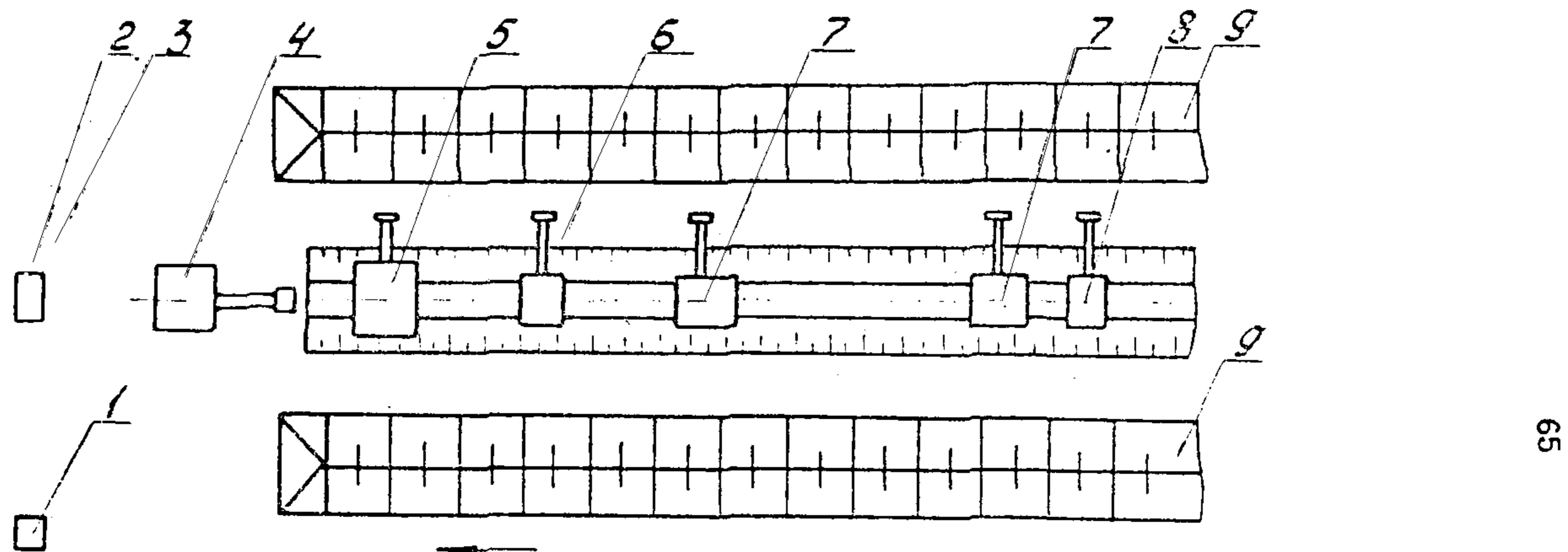
I - нивелир; 2 - геодезическая рейка; 3 - шурф; 4 - вскрывной экскаватор;
