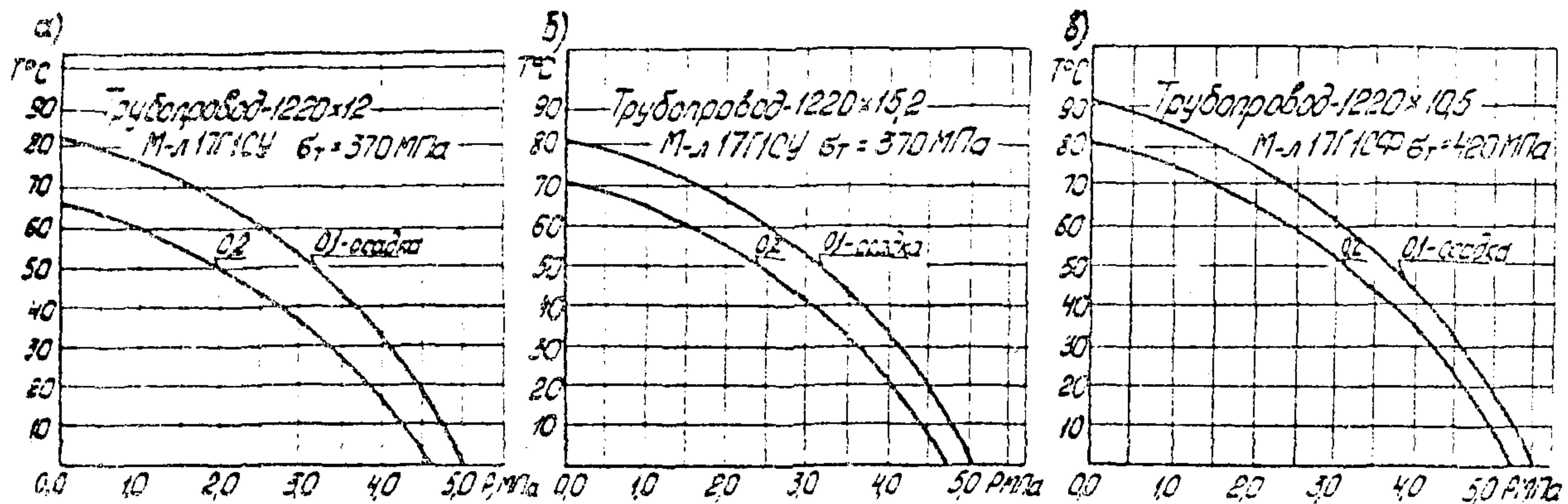
а) для трубопровода диаметром 1220x12; б) 1220x15,2; в) 1220x10,5
