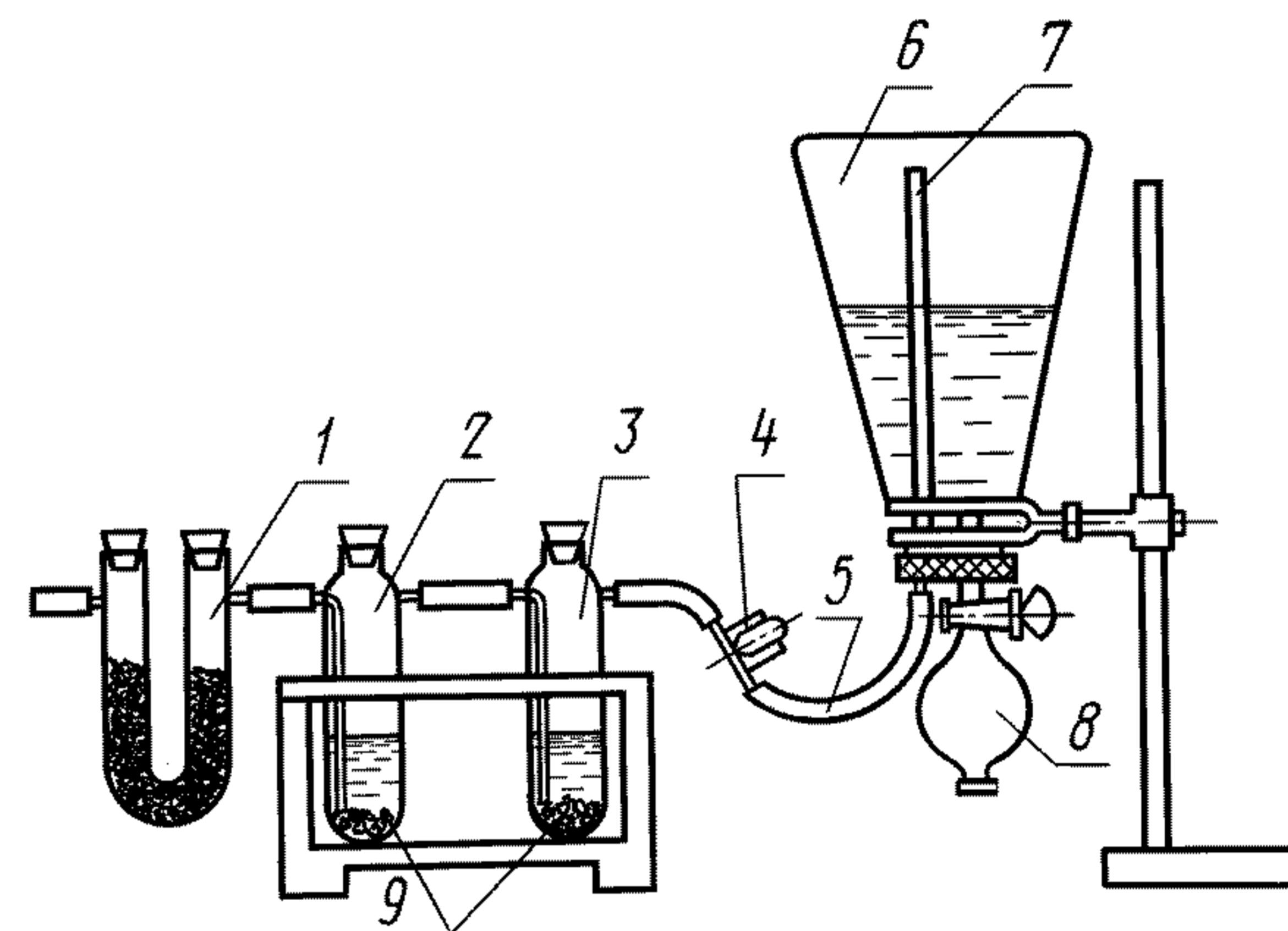
1 — трубка TX-U; 2, 3 — склянки для промывания газов; 4 — винтовой зажим; 5 — резиновая трубка; 6 — коническая колба; 7 — стеклянная трубка; 8 — капельная воронка; 9 — фильтры
