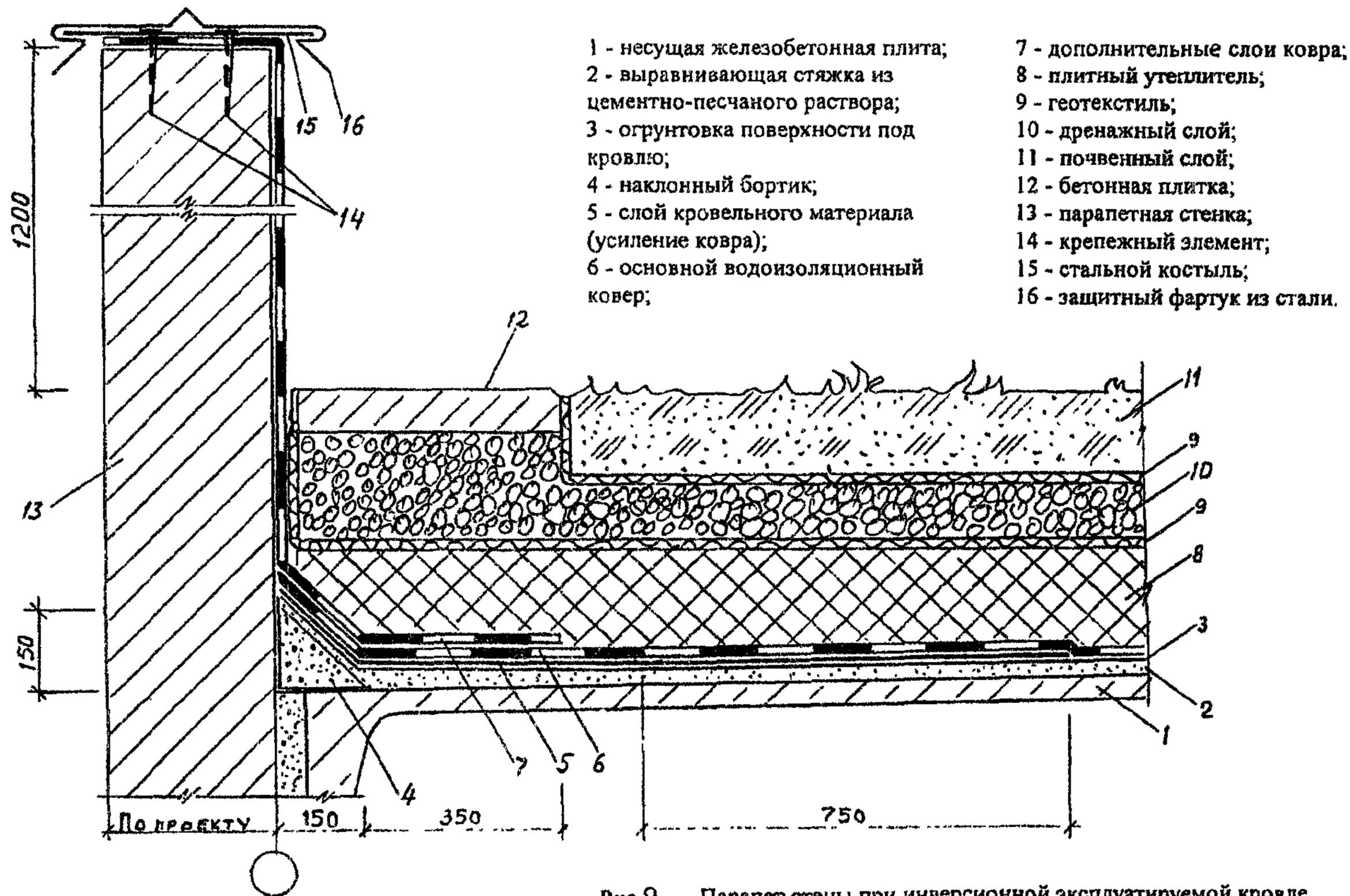
Рис.9 Парапет стены при инверсионной эксплуатируемой кровле.
