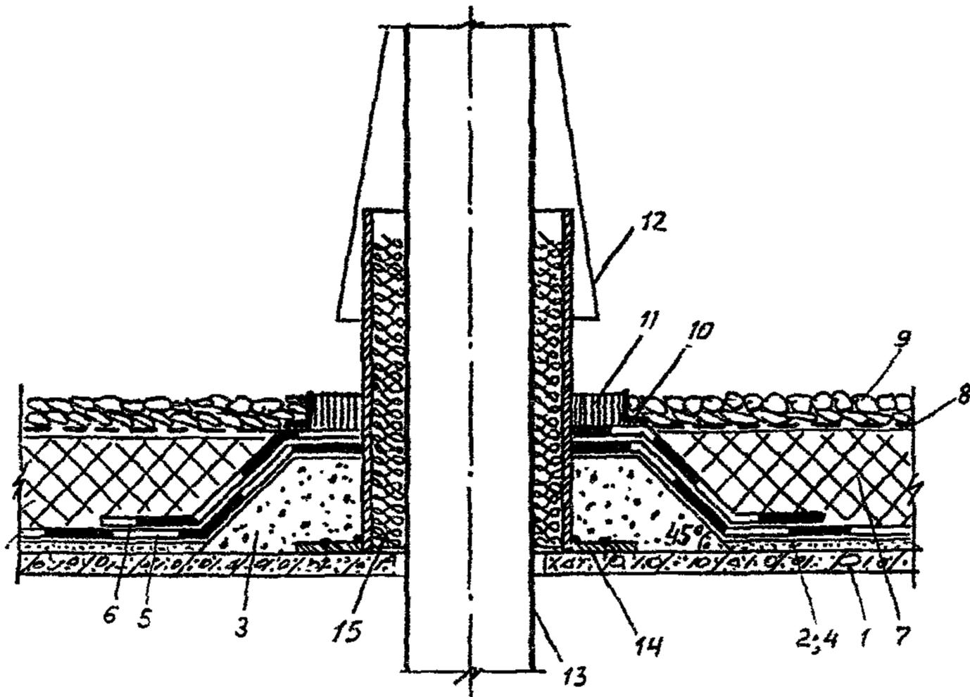
Рис.4 Пропуск трубы через инверсионную эксплуатируемую кровлю.
