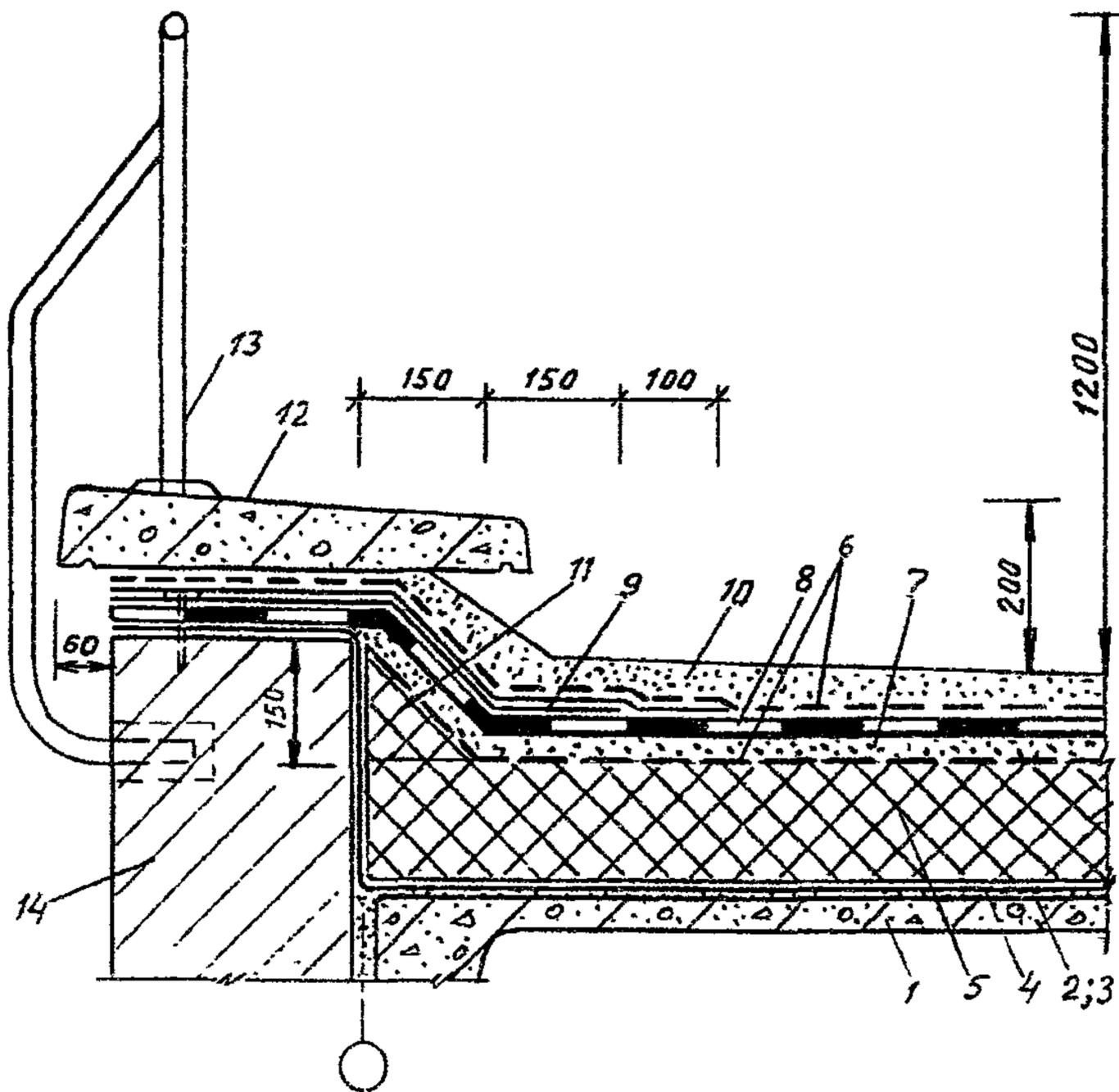
Рис 7 Парапет продольной стены при традиционной эксплуатируемой кровле
