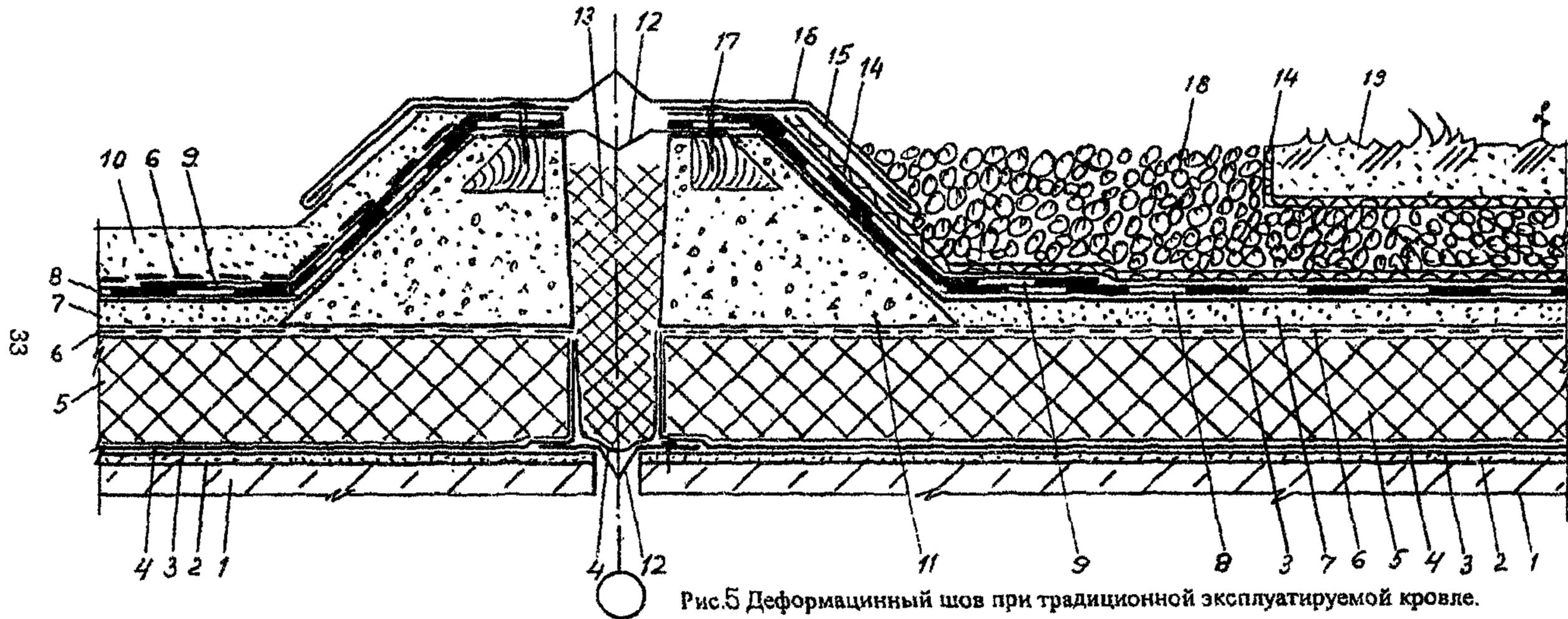
Рис.5 Деформационный шов при традиционной эксплуатируемой кровле.
