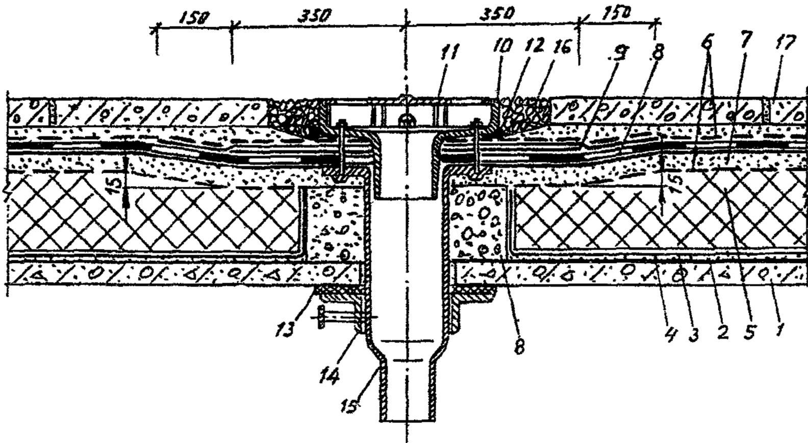
Рис 10 Воронка внутреннего водостока при традиционной эксплуатируемой кровле.
