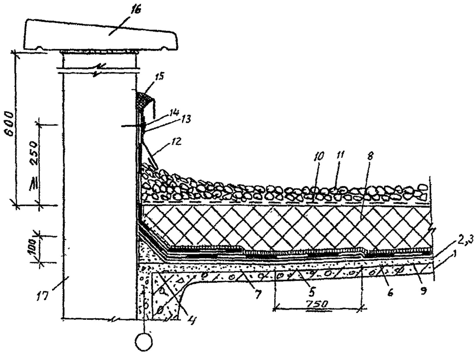
Рис. 8 Парапет продольной стены при инверсионной эксплуатируемой кровле
