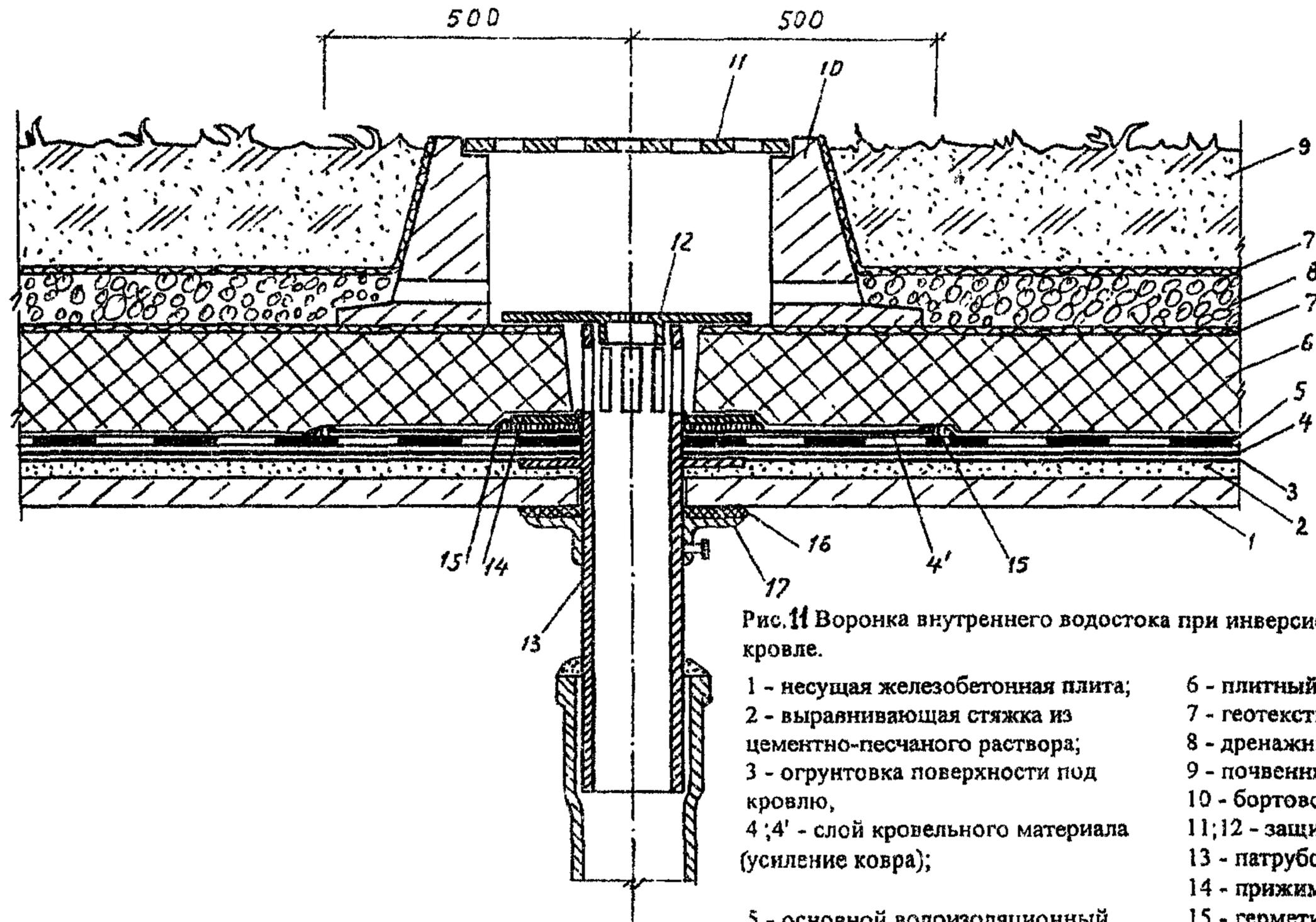
Рис. 11 Воронка внутреннего водостока при инверсионной эксплуатируемой кровле.
