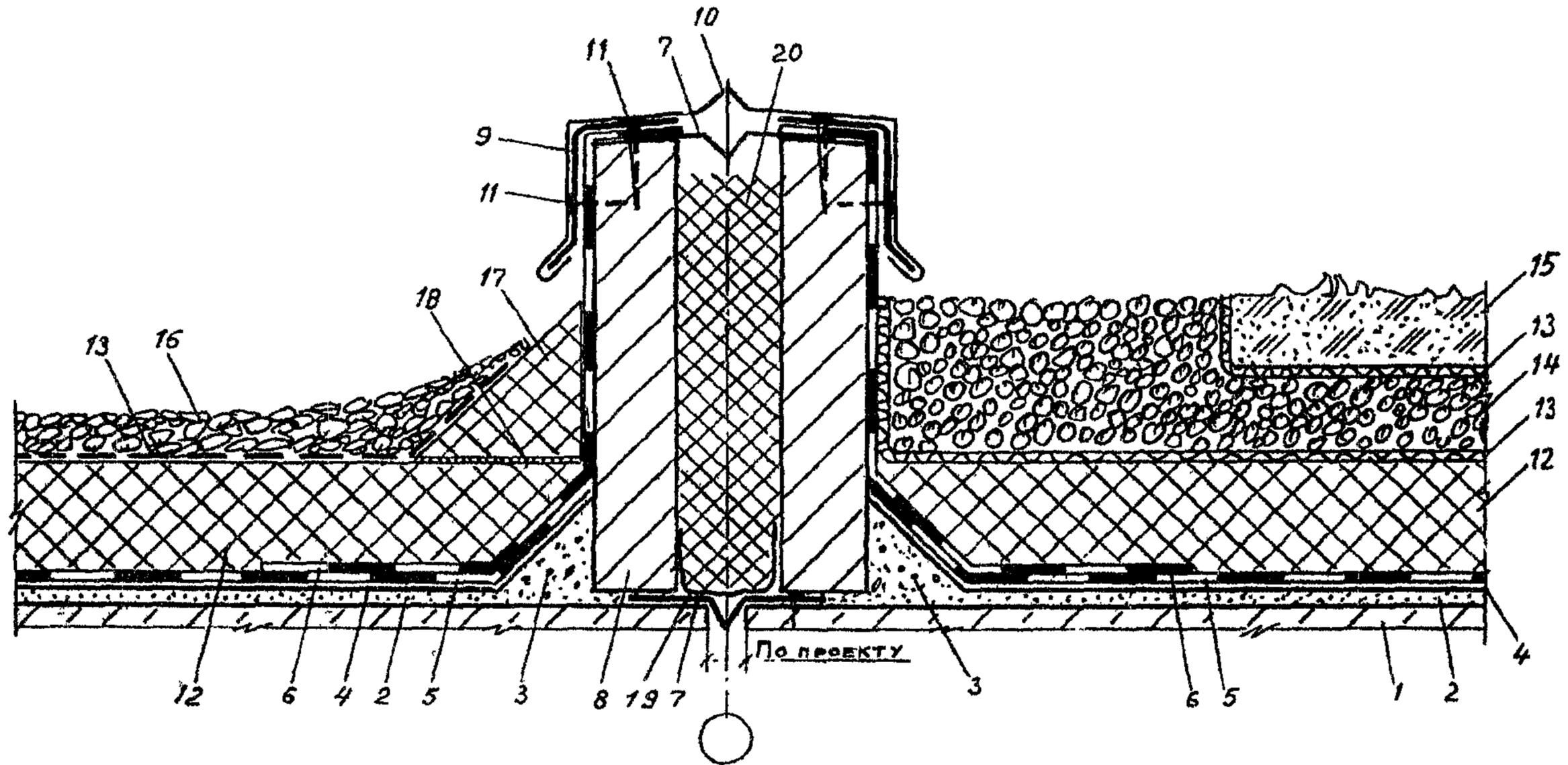
Рис.6 Деформационный шов при инверсионной эксплуатируемой кровле.
