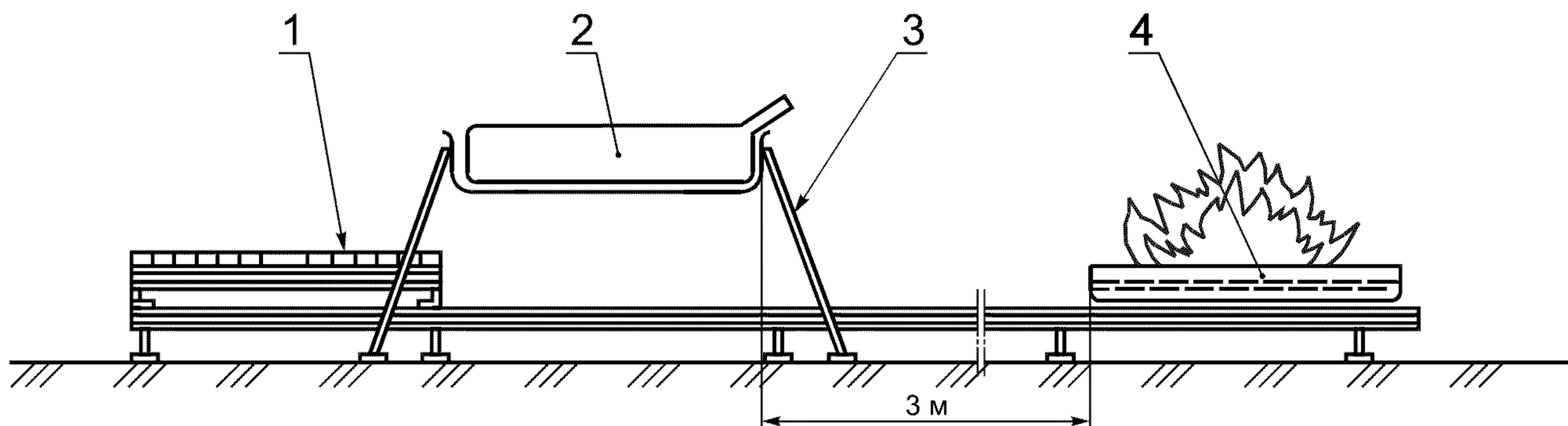
1 — решетка; 2 — топливный бак; 3 — испытательный стенд; 4 — поддон с горячим топливом
