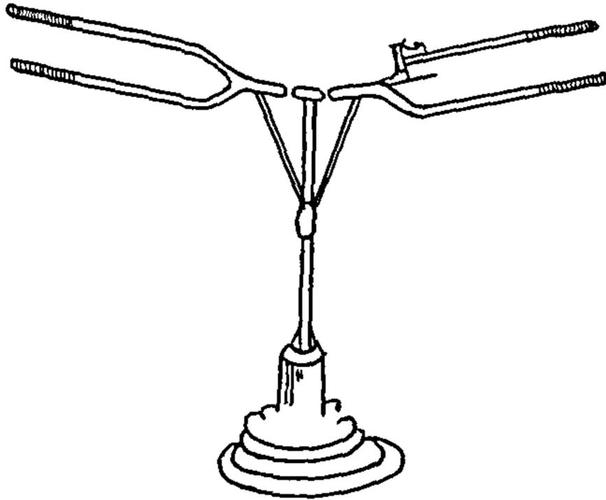
Рис. 4.2.3. Вакуум-захват для укладки плит размером 50x50 см
