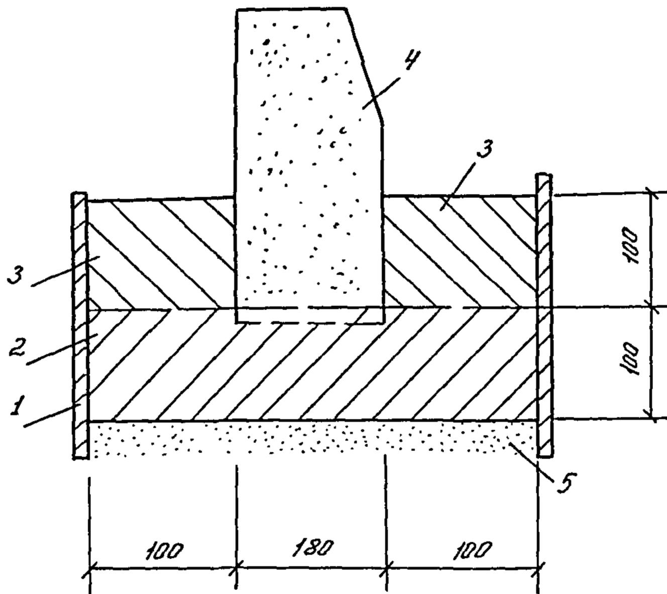
Рис. 5.2.1. Схема установки бортового камня:
