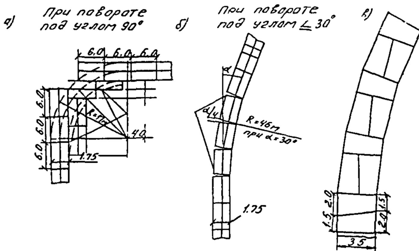
Рис. 3.1.6. Схемы раскладки плит на поворотах временных дорог:
