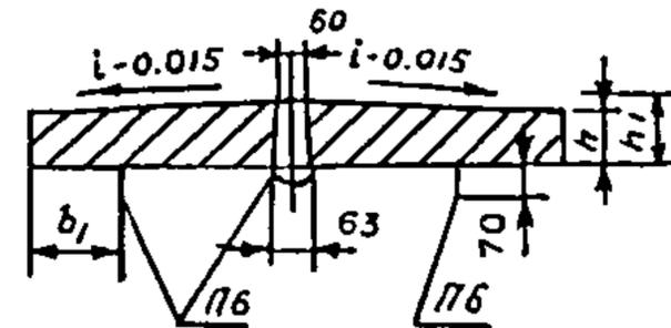
Рис. 3.1.4. Шестиугольная плита (ПШ); шестиугольная осевая поперечная (ПШП); шестиугольная осевая диагональная (ПШД)
