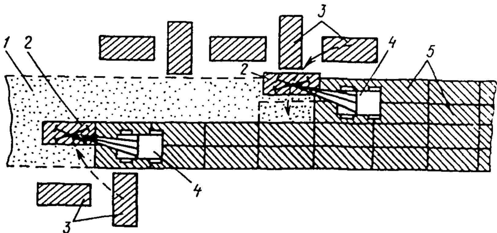
Рис. 3.2.1. Укладка плит двумя кранами в одном потоке:
