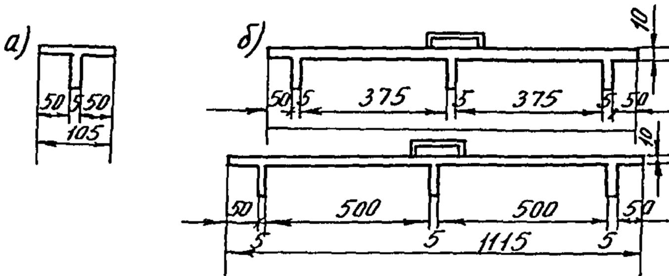
Рис. 4.2.4. Приспособления для контроля ширины швов:
