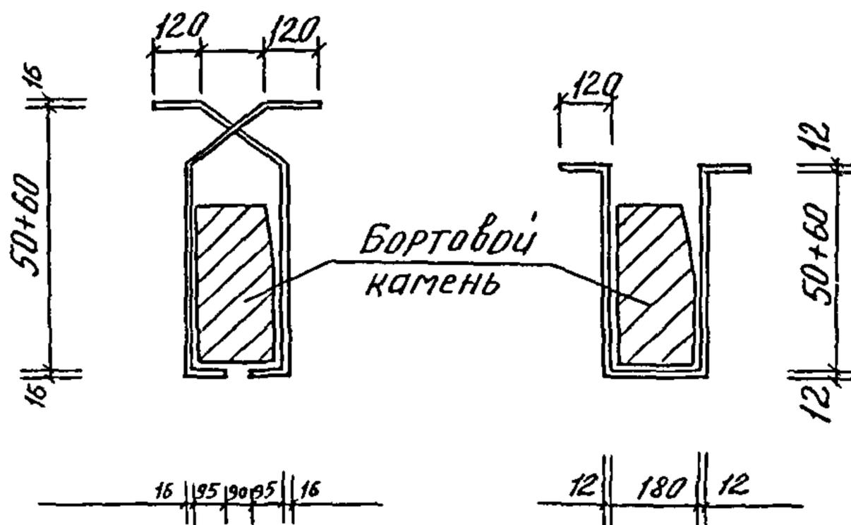
Рис. 5.2.2. Схемы приспособлений для установки бортовых камней
