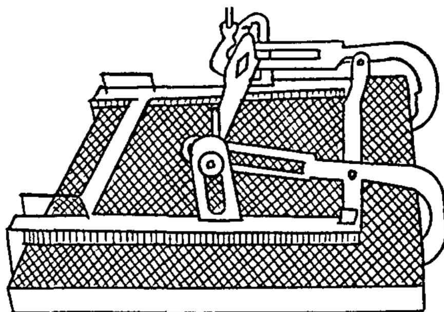
Рис. 4.2.2. Захват для укладки плит со стороной 100 см
