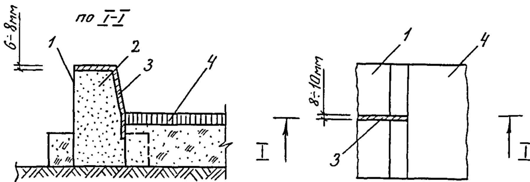
Рис. 5.2.4. Схема заделки шва между бортовыми камнями:
