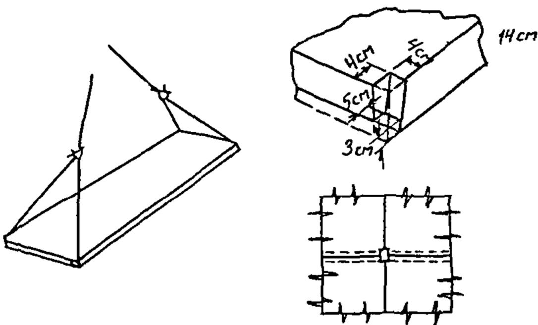
Рис. 3.2.3. Схемы строповки и монтажа покрытия
