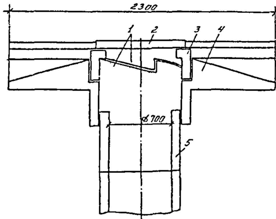
**Рис. 6.1.1. Конструкция регулируемого оголовка смотрового колодца:**
