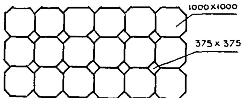
Рис. 4.1.1. Схема раскладки тротуарных плит
