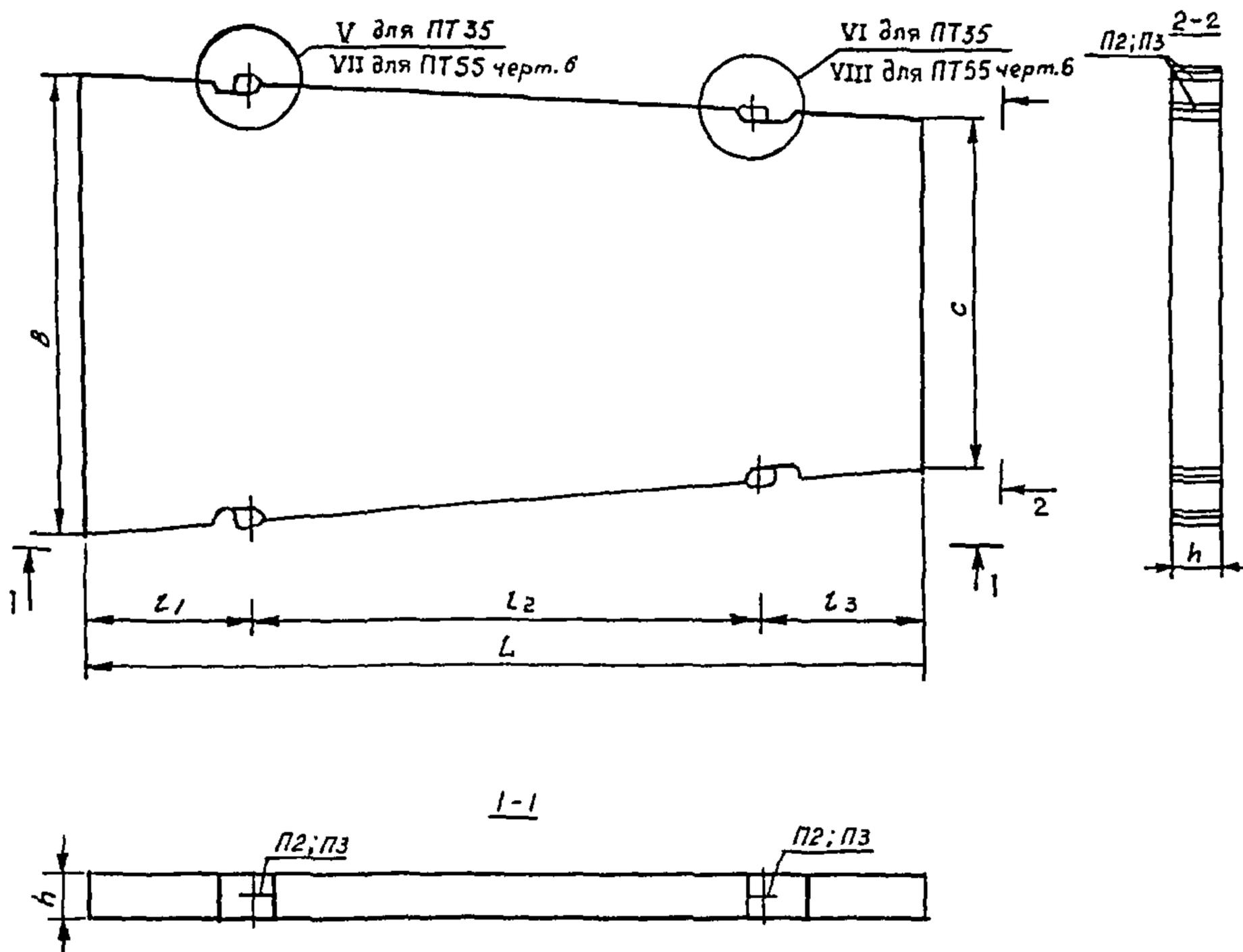
Рис. 3.1.3. Трапецеидальная плита
