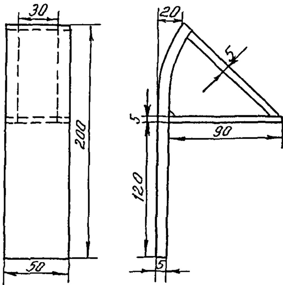
Рис. 3.2.2. Металлический шаблон для контроля ширины швов
