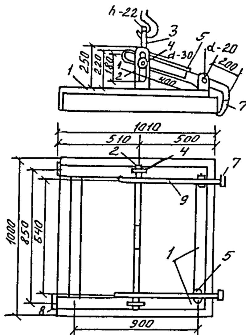
Рис. 4.2.1. Захват для укладки плит:
