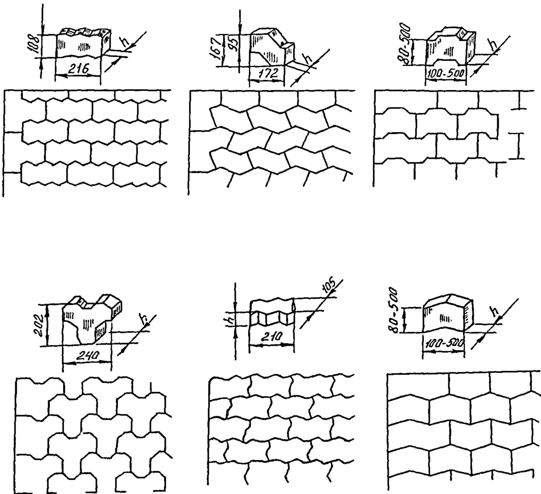
Рис. 4.1.2. Схемы раскладки фигурных элементов мощения
