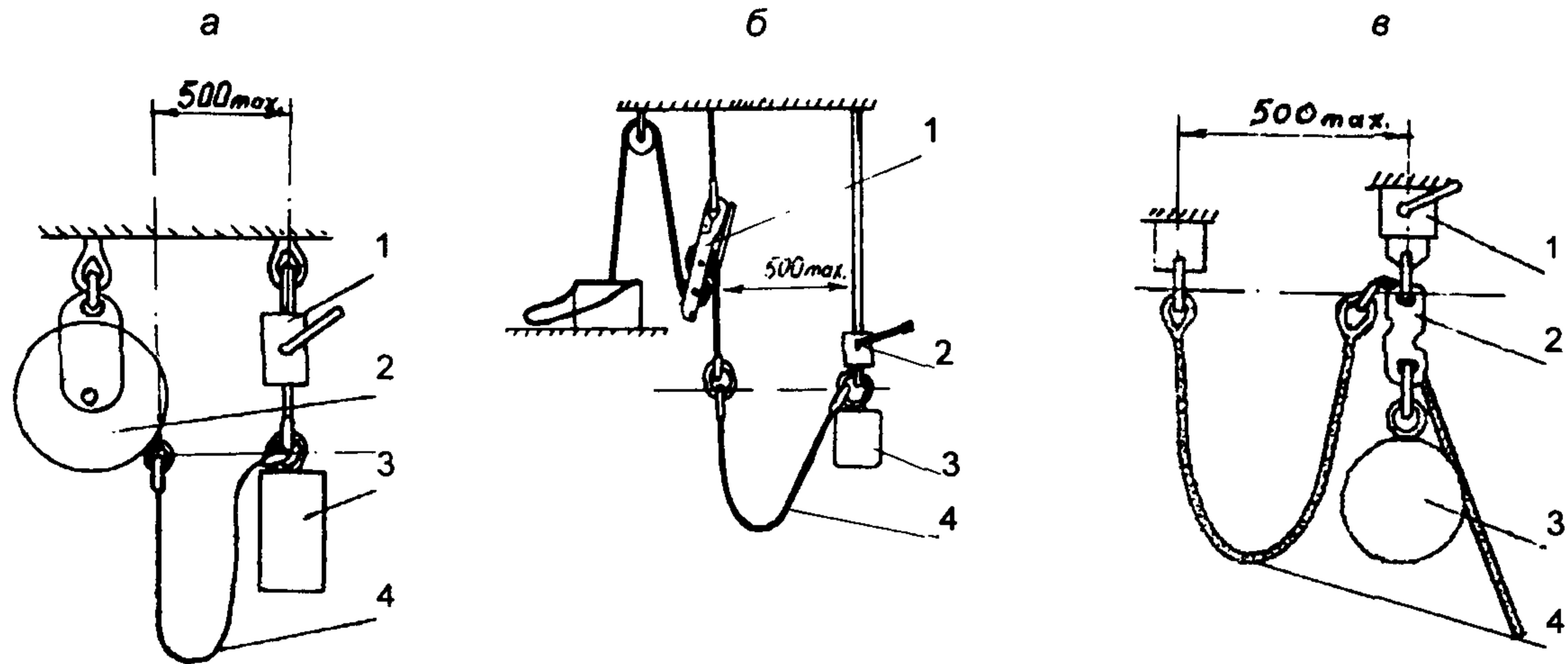
Рисунок 5. Схемы испытания УКСП на динамическую прочность:
