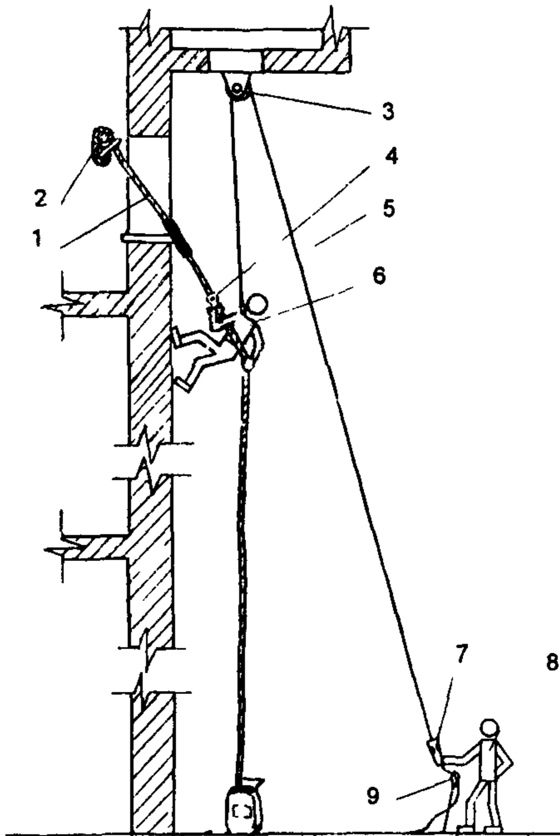
**Рисунок 4. Схема страховки при спуске испытателей на УКСП**
