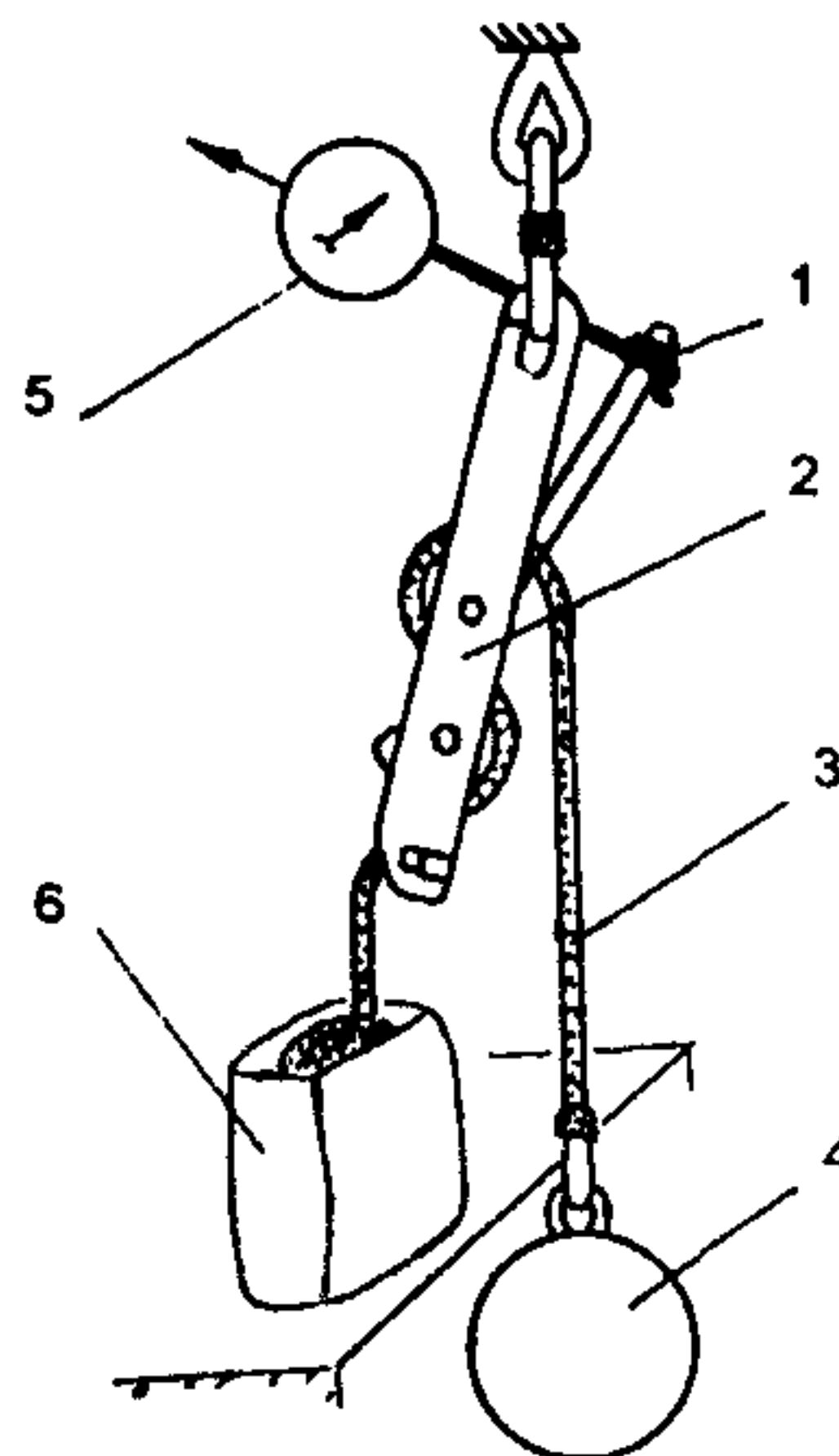
**Рисунок 1. Схема поверки величины тормозного усилия УКСПр**
