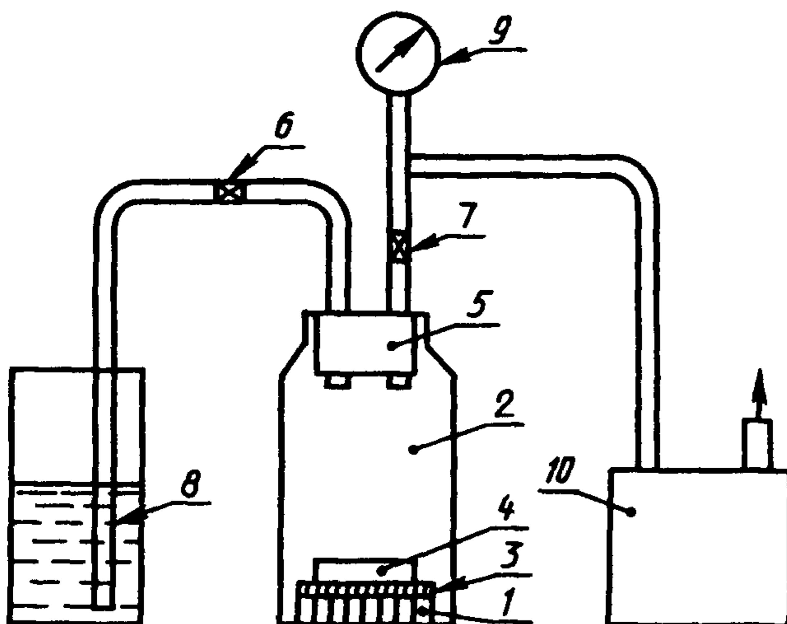
**1** — образцы древесины; **2** — пропиточный сосуд; **3** — сетка; **4** — противовсплыивание устройство; **5** — пробка; **6**, **7** — краны; **8** — сосуд с раствором испытуемого защитного средства; **9** — вакуумметр; **10** — вакуумный насос
