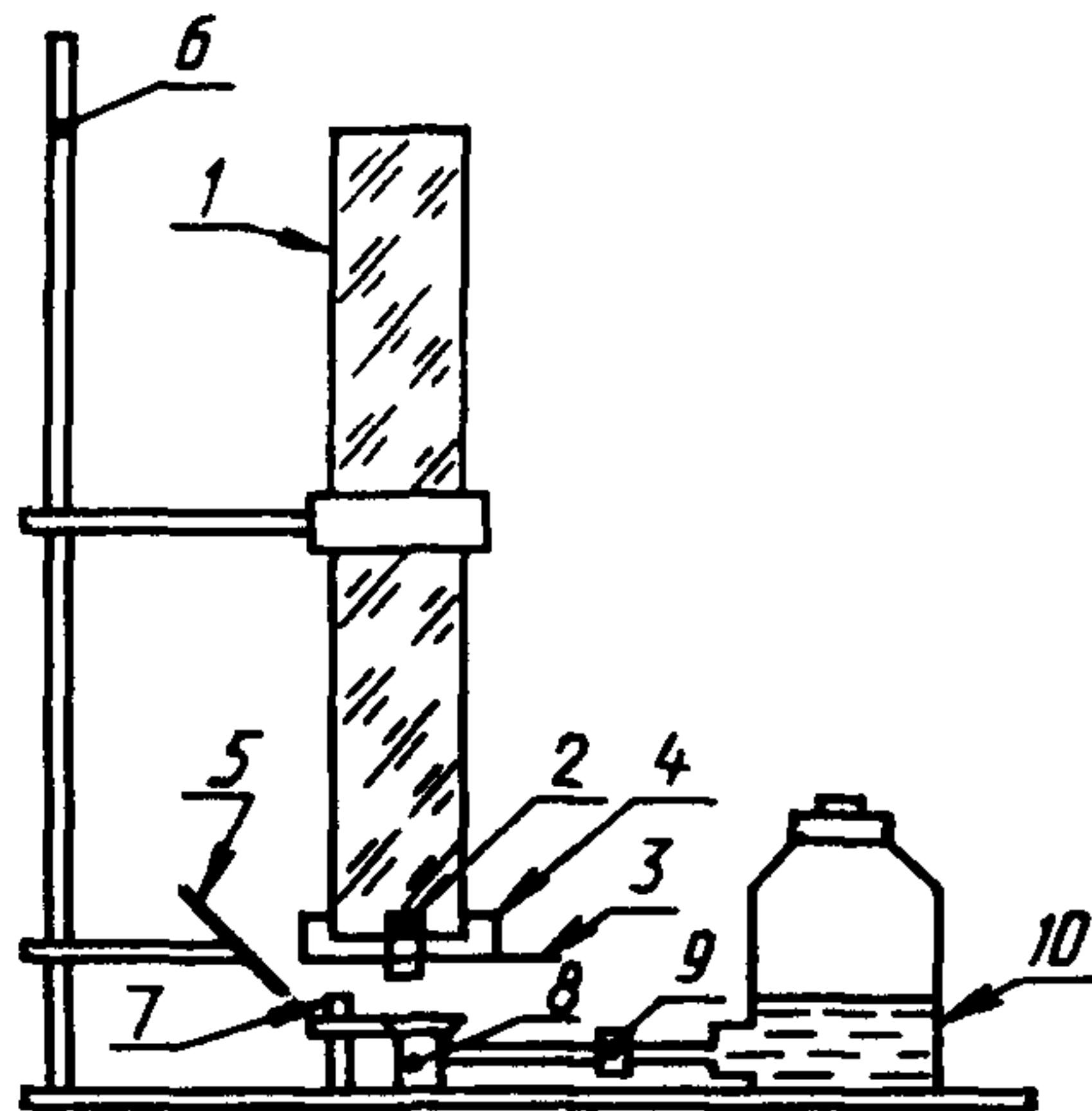
1 — труба из кварцевого стекла с внутренним диаметром 90 мм, толщиной стенки 5 мм и длиной 800 мм; 2 — образец древесины; 3 — игла для крепления образца; 4 — держатель иглы; 5 — зеркало; 6 — штатив; 7 — заслонка; 8 — устройство для поджигания; 9 — шланг с зажимом; 10 — емкость для спирта
