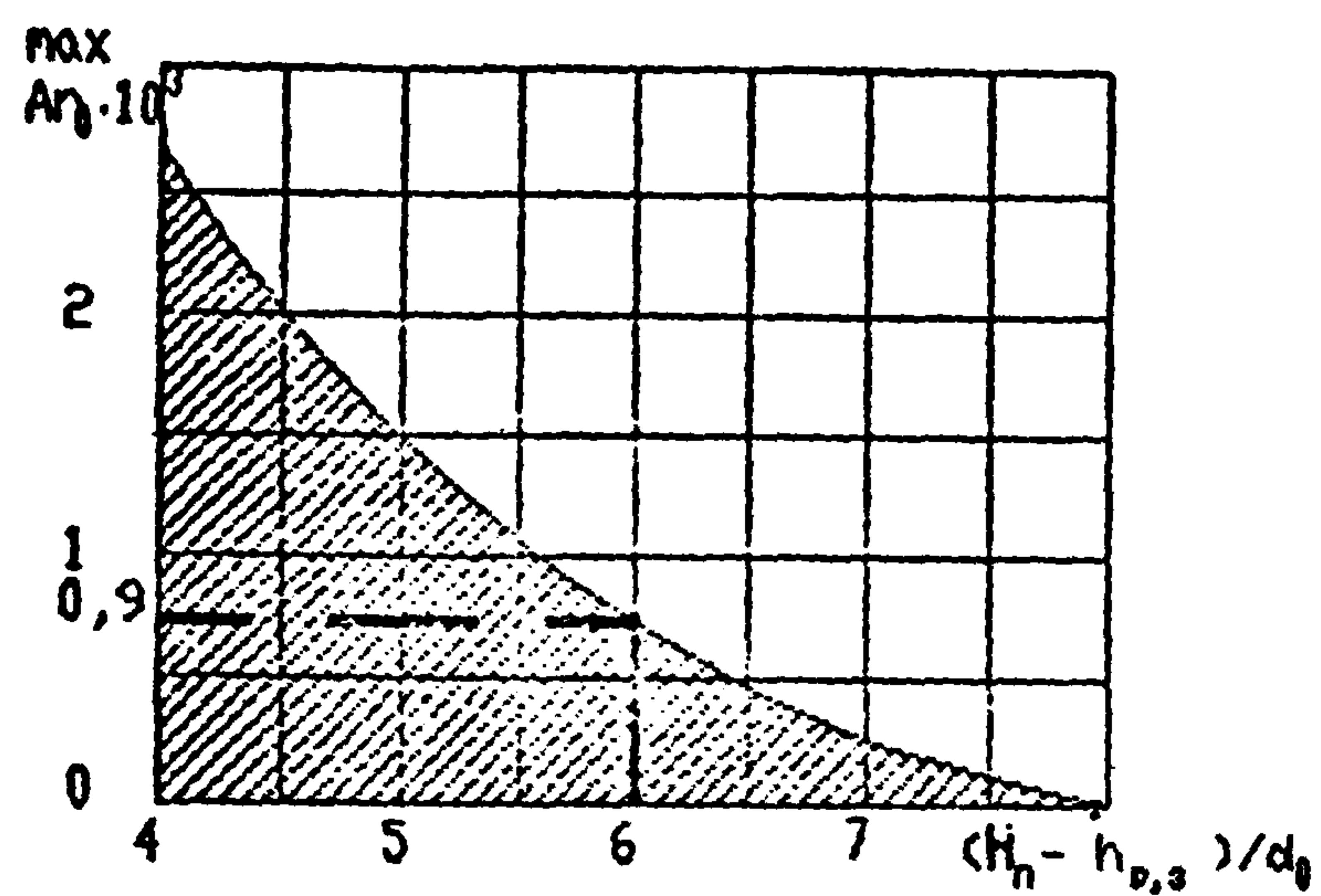
Рис. 4. ПРЕДЕЛЬНОЕ ЗНАЧЕНИЕ КРИТЕРИЯ АРХИМЕДА  $Ar_{cr}$ , ПРИ КОТОРОМ СОХРАНЯЕТСЯ РАСЧЕТНАЯ СХЕМА РАЗБИТИЯ СТРУИ
