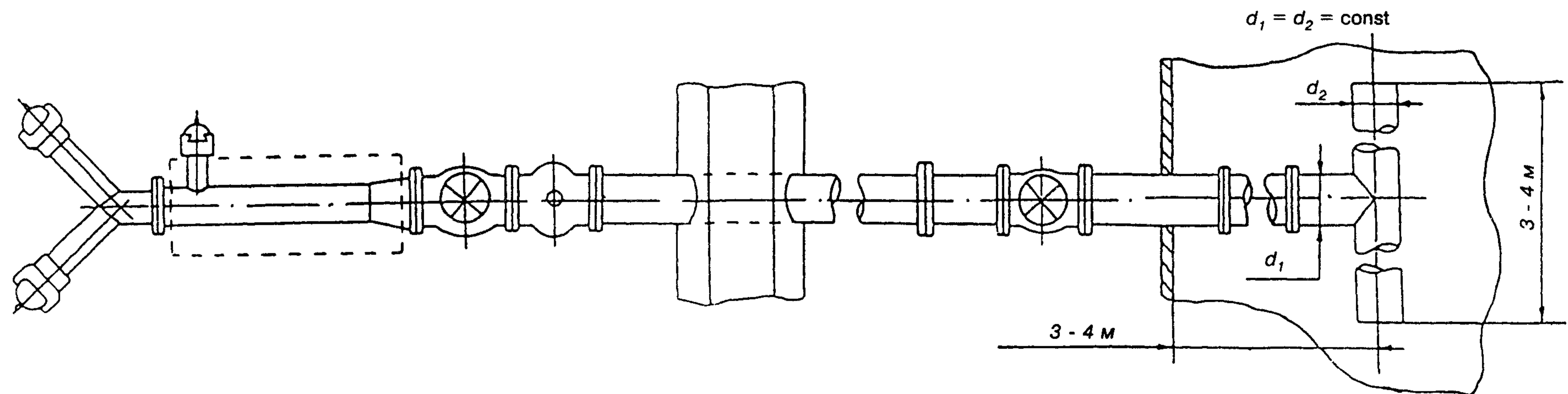
**Рисунок 2 — Принципиальная схема тушения пожаров горючих жидкостей в резервуарах подслойным способом от передвижной пожарной техники**
