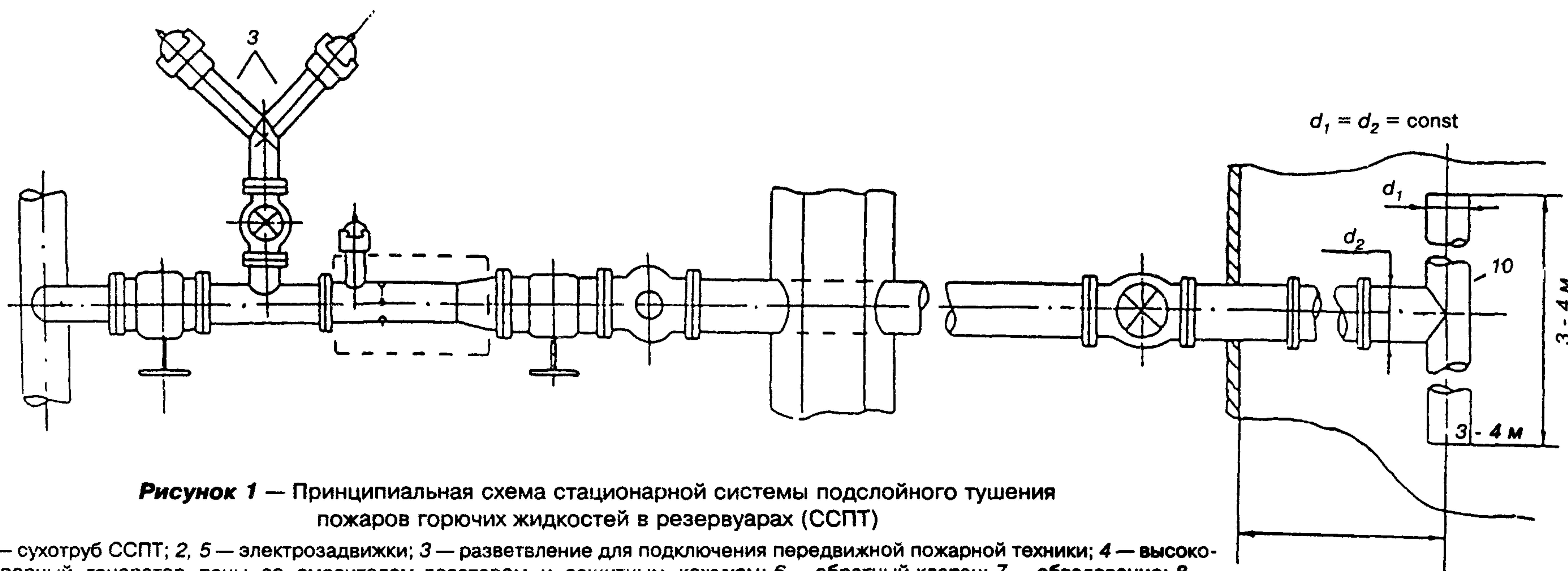
**Рисунок 1 —** Принципиальная схема стационарной системы подслойного тушения пожаров горючих жидкостей в резервуарах (ССПТ)
