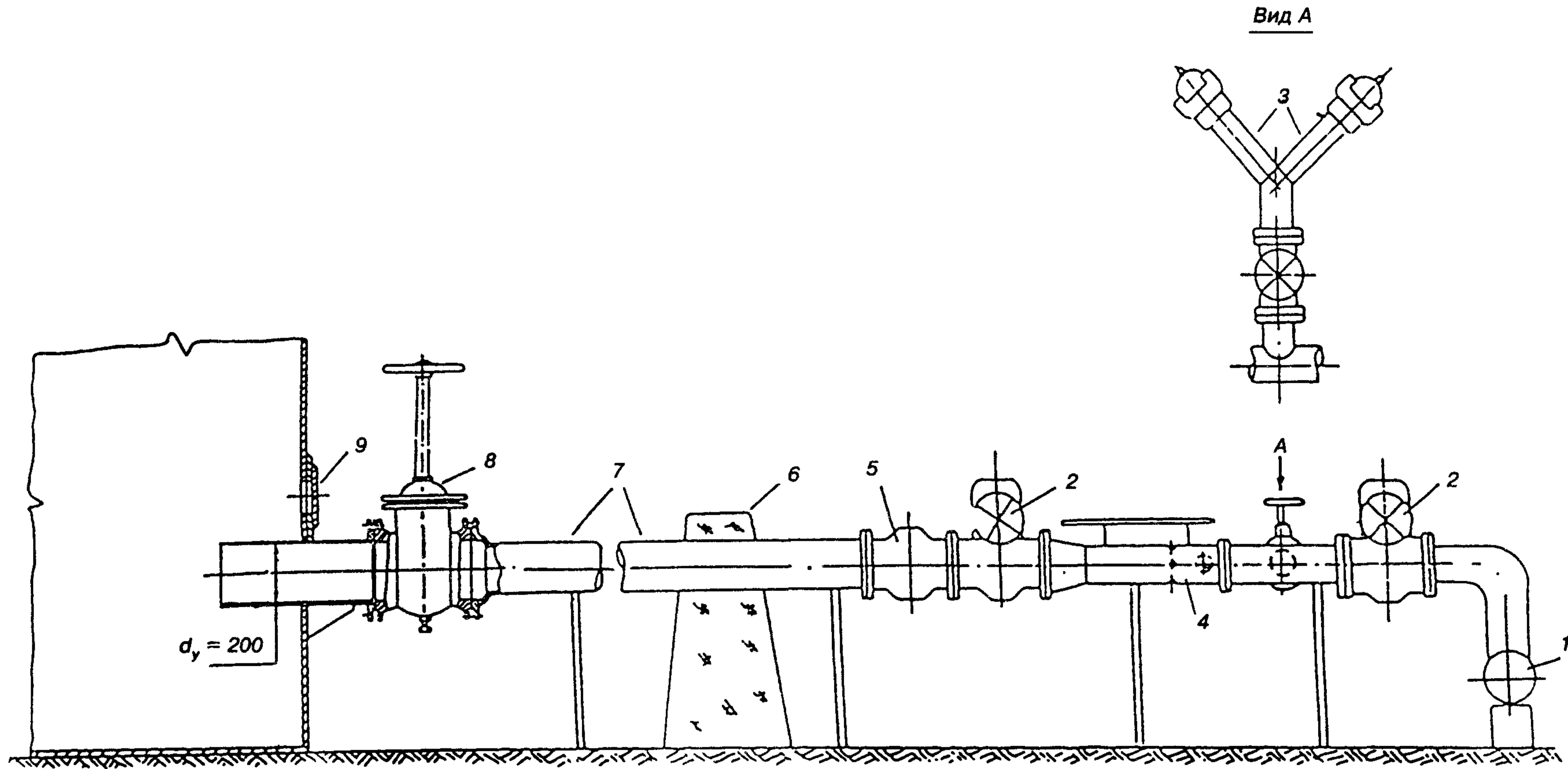
**Рисунок 3 —** Принципиальная схема подачи пены в резервуар, оснащенный УППС
