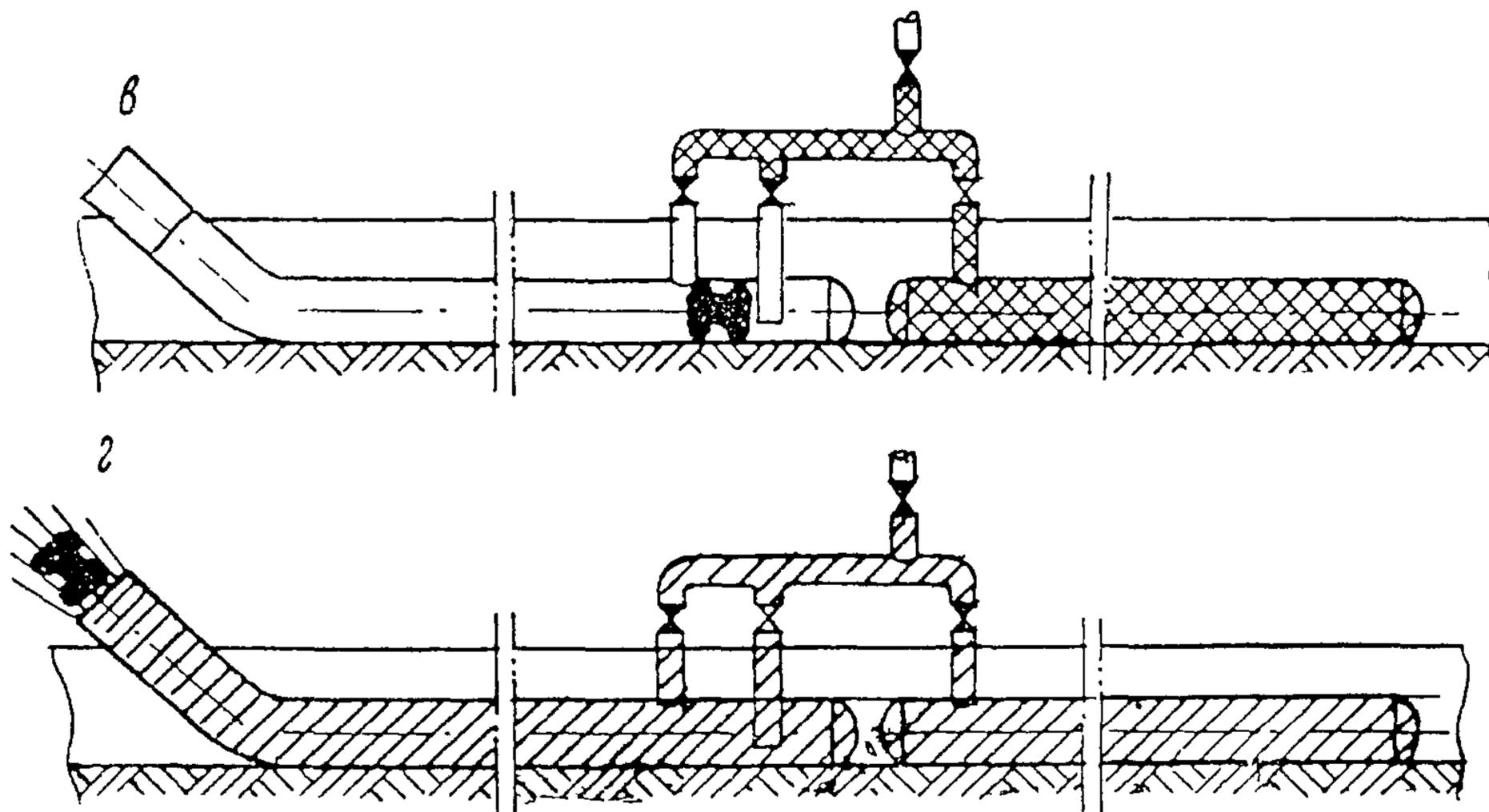
Рис.3. Принципиальная схема продувки трубопроводов воздухом:
