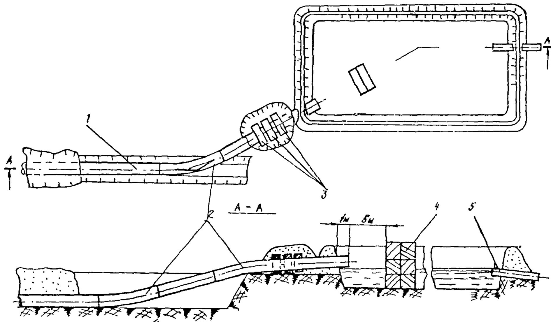
Рис. 13. Схема крепления продувочного патрубка при удалении воды из трубопровода после гидравлического испытания:
