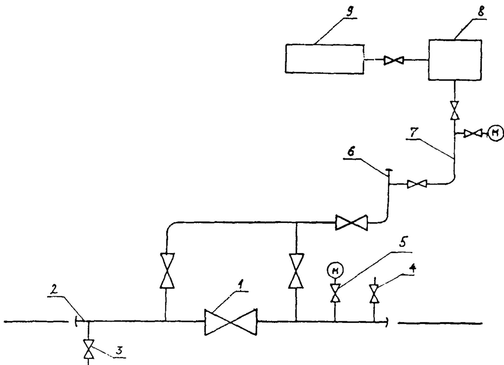
Рис. I. Принципиальная схема предварительного гидравлического испытания кранового узла:
