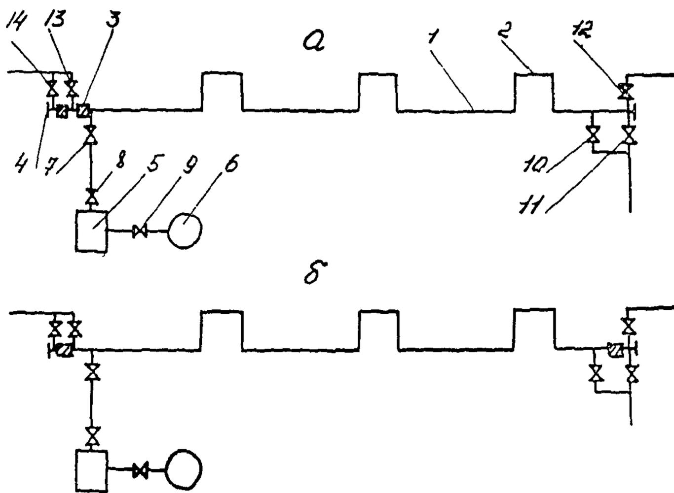
Рис.14. Принципиальная схема испытания трубопровода подогретой водой:
