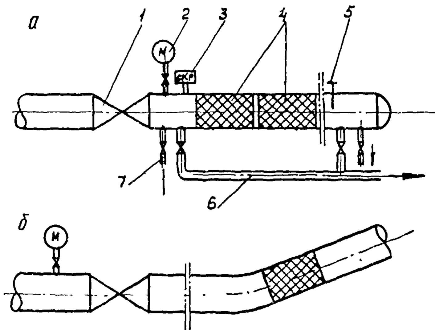
Рис.17. Принципиальные схемы узлов приема поршней-разделителей, монтируемых на газопроводах:
