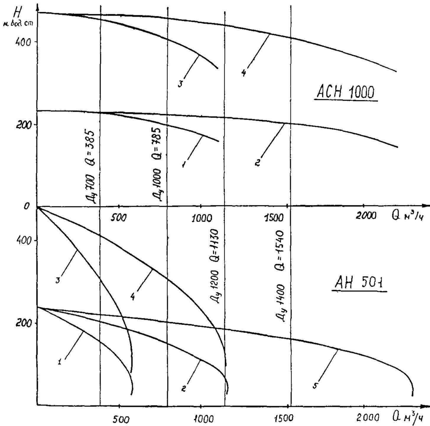
Рис.2. Характеристики дополнительных агрегатов:
