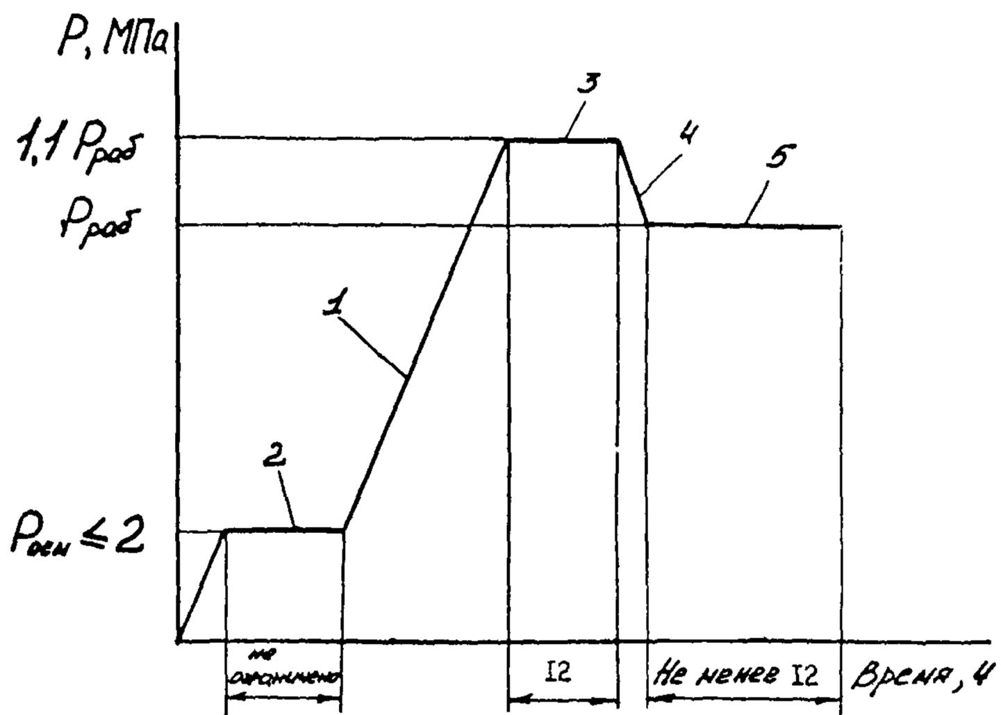
Рис. II. График изменения давления в трубопроводе при пневматическом испытании:
