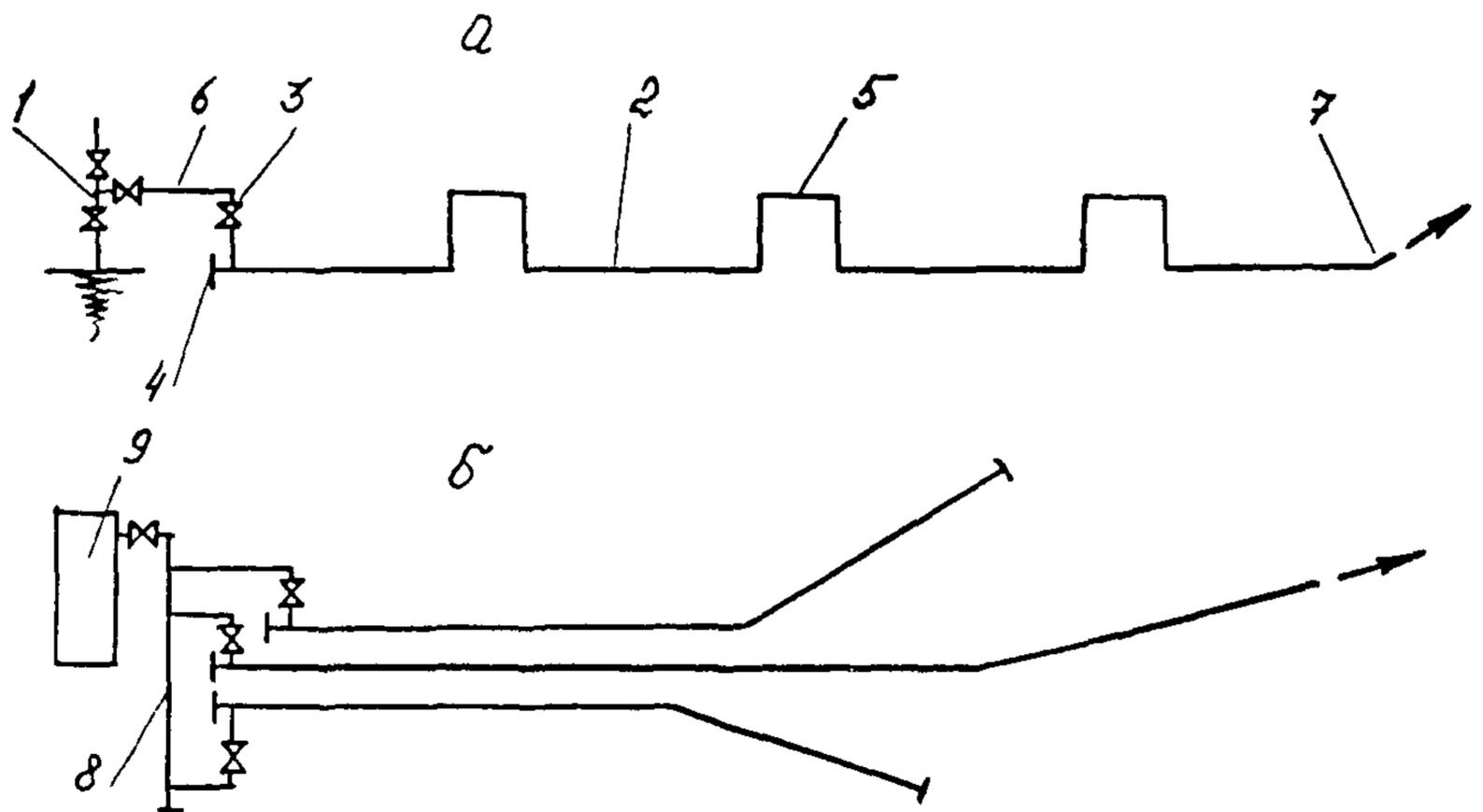
Рис.6. Принципиальная схема продувки промышленного трубопровода:
