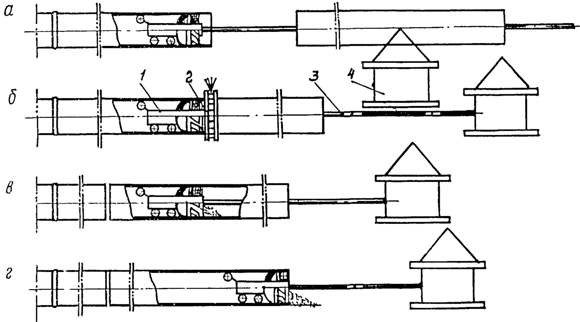
Рис.8. Принципиальная схема очистки полости трубопроводов в процессе их сборки в нитку с наружным центратором:
