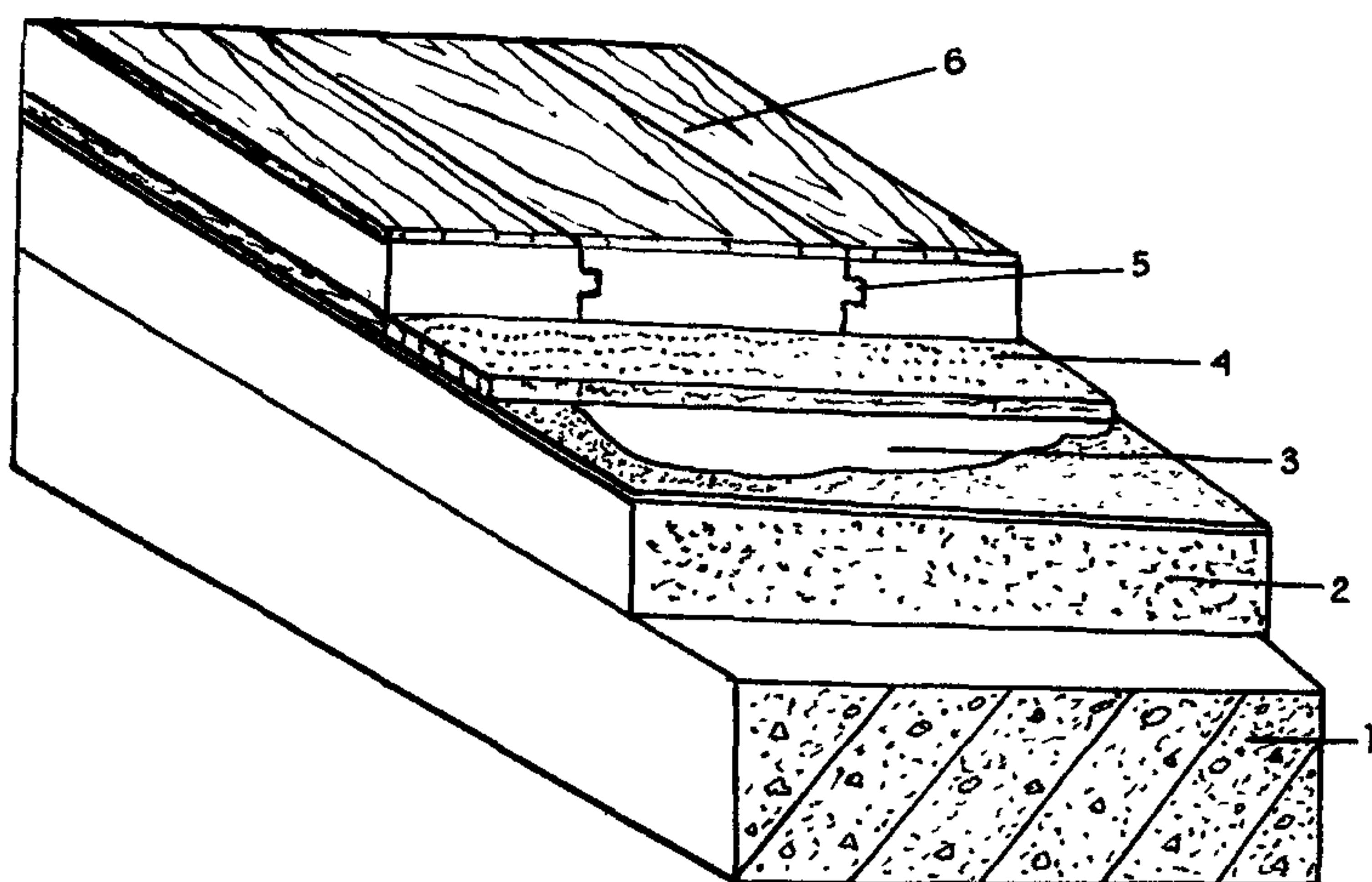
**Рис.2. Конструкция пола с покрытием из ламинат-паркета:**
