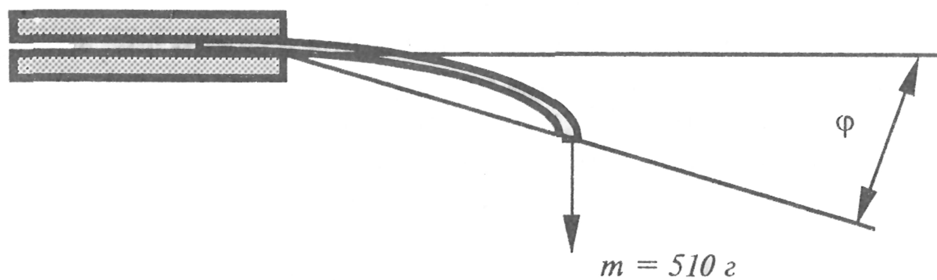
Рис. 3. Схема измерения угла сгиба
