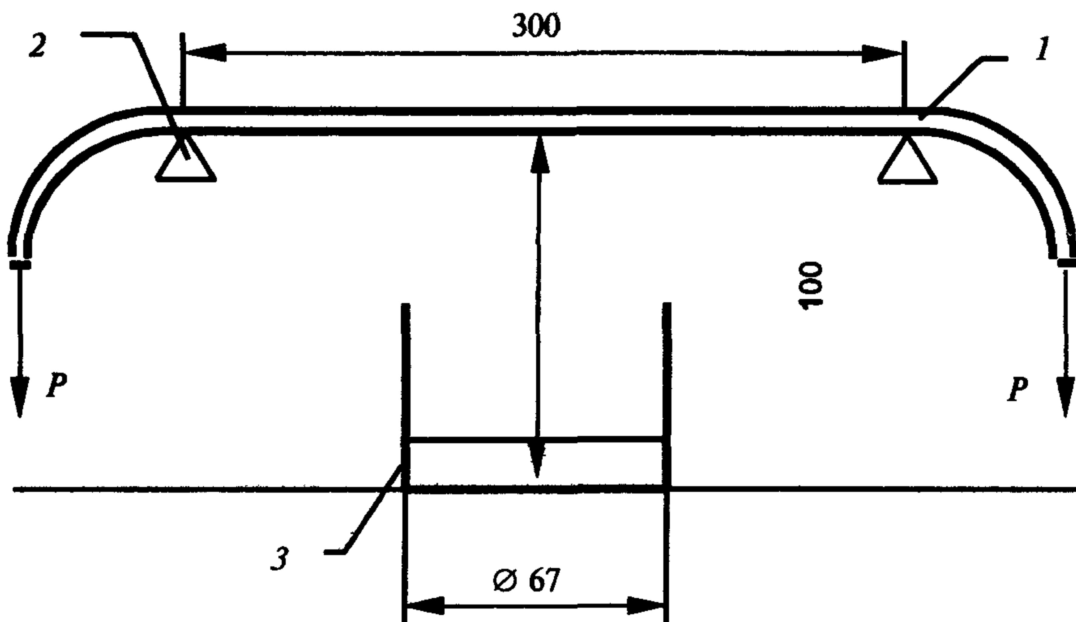
Рис. 4. Приспособление для огневых испытаний фала:
