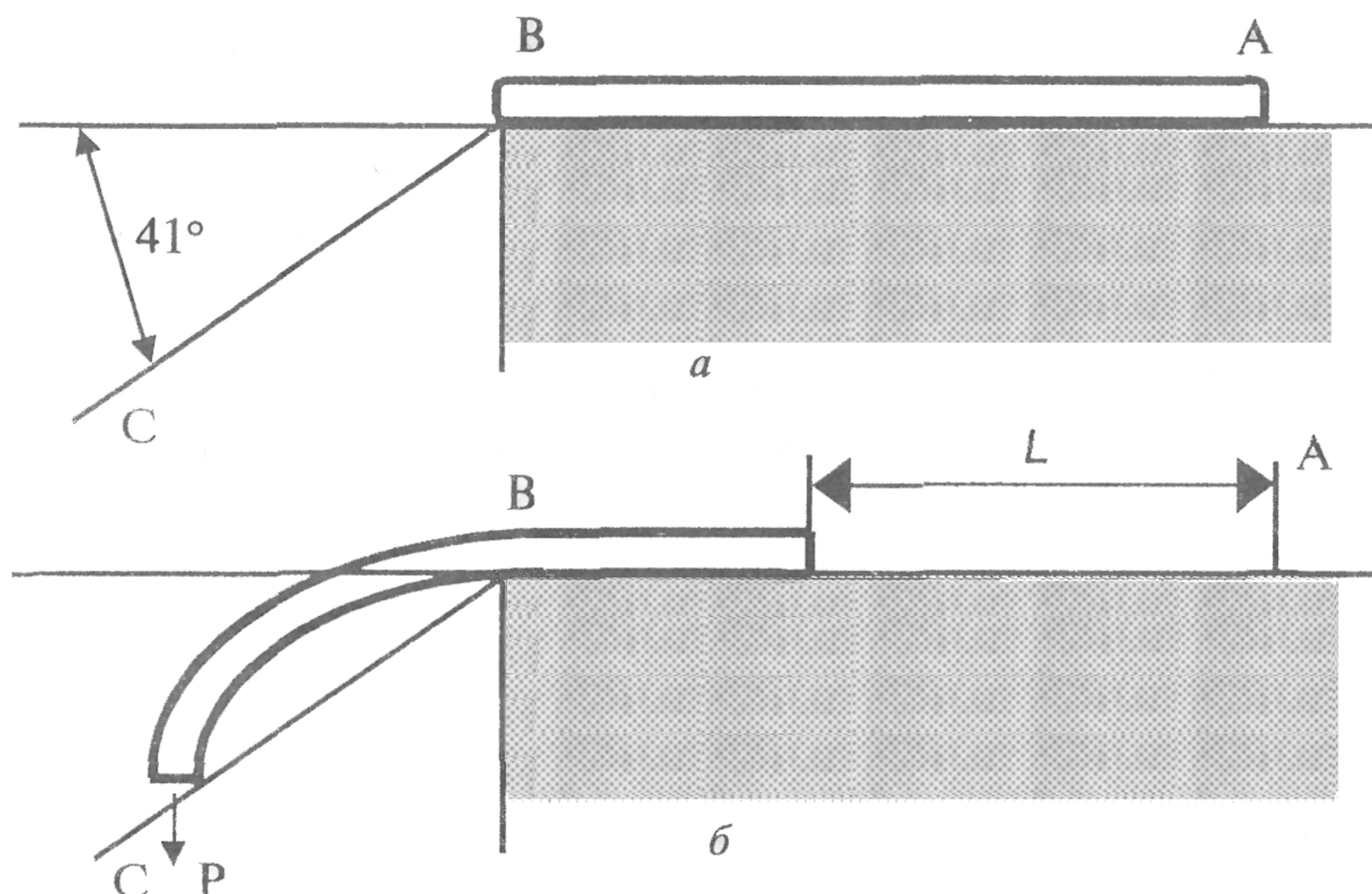
Рис. 5. Схема определения жесткости фала
