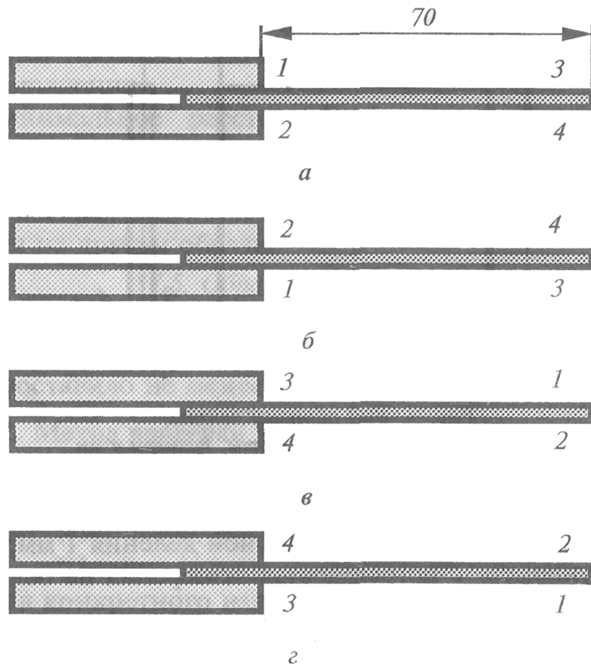
Рис. 2. Положения зажима образца ленты. Размеры в мм
