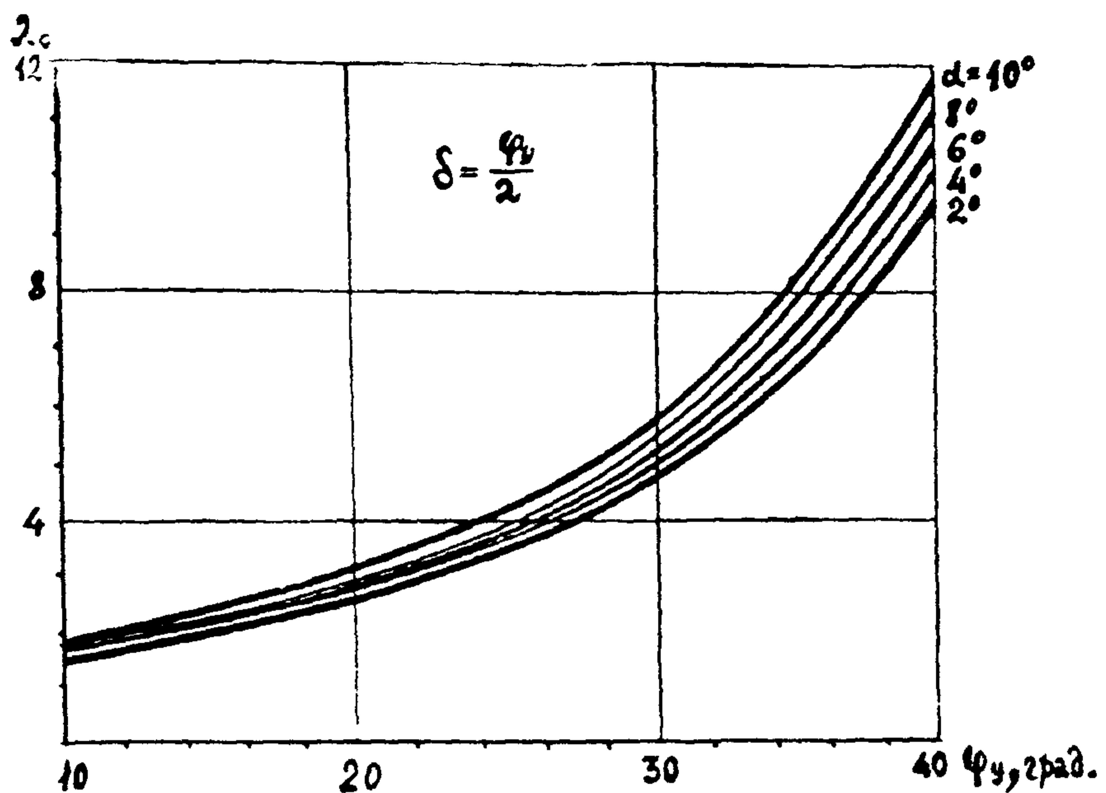
Рис 3 Графики для определения коэффициента  $\lambda_0$  для глинистых грунтов в зависимости от угла внутреннего трения грунта  $\phi_y$  и угла наклона к вертикали надвигающейся на грунт грани  $\alpha$  при угле трения грунта о бетонную поверхность  $\delta=0,5\phi_y$
