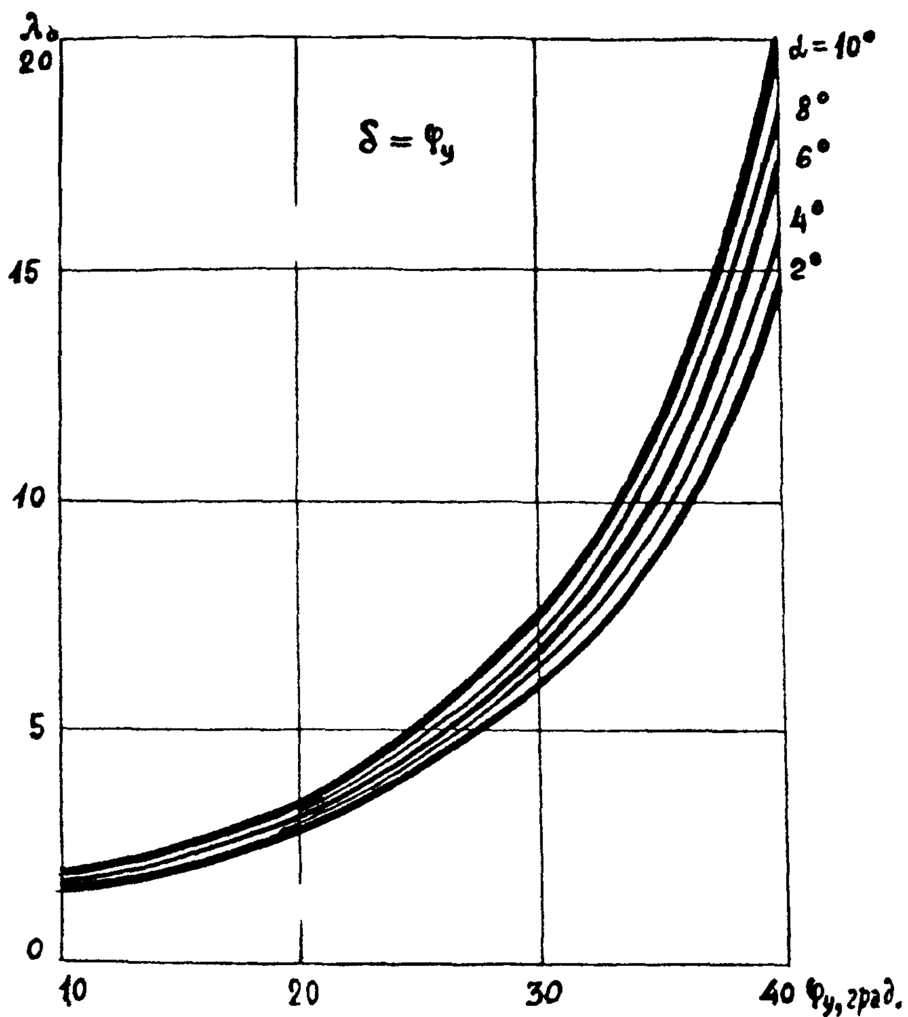
Рис. 2. Графики для определения коэффициента  $\lambda_0$  для песчаных грунтов в зависимости от угла внутреннего трения грунта  $\varphi_y$  и угла наклона к вертикали надвигающейся на грунт грани  $\alpha$  при угле трения грунта о бетонную поверхность  $\delta = \varphi_y$
