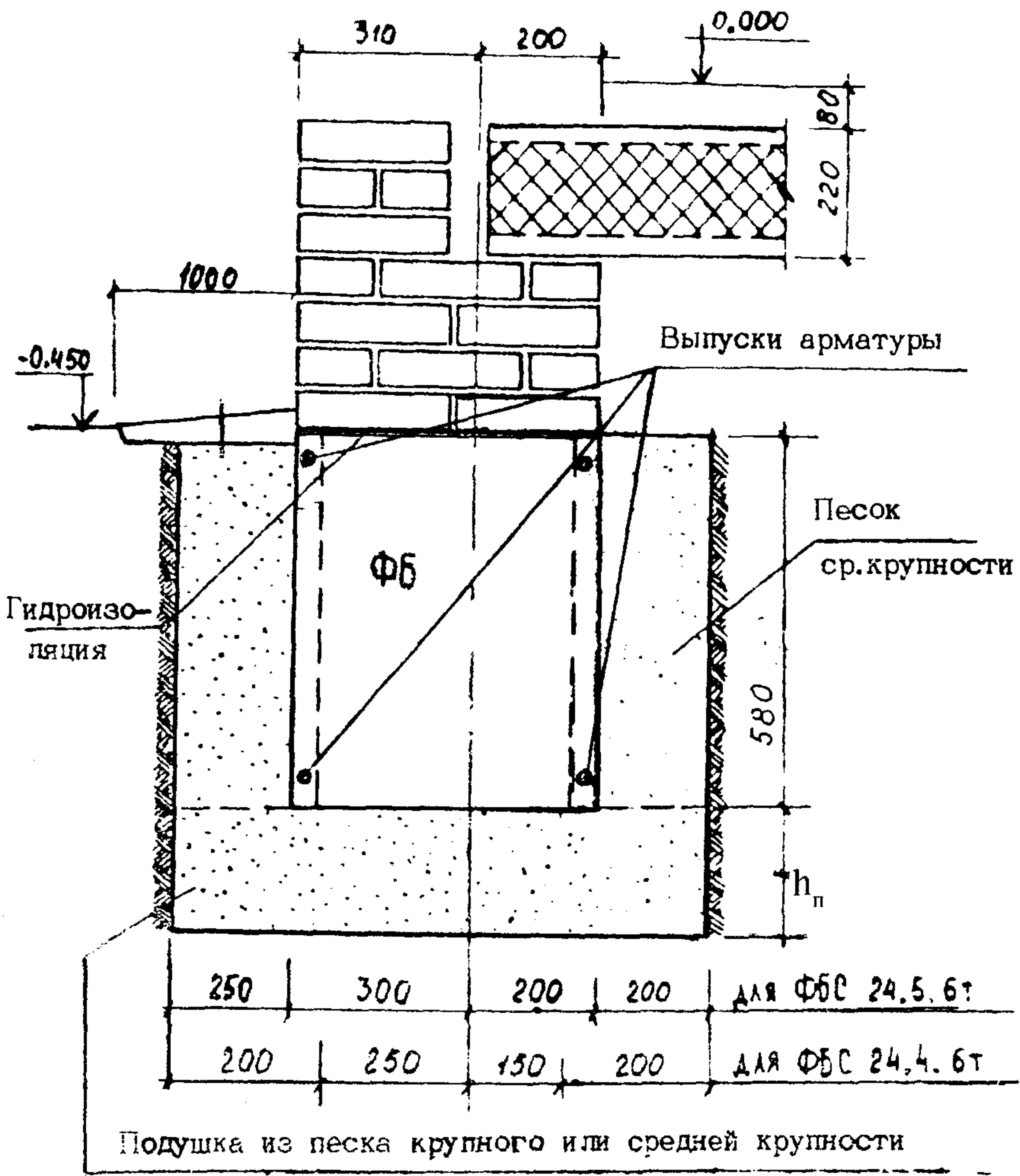
Рис. 4. Вариант мелкозаглубленного фундамента под кирпичный дом при грунтах с  $\varepsilon_{fh} \geq 0,10$ .
