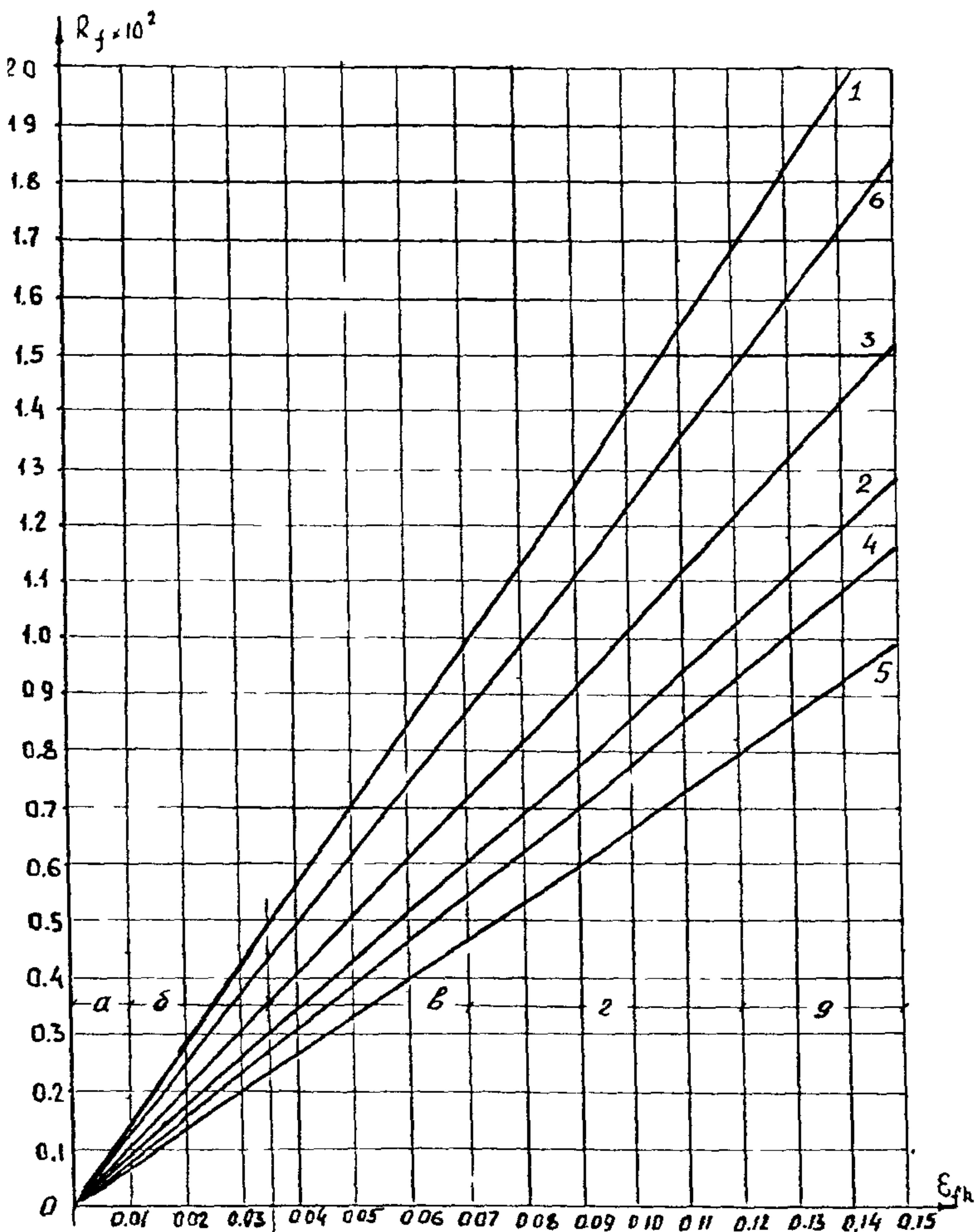
Рис.2.1. Зависимость относительной деформации пучения  $e_{fh}$  от параметра  $R_f$ :
