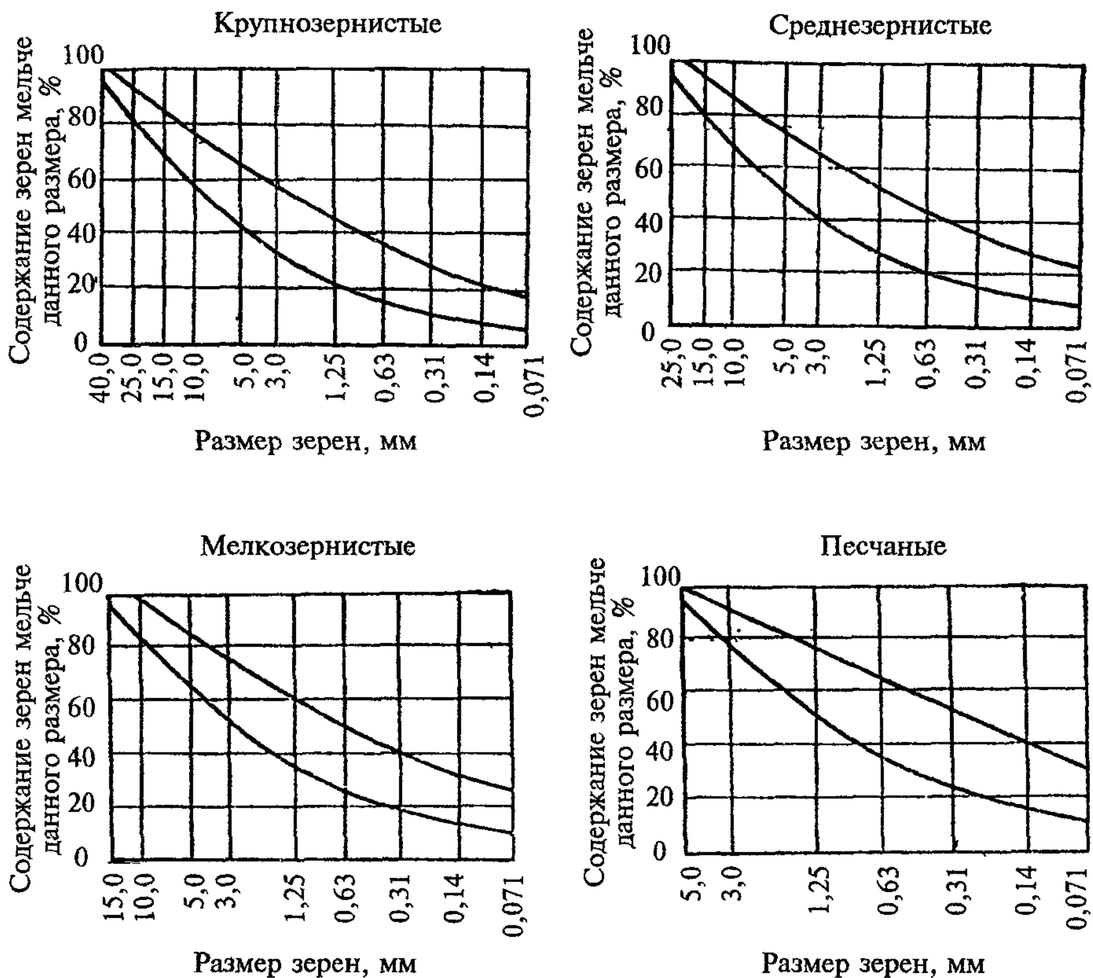
**Рис. 1. Кривые зерновых составов плотных смесей непрерывной гранулометрии**
