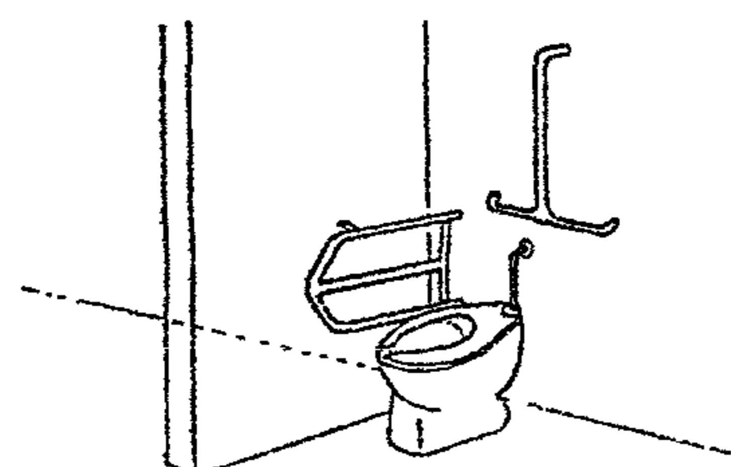
1. Поручень - труба из нержавеющей или хромированной стали или алюминия диаметром 3,2 см(1,25 дюйма)
