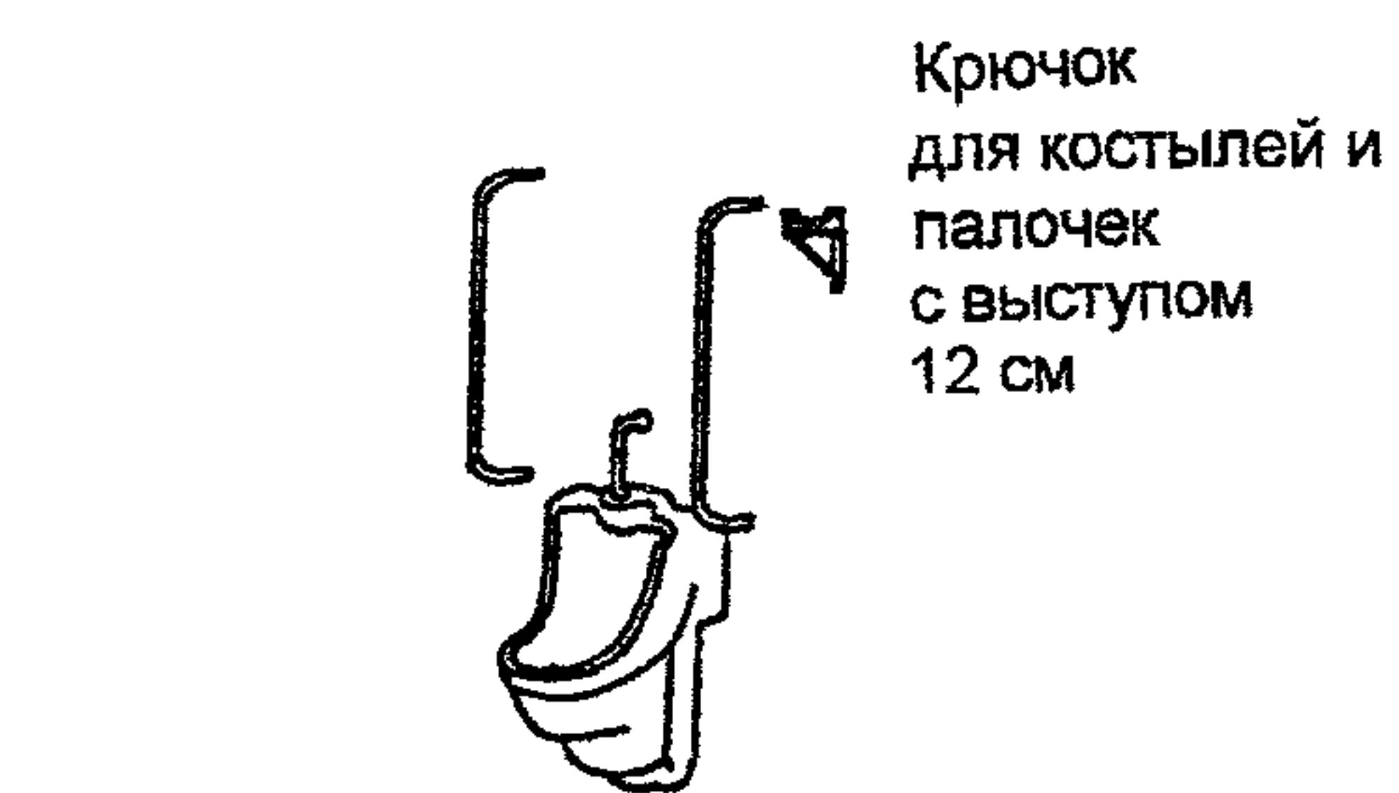
3. Кнопка промывки прибора должна иметь ручное или автоматическое управление, располагаться не выше 120 см от пола и легко управляться запястьем руки (с силой, не превышающей 20 кгм/сек<sup>2</sup>)
