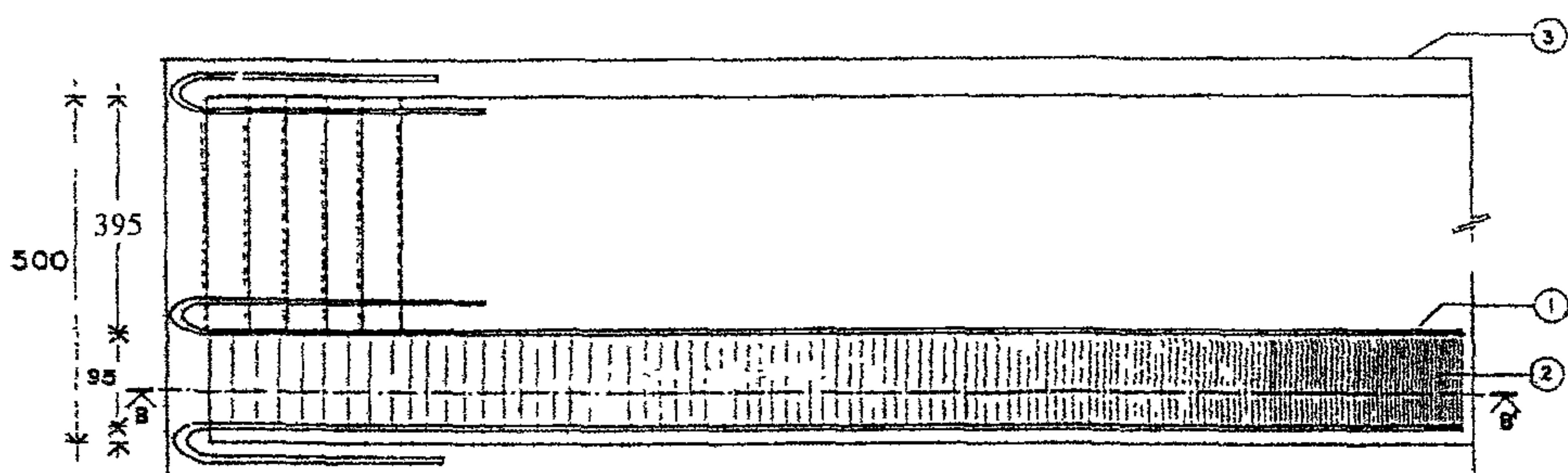
1. Перила в виде трубки из нержавеющей стали или алюминия 3,2 см (1,25 дюйма) в диаметре, калибр 16.
