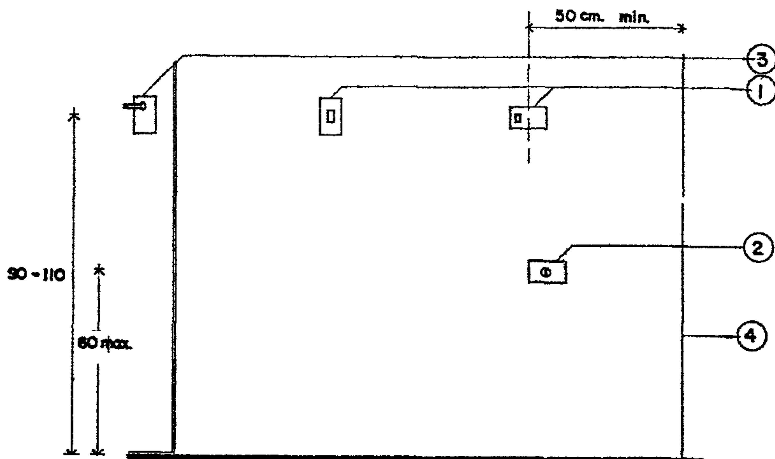
1. Выключатель со светящимся обозначением.
