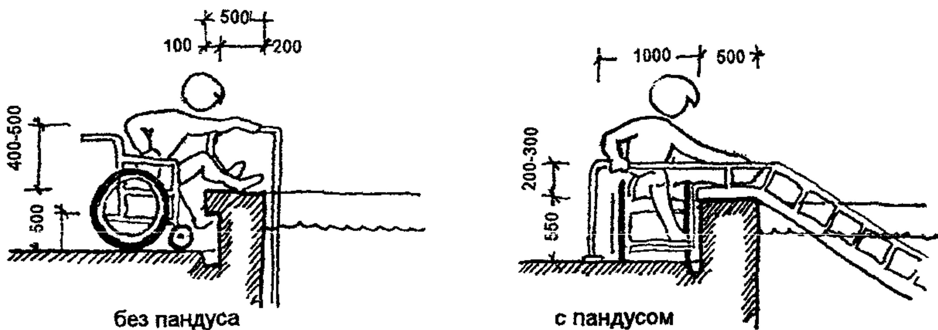
РИС 7.4 ПРИМЕРЫ РАЗЛИЧНЫХ ПРИСПОСОБЛЕНИЙ ДЛЯ ВХОДА ИНВАЛИДОВ В БАССЕЙН
