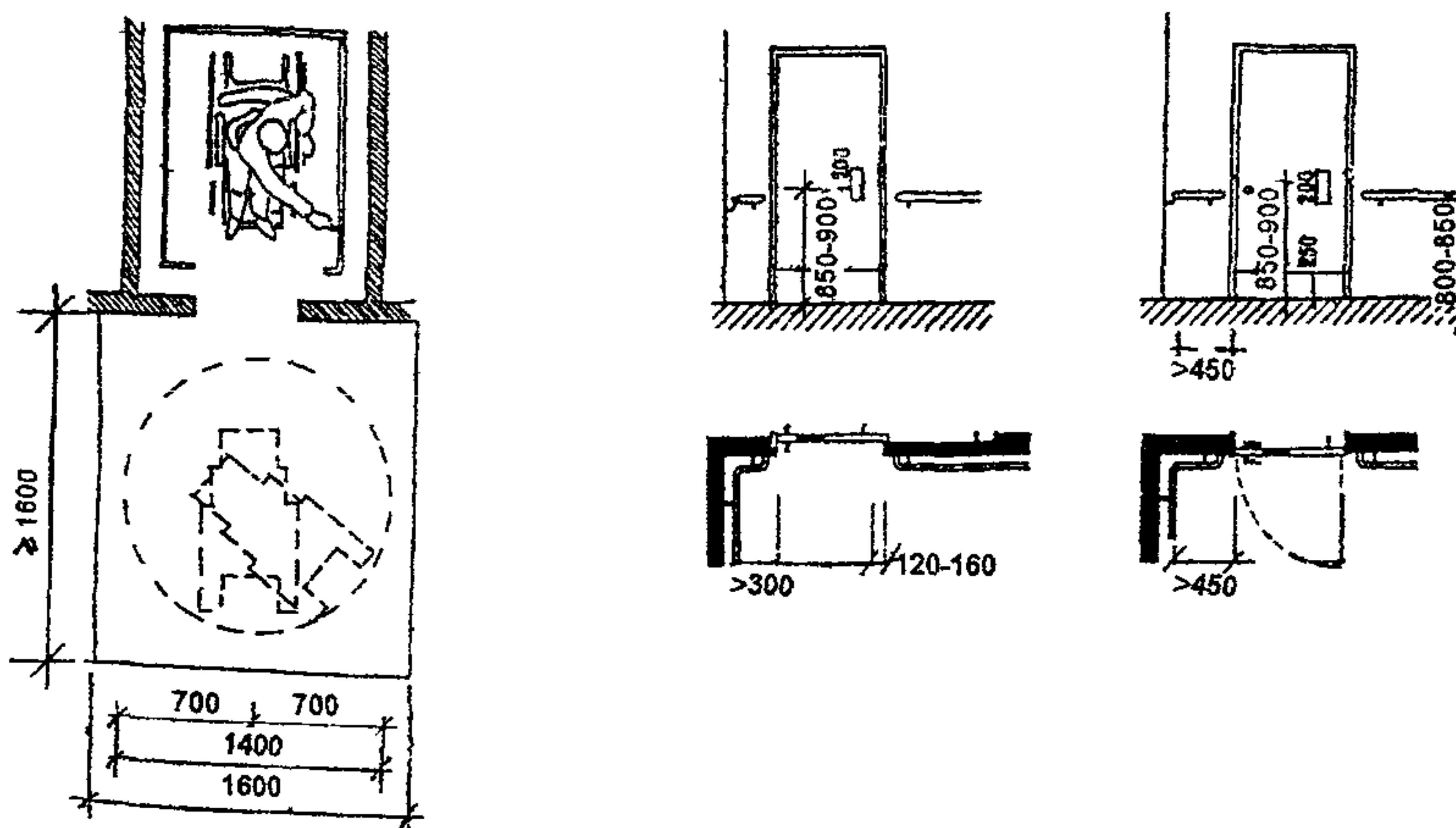
РИС.37 ГАБАРИТНЫЕ СХЕМЫ ПАНДУСОВ, ПОВОРОТОВ В КОРИДОРАХ,
