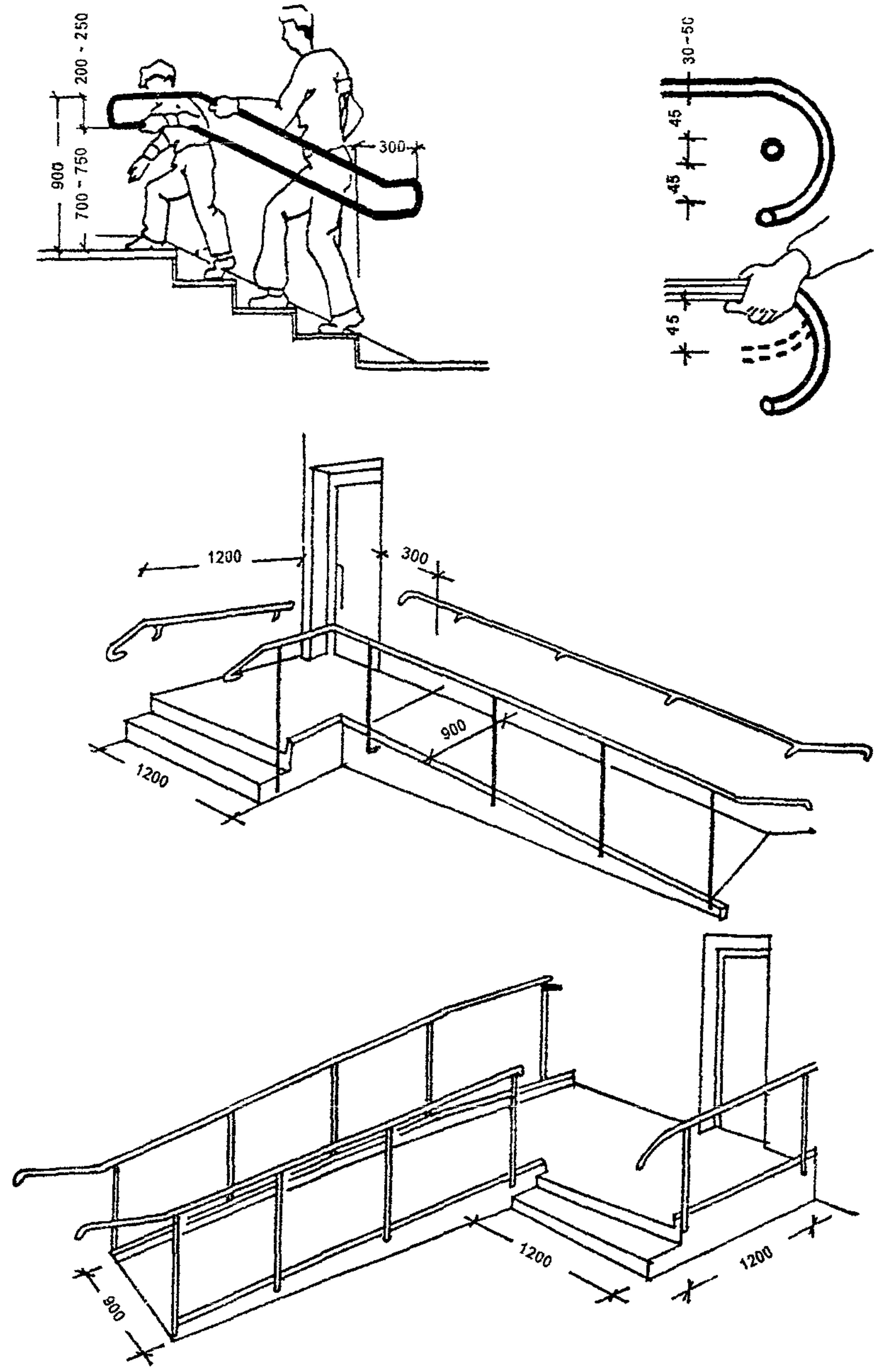
РИС. 3.11. ПРИМЕРЫ УСТРОЙСТВА ВХОДНЫХ ЛЕСТНИЦ И ПАНДУСОВ, РАСЧИТАННЫХ НА ИНВАЛИДОВ
