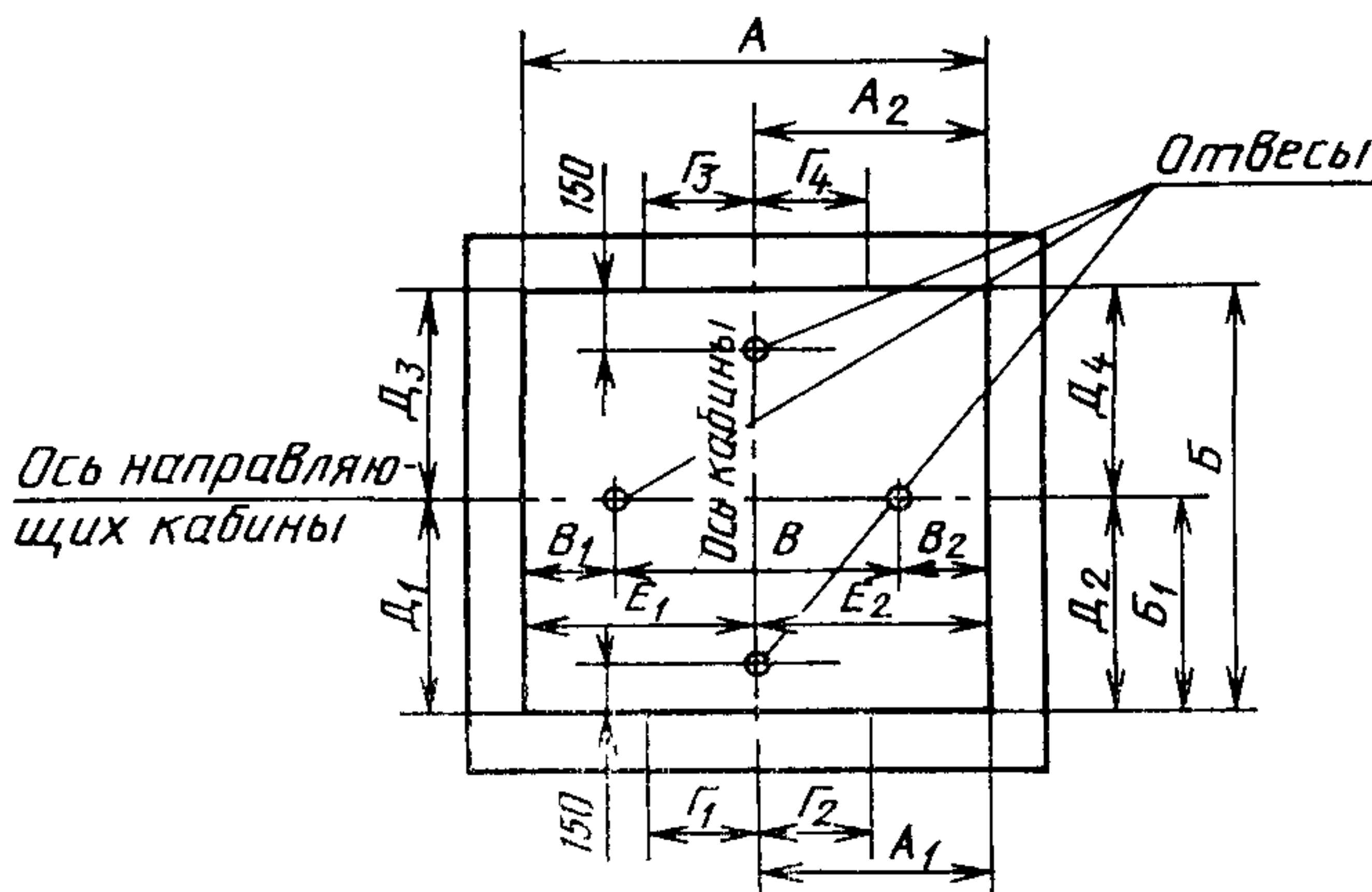
$A, A_1, B, B_1, V$ —размеры, определяемые монтажным (установочным) чертежом. Размер  $B$  равен расстоянию между направляющими кабины минус 50 мм;  $A_2, G_3, G_4$ —размеры для лифта с проходной кабиной;  $E_1, E_2$ —размеры для лифта с раздвижными дверями шахты
