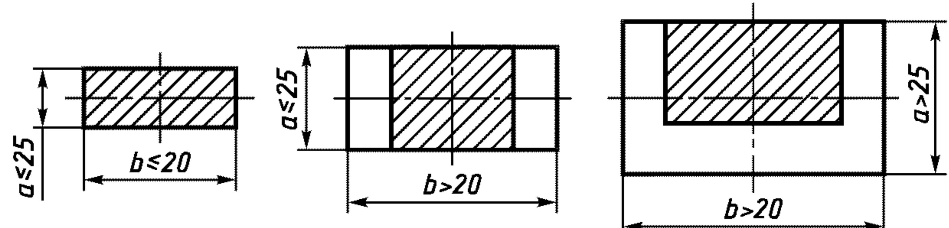
Рисунок Д.3 — Схемы отбора проб от проката прямоугольного сечения
