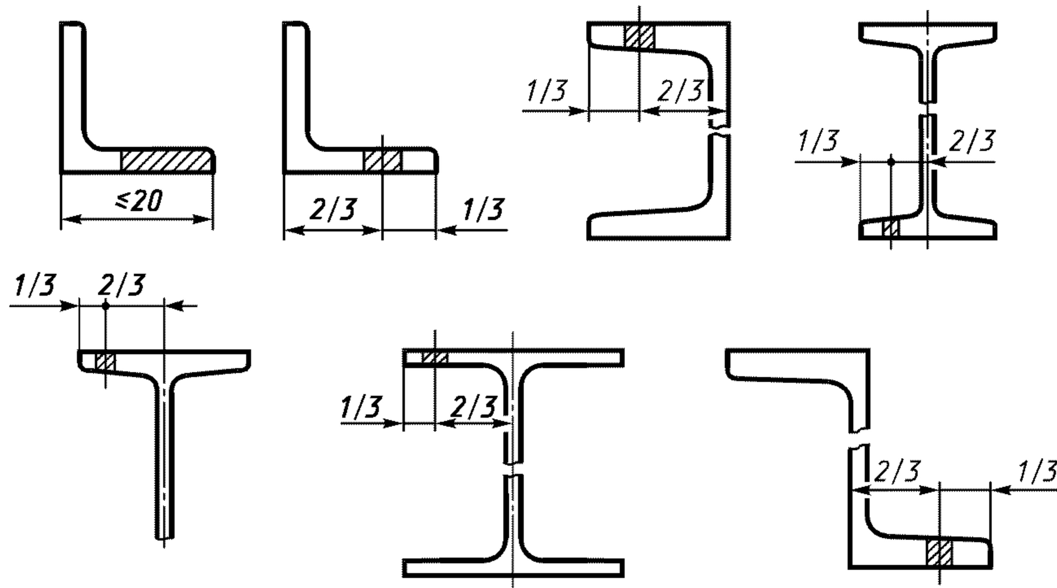
\* У неравнополочных уголков отбор проб производят из большей полки.
