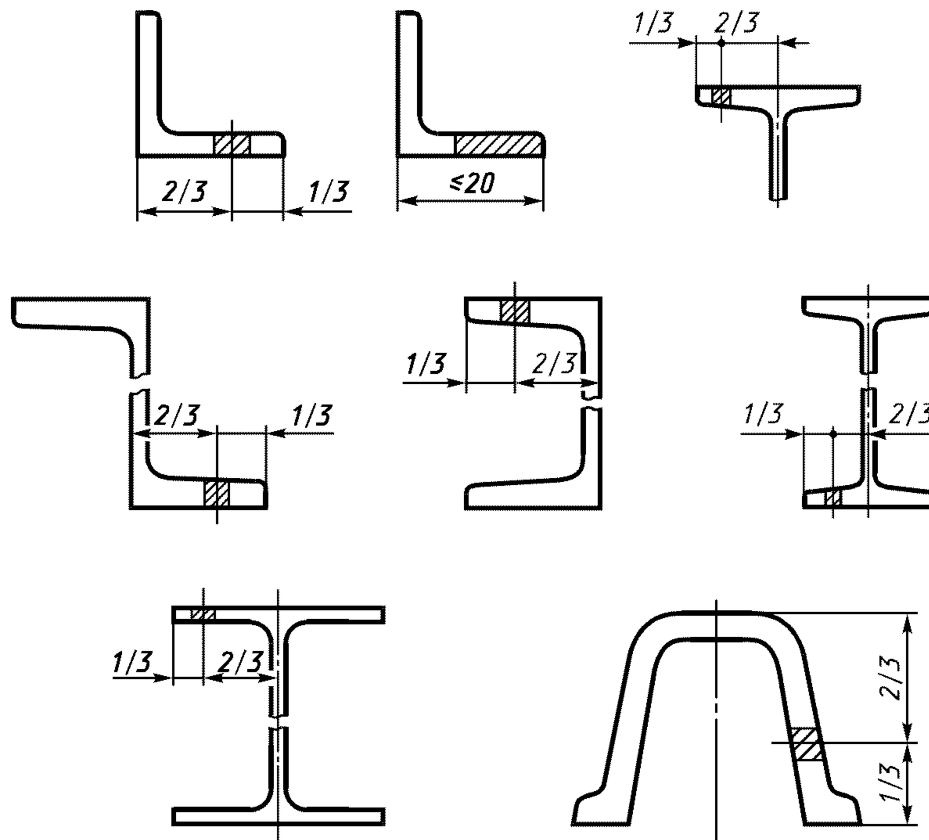
\* У неравнополочных уголков заготовка вырезается из большей полки.
