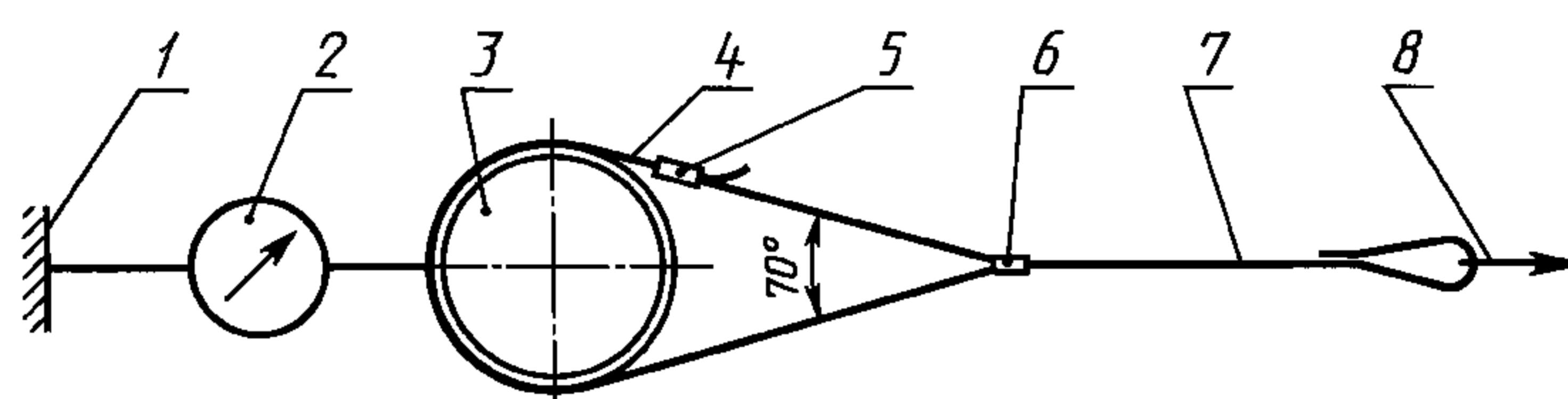
Рисунок 7 — Схема испытания пояса в целом статической нагрузкой
