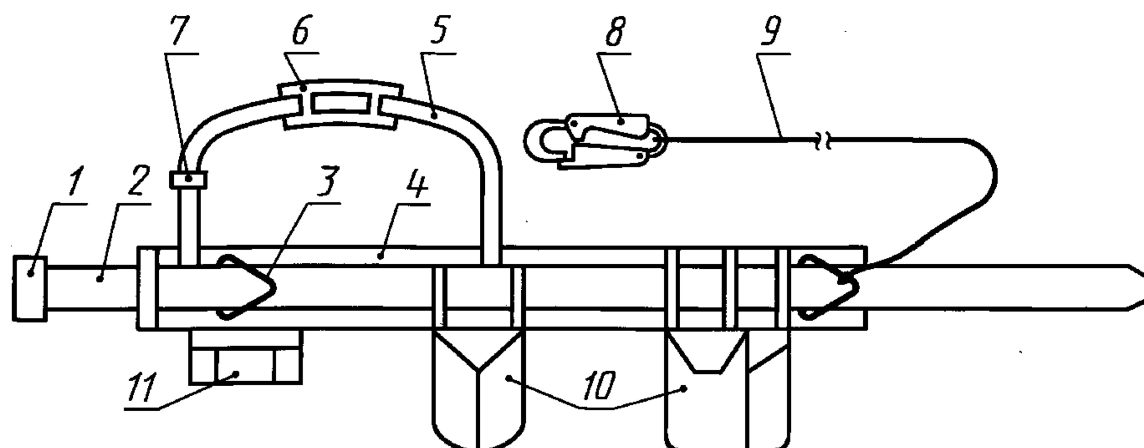
Рисунок 2 — Безлямочный пояс , тип Б
