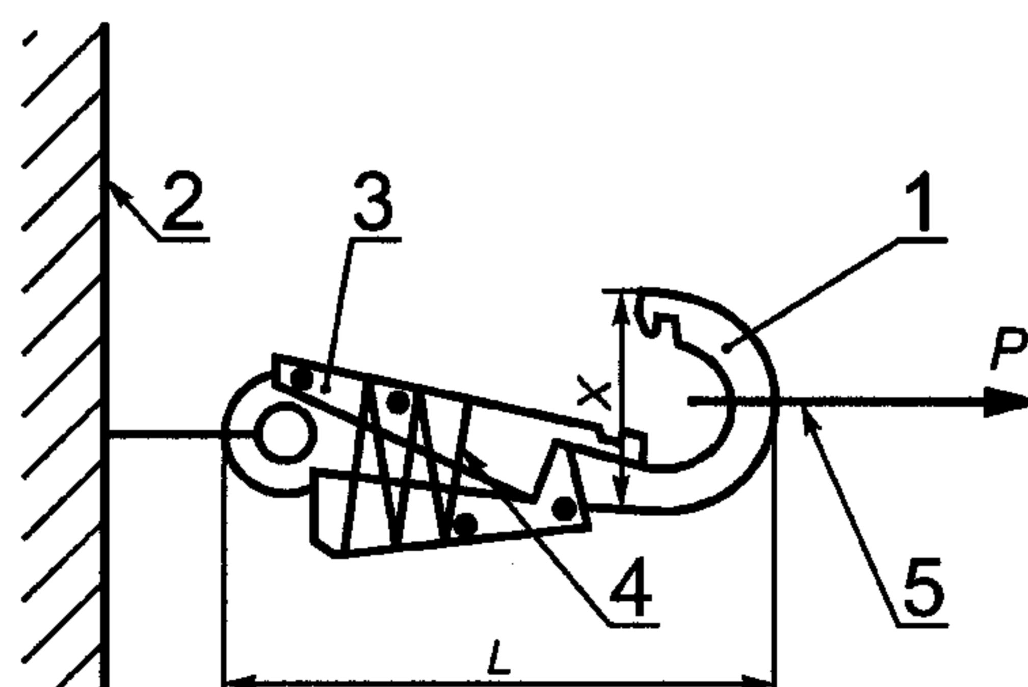
Рисунок 8а — Схема испытания карабина статической нагрузкой
