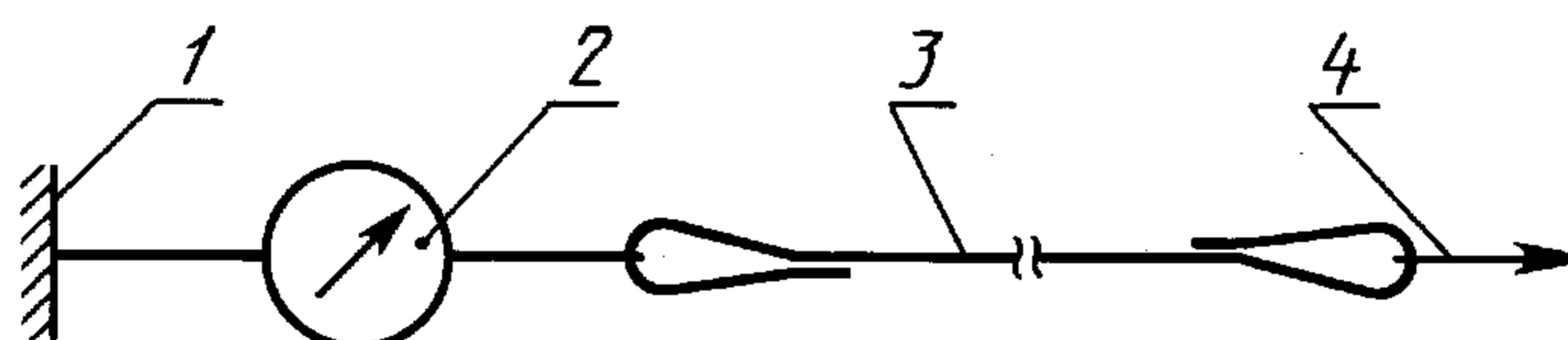
Рисунок 8 — Схема испытания элементов пояса статической нагрузкой
