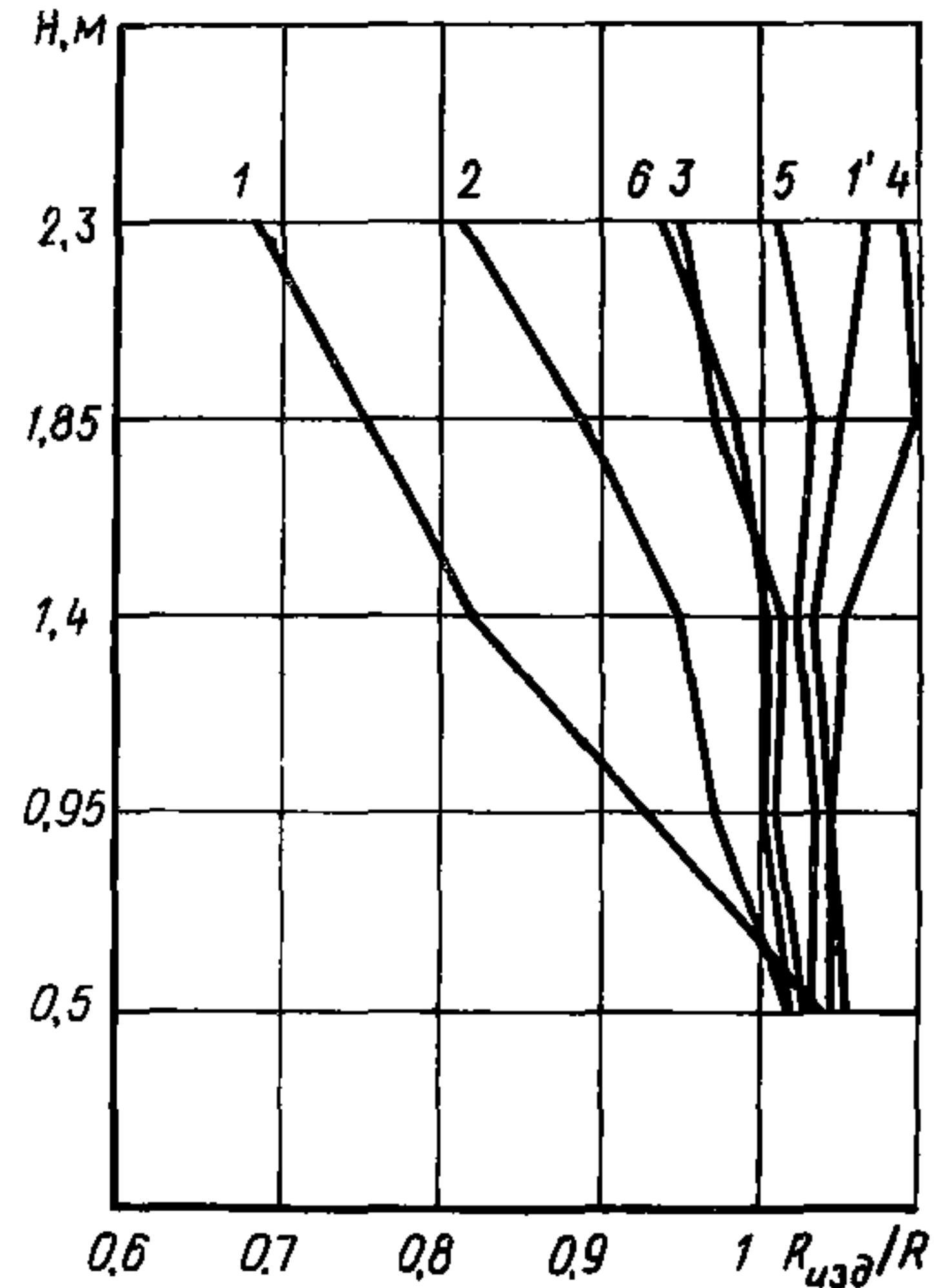
зительно на уровне  $1/2$  высоты фрагмента. Причем, в этом месте  $R_{изд}$  в наибольшей степени соответствует  $R$ . Дальнейшее изменение прочности по высоте фрагмента зависит от состава керамзитобетона, его прочности и исходной подвижности смеси. Наилучшую однородность прочности показали фрагменты, изготовленные из керамзитобетона класса по прочности на осевое сжатие В20 ( $OK=6$  см).
