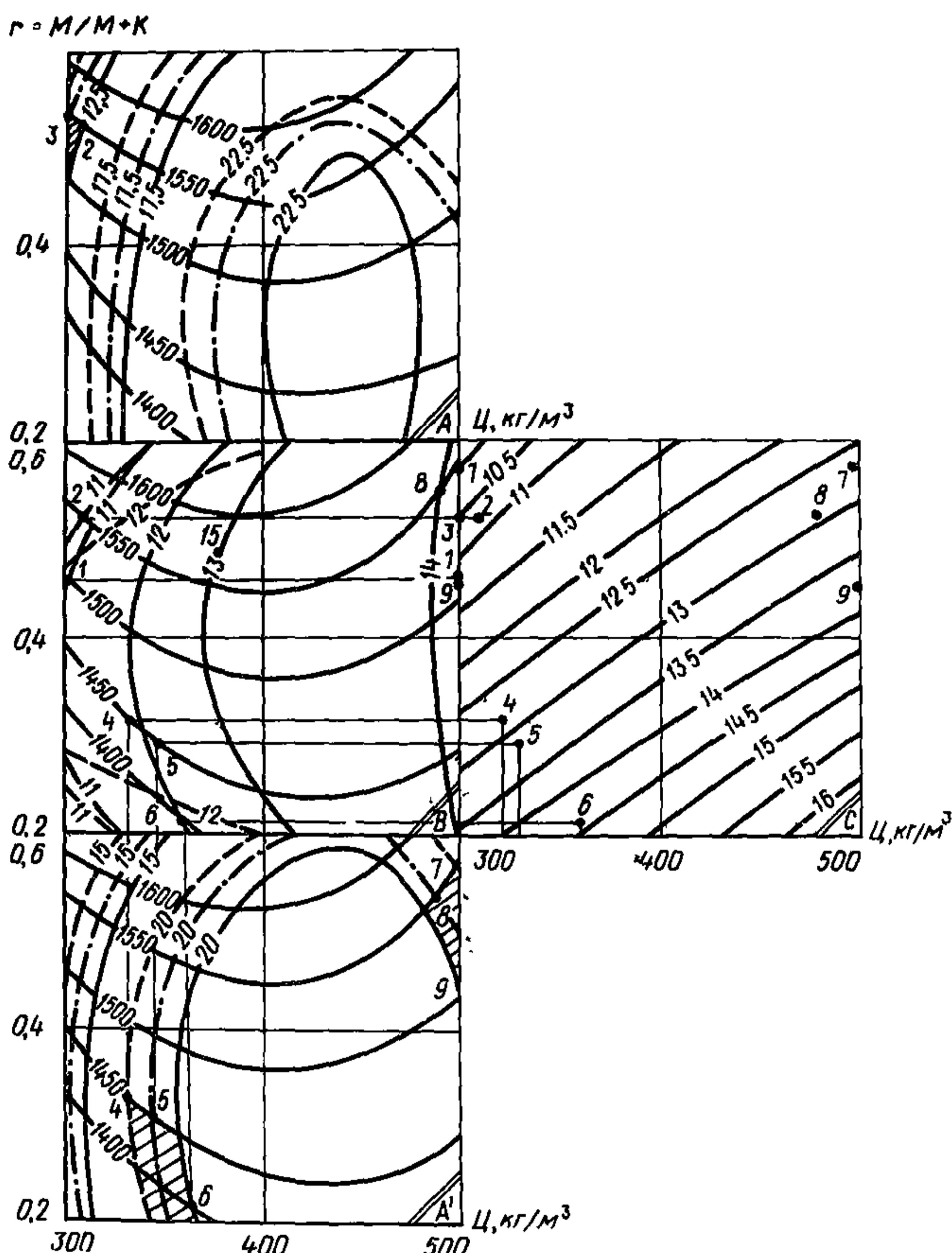
Комплексная номограмма для подбора составов конструкционного керамзитобетона на карбонатном песке, изготовленного из смеси исходной подвижностью ОК = 14 см: А, А' – номограммы " $R$ , МПа –  $\rho$ , кг/м<sup>3</sup>";
