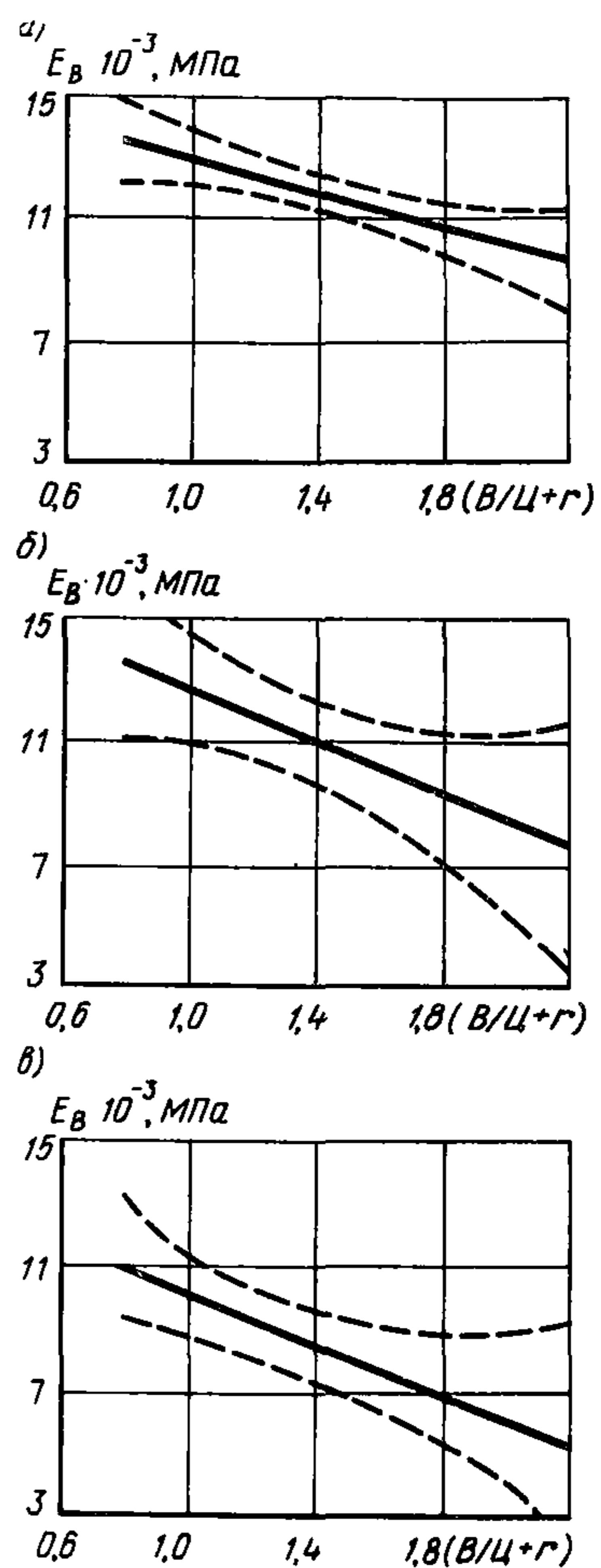
Рис. 2. Зависимость модуля упругости  $E_B$  (28) керамзитобетона на карбонатном песке от обобщенного фактора состава  $\Phi = (B/C + r)$  при исходной подвижности смеси  $\text{OK} = 6 \text{ см}$  (а),  $\text{OK} = 12 \text{ см}$  (б),  $\text{OK} = 18 \text{ см}$  (в); —— границы 95% доварительных интервалов
