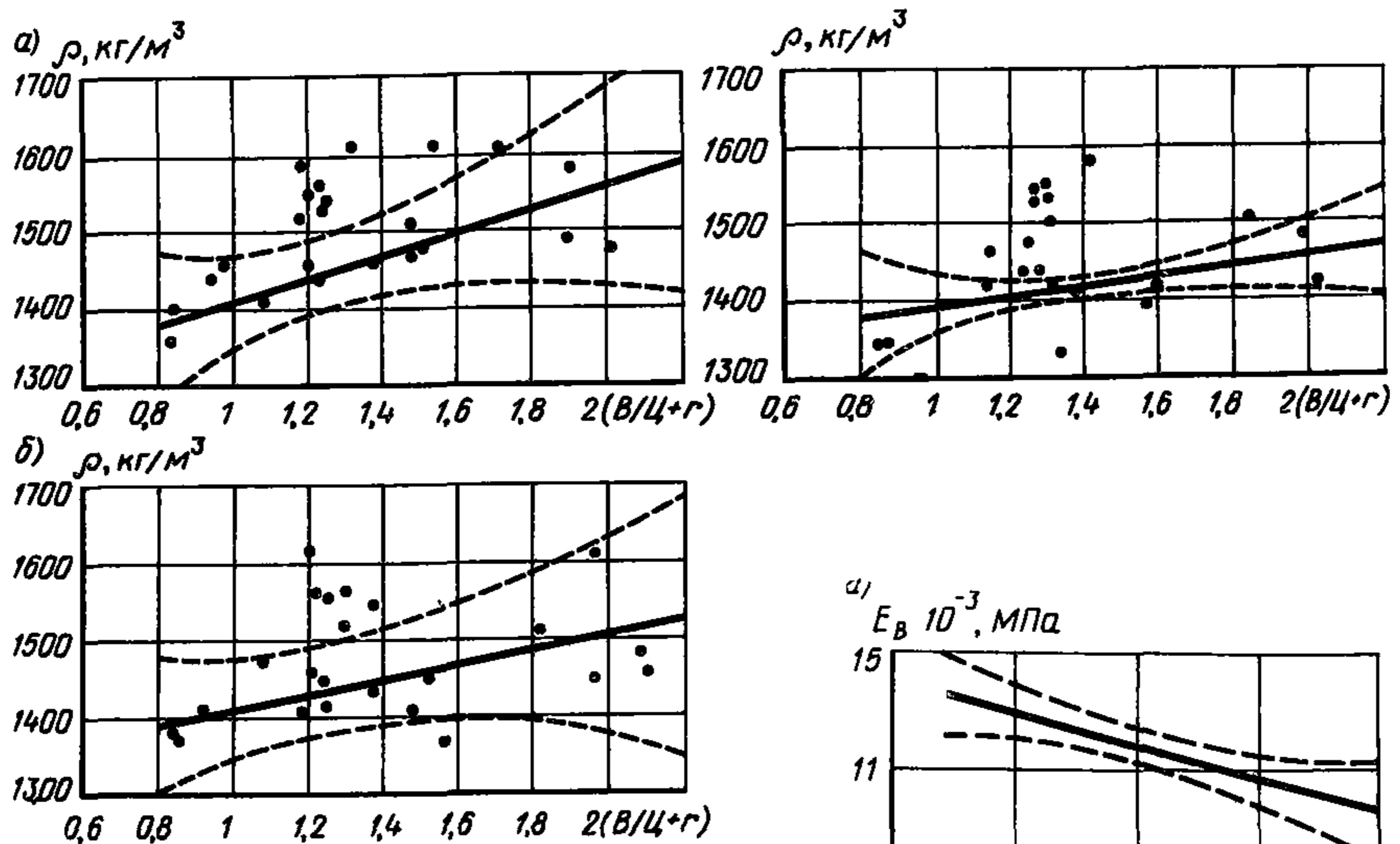
Рис. 3. Зависимость плотности в сухом состоянии  $\rho$  керамзитобетона на карбонатном песке от обобщенного фактора состава  $\Phi = (B/C + r)$  при исходной подвижности смеси  $\text{OK} = 6 \text{ см}$  (а),  $\text{OK} = 12 \text{ см}$  (б),  $\text{OK} = 18 \text{ см}$  (в); —— границы 95% доверительных интервалов
