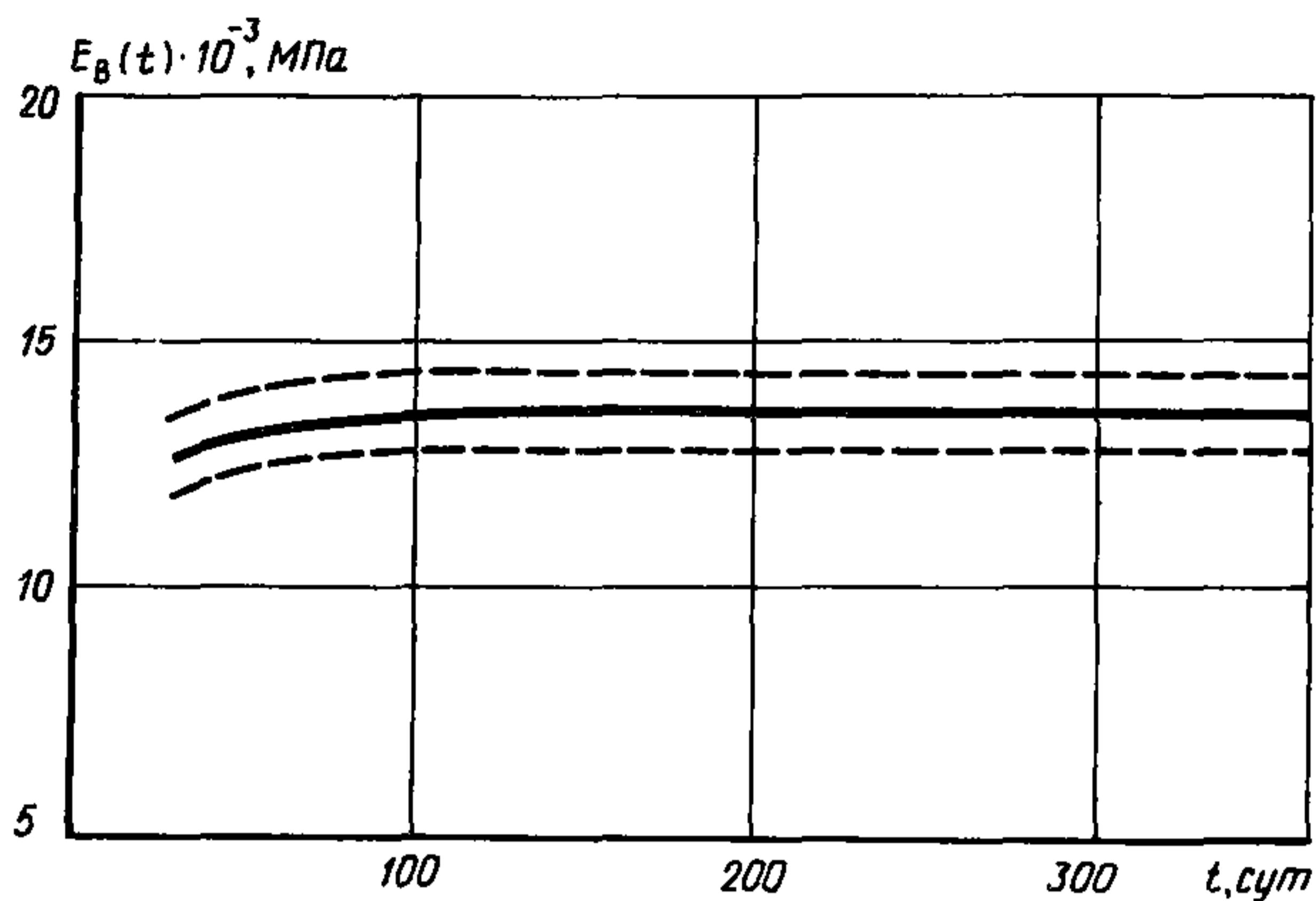
Рис. 4. Изменение во времени модуля упругости  $E_B(t)$  керамзитобетона на карбонатном песке, изготовленного из смеси исходной подвижностью  $OK = 6$  см
