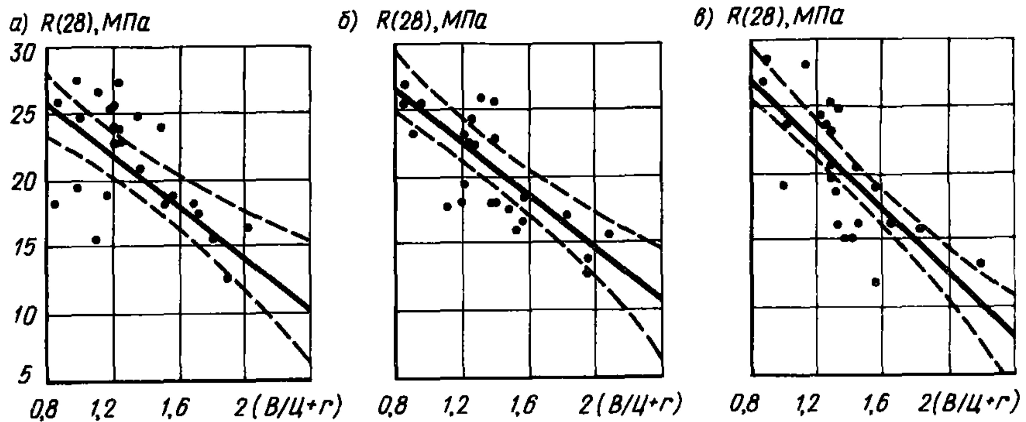
Рис. 1. Зависимость кубиковой прочности  $R(28)$  керамзитобетона на карбонатном песке от обобщенного фактора состава  $\Phi = (B/C + r)$  при исходной подвижности смеси  $OK = 6$  см (а),  $OK = 12$  см (б),  $OK = 18$  см (в); —— — границы 95% доверительных интервалов
