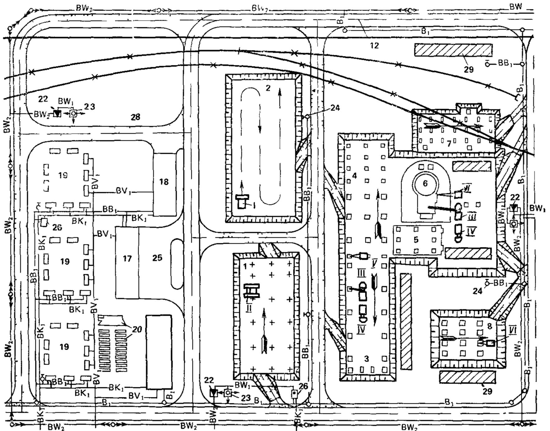
Рис. 2. Схема стройгенплана подготовительного периода
