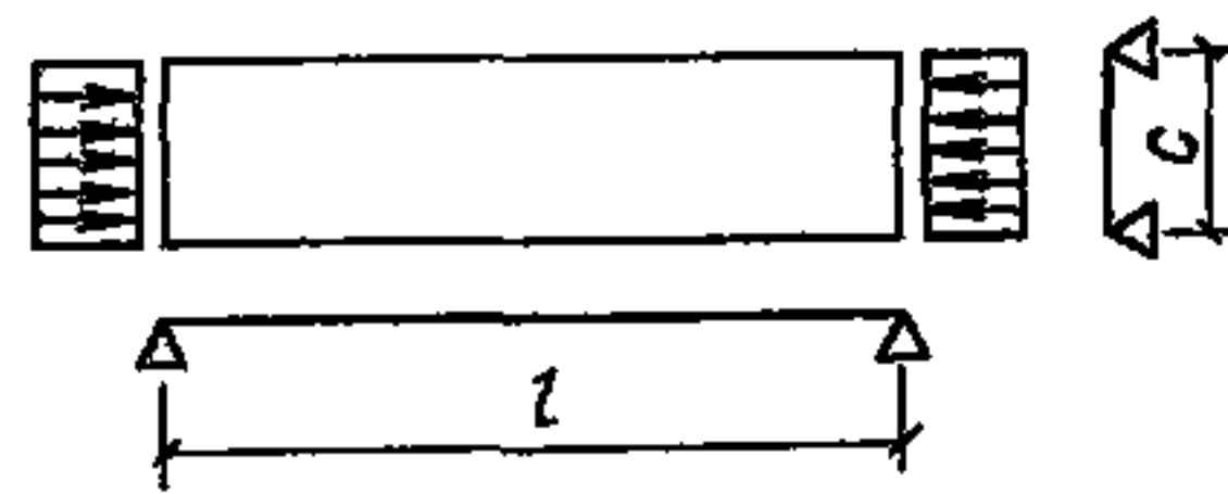
Рис. 14. Схема листа обшивки покрытия и напряжения в нем
