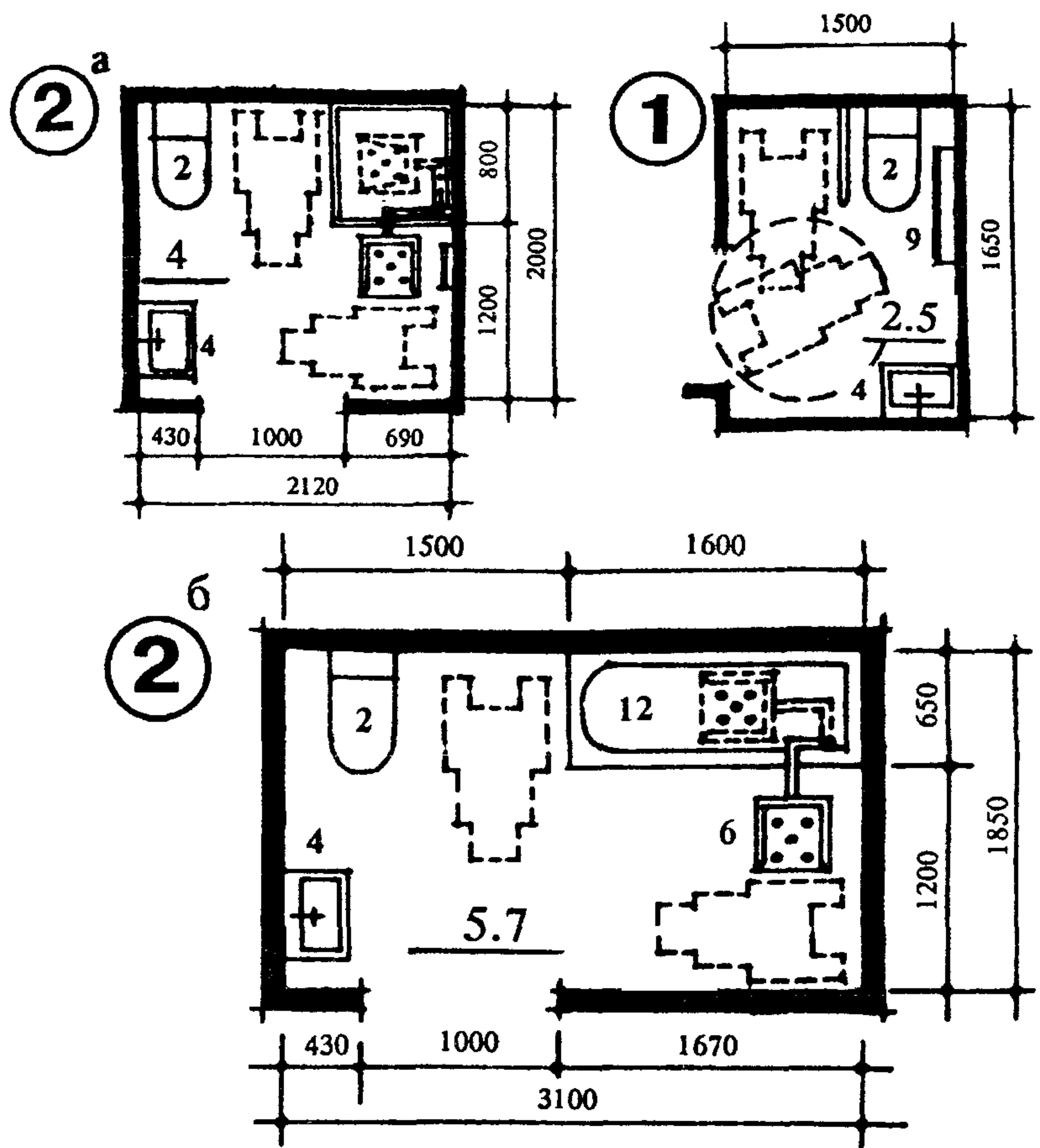
Рис. 6. Планировочные схемы санитарных узлов. Вариант 1 — уборная с умывальником. Вариант 2 — санитарный узел при спальной комнате. (а — вариант с душем, б — вариант с ванной). Экспликация оборудования: 1 — унитаз детский 30x50, 2 — унитаз для взрослых 40x60, 3 — умывальник детский 50x30, 4 — умывальник для взрослых 60x40, 5 — душевой поддон 80x80, 6 — поворотное кресло, 7 — ногомойка 40x60, 8 — банкетка 40x40, 9 — вешалка для полотенец, 10 — поручни-держатели, 11 — шкаф хозяйственный
