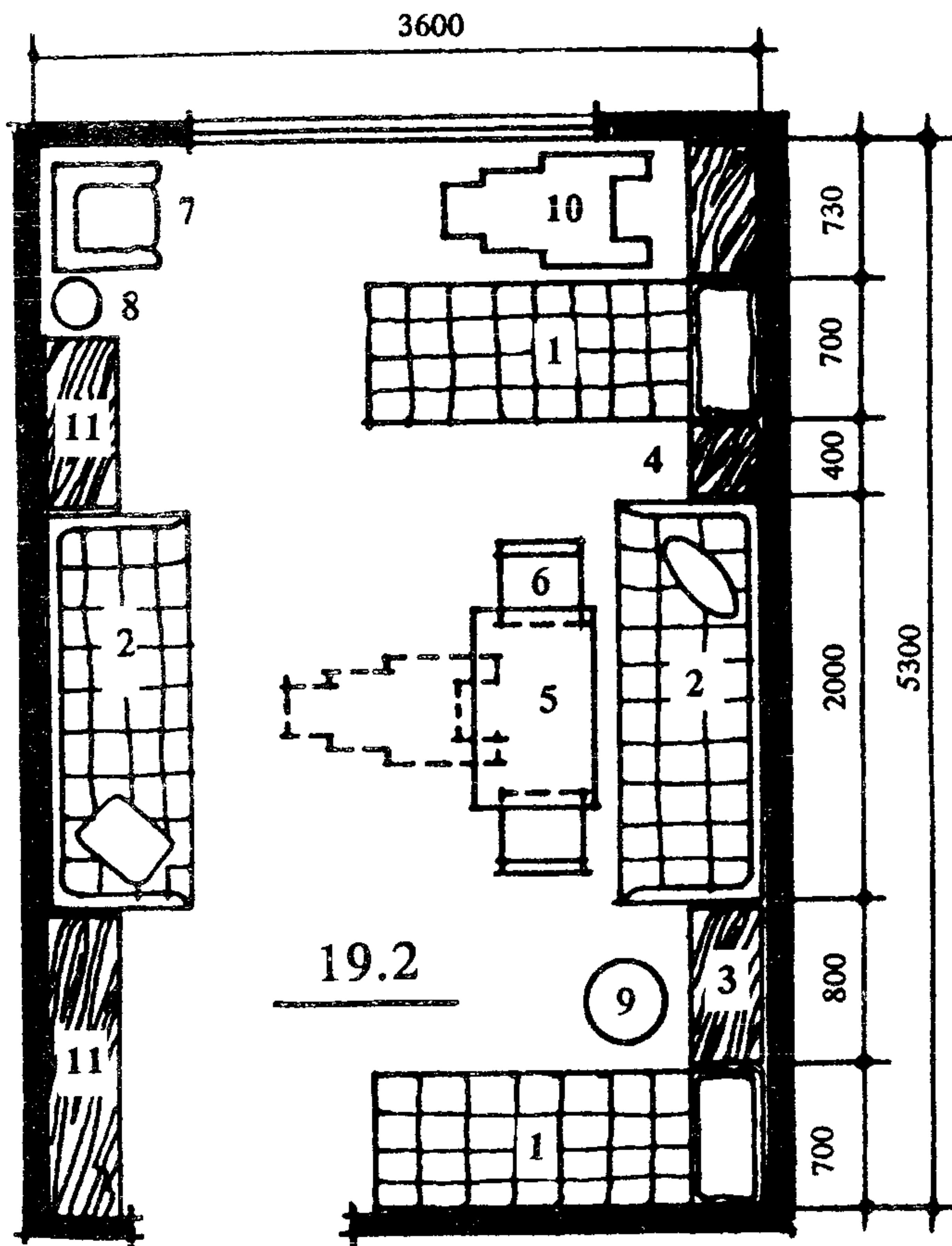
Рис. 5. Планировочная схема спальной комнаты на 4 места. Экспликацию оборудования см. рис. 1
