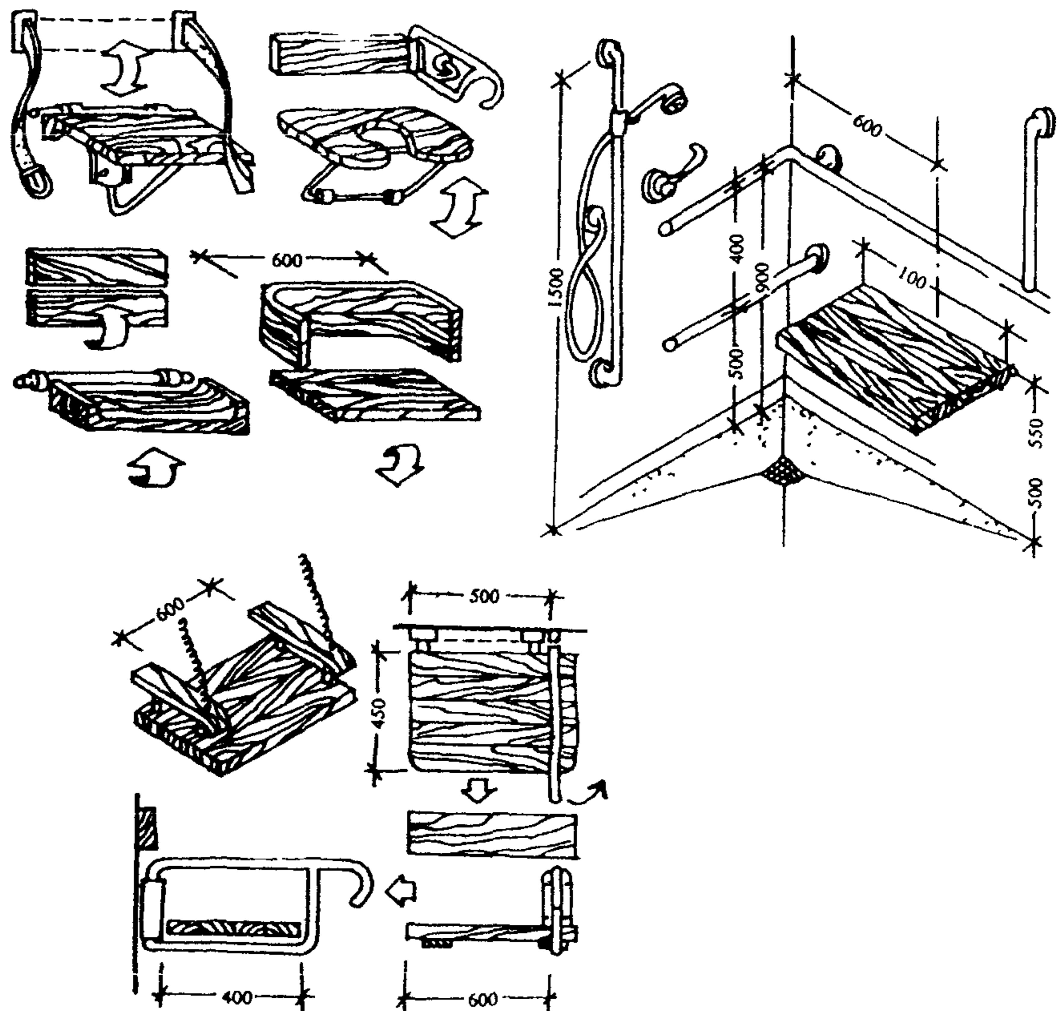
Рис. 14. Типы стационарных сидений в душевых. Зарубежный опыт
