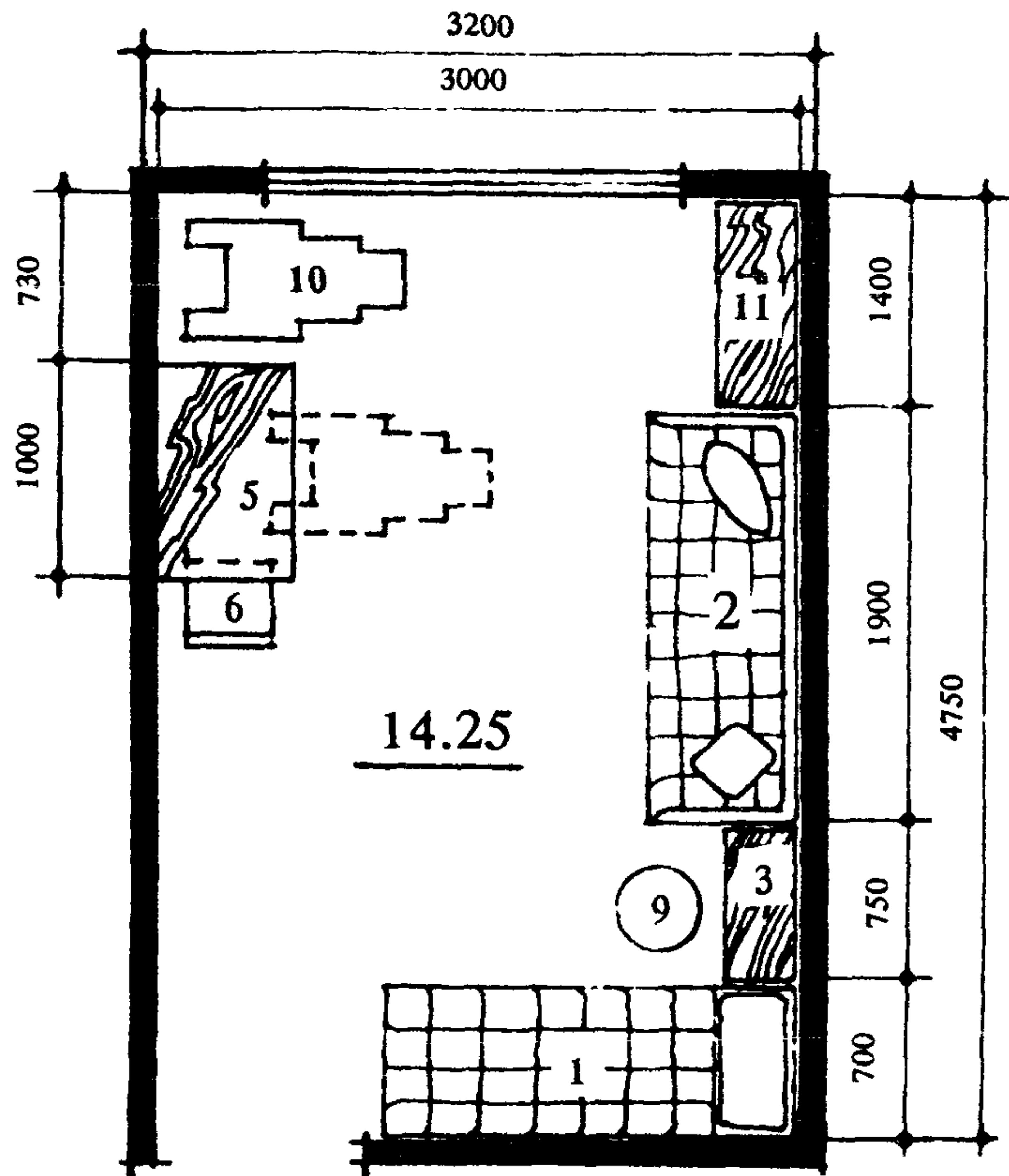
Рис. 2. Планировочная схема спальной комнаты на 2 места (вариант при шаге 3,2 м). Экспликацию оборудования см. рис. 1
