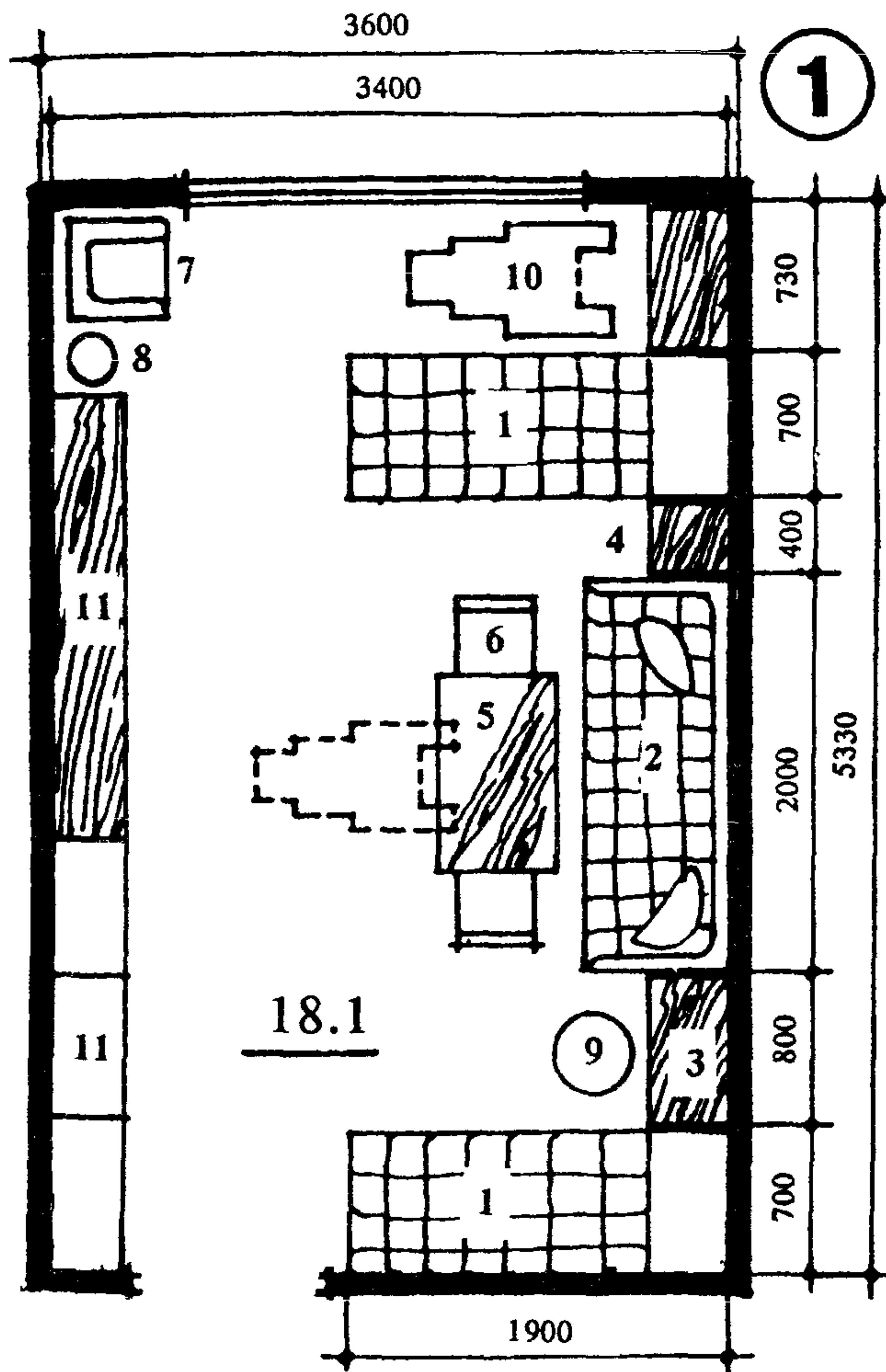
Рис. 3. Планировочная схема спальной комнаты на 3 места (вариант 1).
