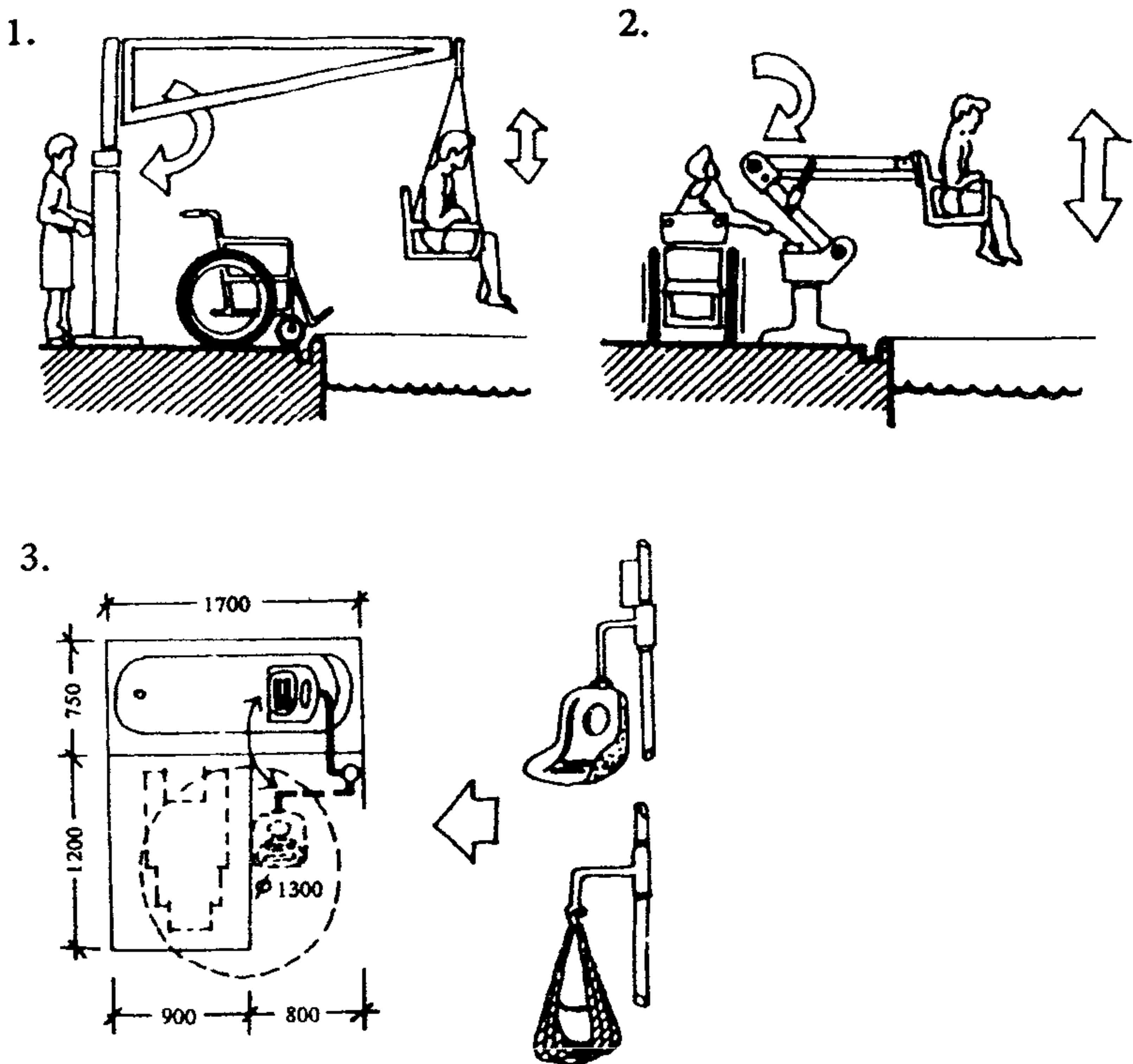
Рис. 13. Примеры оборудования санитарно-гигиенических помещений. Зарубежный опыт (Х.Ю.Калмет)
