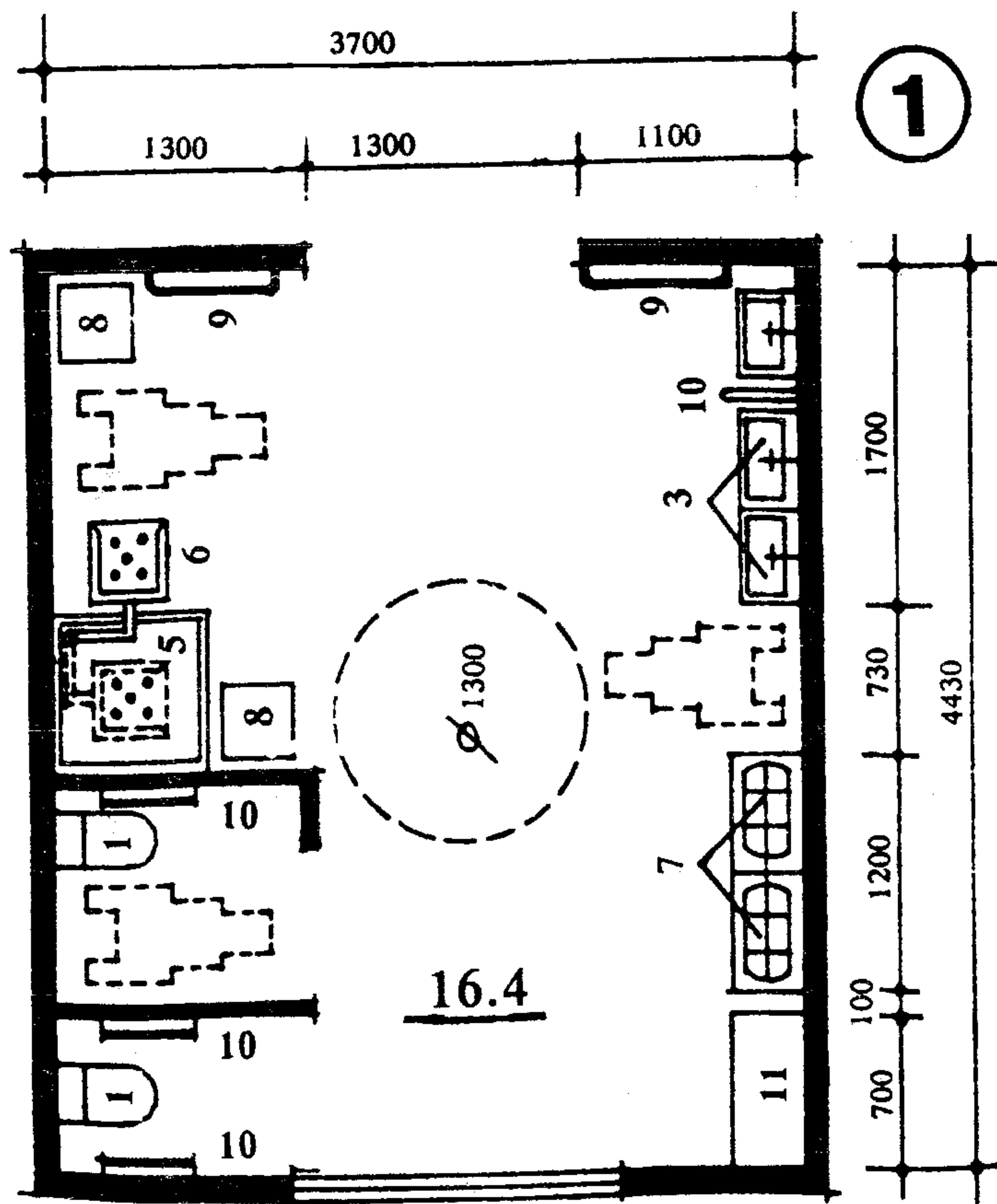
Рис. 7. Планировочная схема санитарного узла для дошкольных групп (Вариант 1). Эспликация оборудования: 1 — унитаз детский 30x50, 2 — унитаз для взрослых 40x60, 3 — умывальник детский 50x30, 4 — умывальник для взрослых 60x40, 5 — душевой поддон 80x80, 6 — поворотное кресло, 7 — ногомойка 40x60, 8 — банкетка 40x40, 9 — вешалка для полотенец, 10 — поручни-держатели, 11 — шкаф хозяйственный
