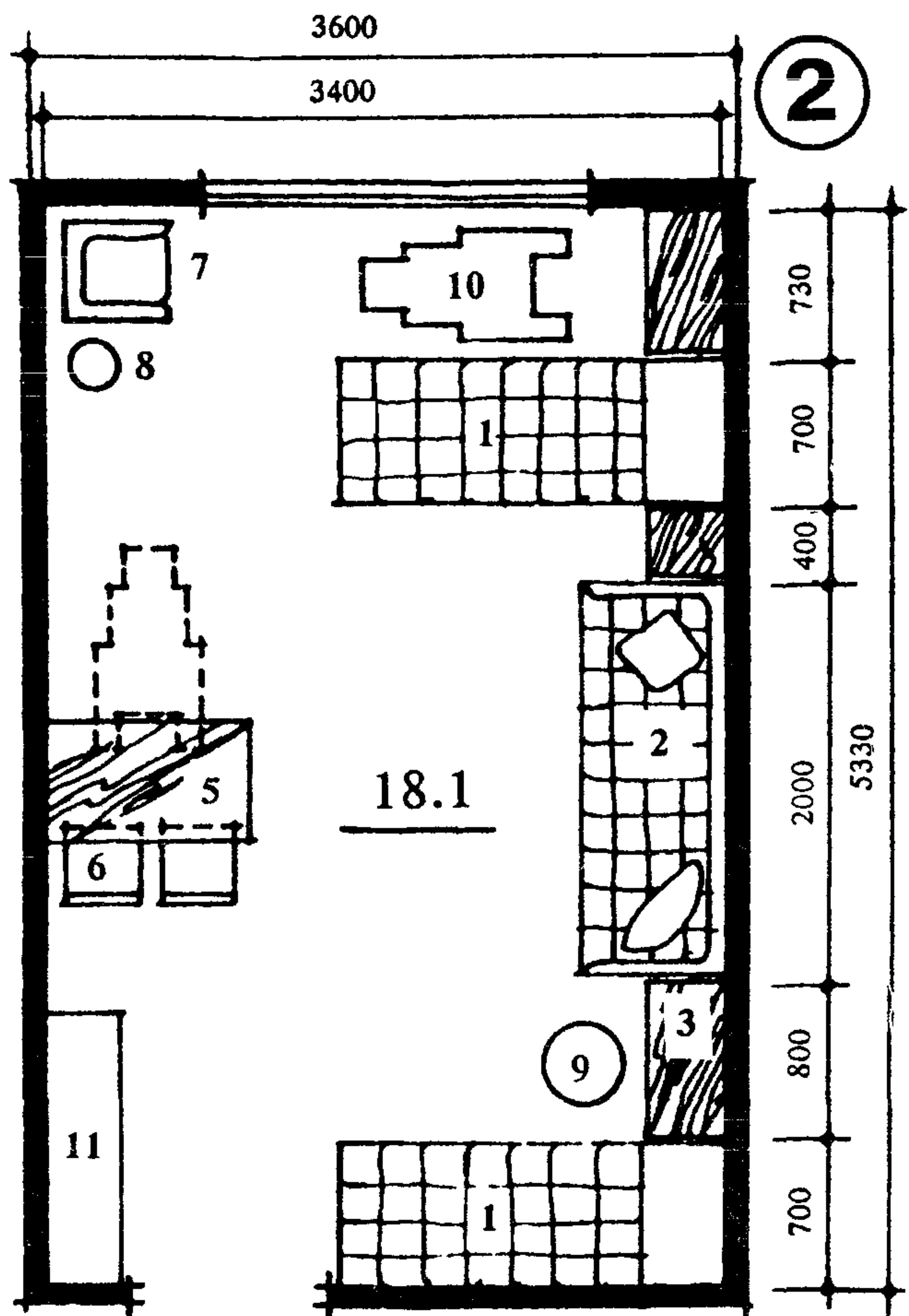
Рис. 4. Планировочная схема спальной комнаты на 3 места (вариант 2).
