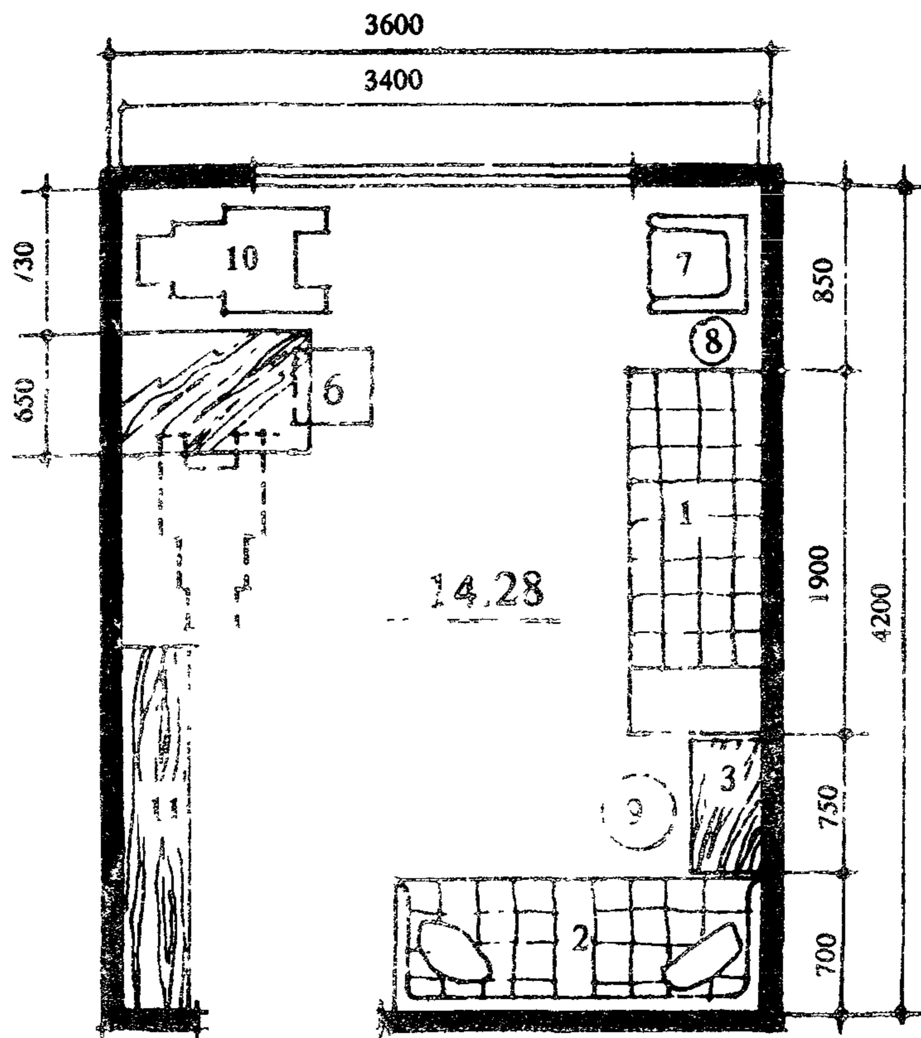
Рис. 1. Планировочная схема спальной комнаты на 2 места (Вариант при шаге 3,6 м). Экспликация обрудования: 1 — кровать 190x70, 2 — диван 200x75, 3 — тумбочка 40x80, 4 — тумбочка 40x40, 5 — стол 60x100, 6 — стул 40x40, 7 — кресло 50x50, 8 — торшер, 9 — банкетка, 10 — инвалидная коляска, 11 — комбинированный шкаф
