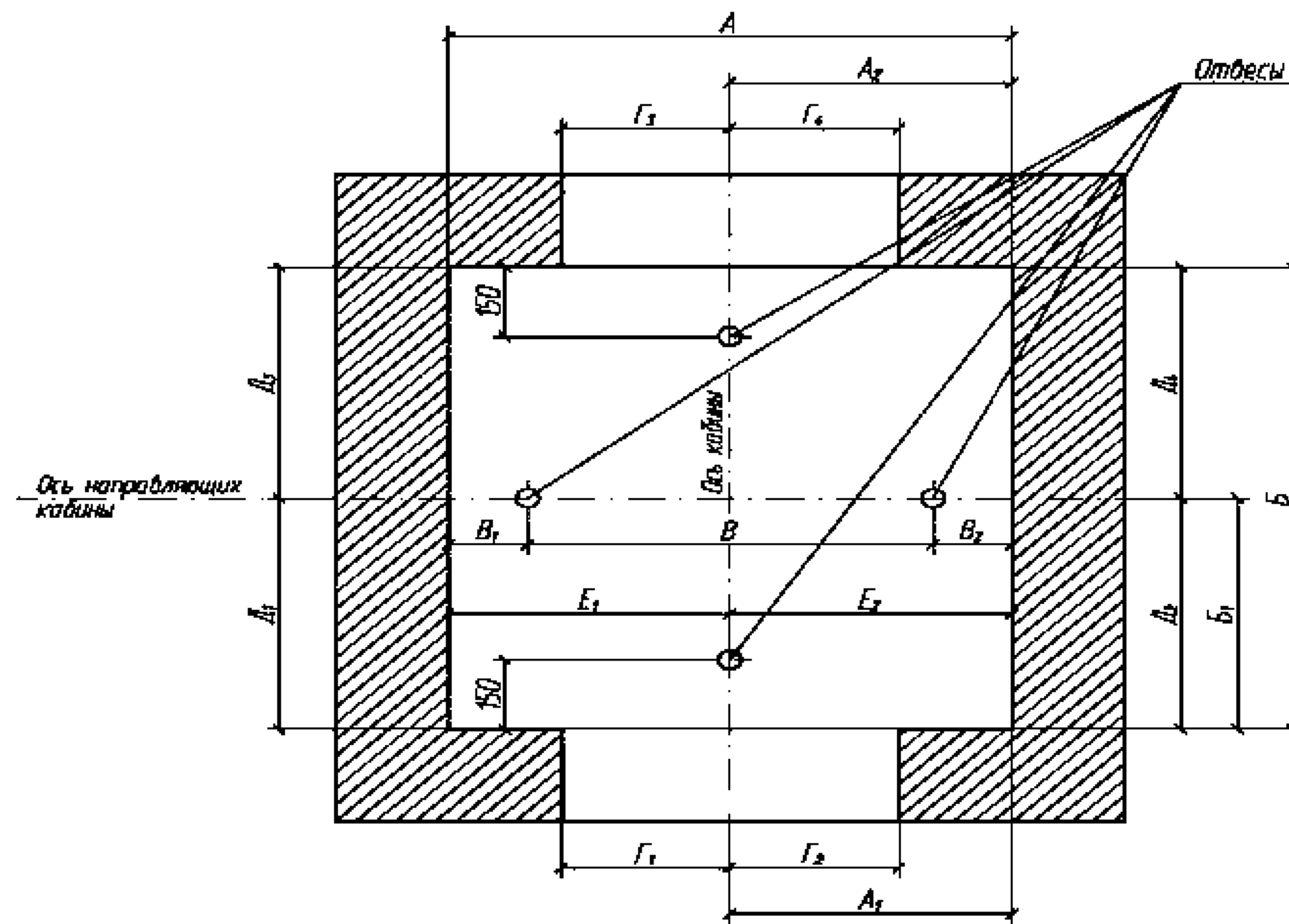
$A$ ,  $A_1$ ,  $B$ ,  $B_1$ ,  $B$  – размеры, определяемые монтажным (установочным) чертежом.
