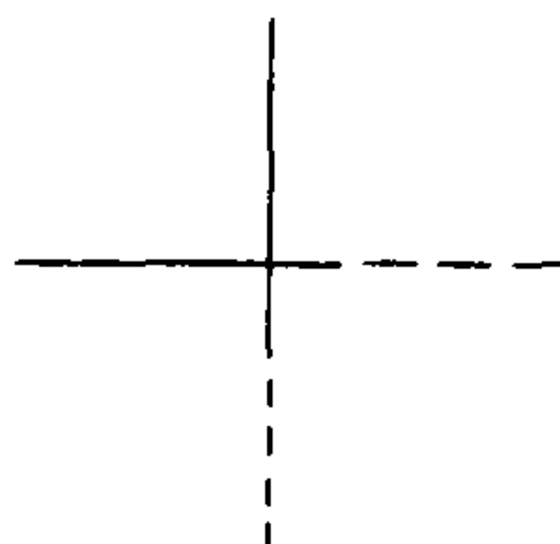
Рис. 5. Метка-крест для контроля совмещения изображений на фотоформах и оттисках
