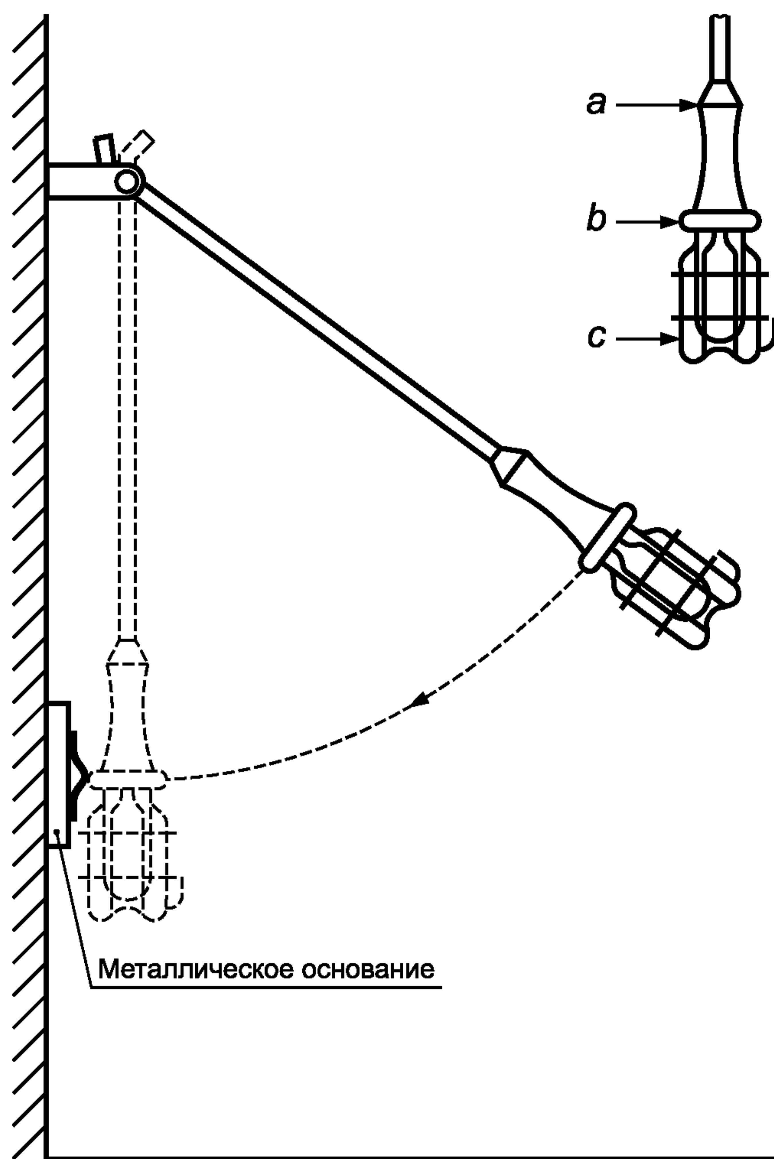
Рисунок 1 — Устройство для испытания светильников на удар
