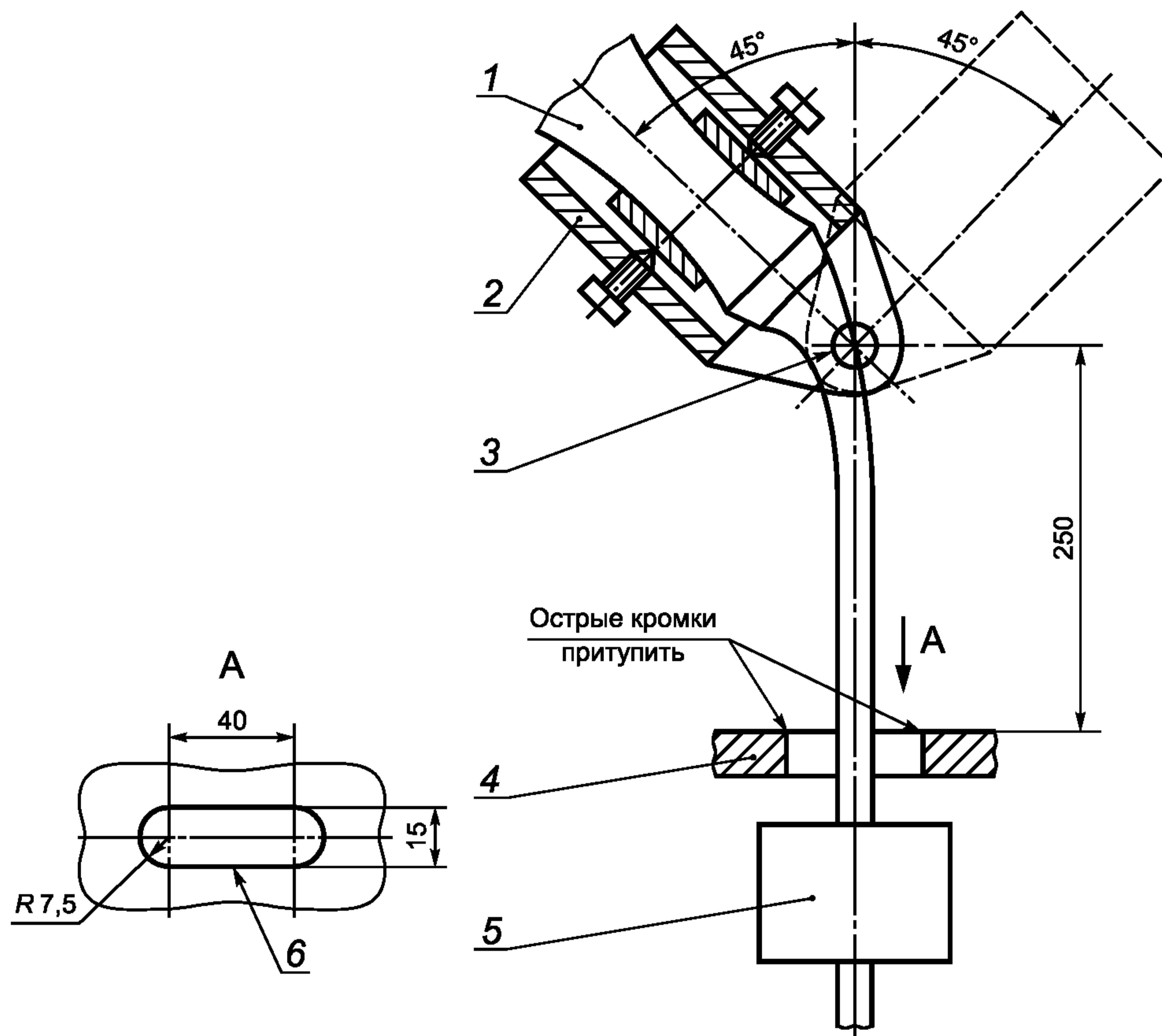
1 — образец; 2 — устройство для крепления образца; 3 — ось качания; 4 — ограничитель; 5 — груз;
