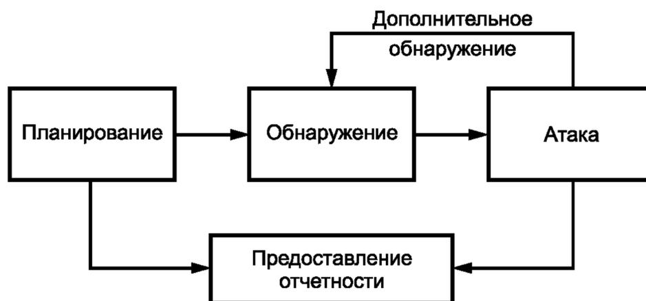
Рисунок 1 — Методика испытаний четырехэтапного проникновения в сеть
