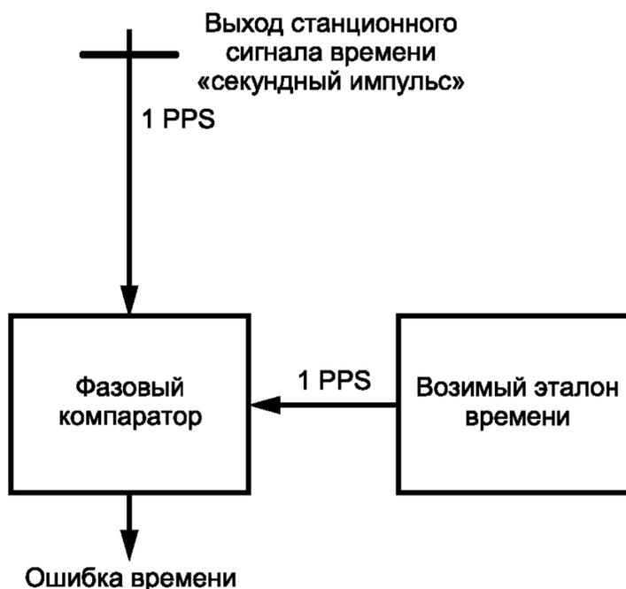
Рисунок 4 — Контроль качества временной синхронизации
