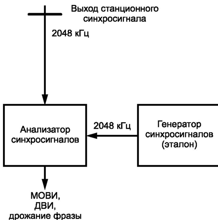
Рисунок 3 — Контроль качества частотной синхронизации
